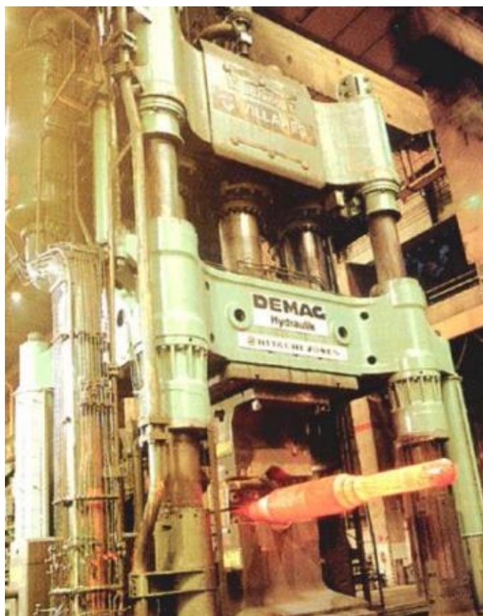
Figura 9 – Prensa DEMAG 8000 toneladas forjando LTF
