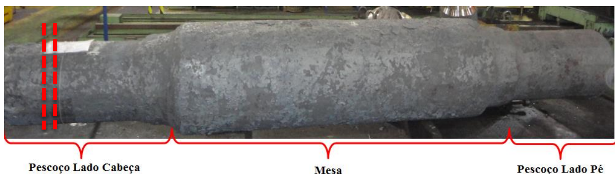
Figura 19 – Esquemático do local de retirada de amostra por usinagem
