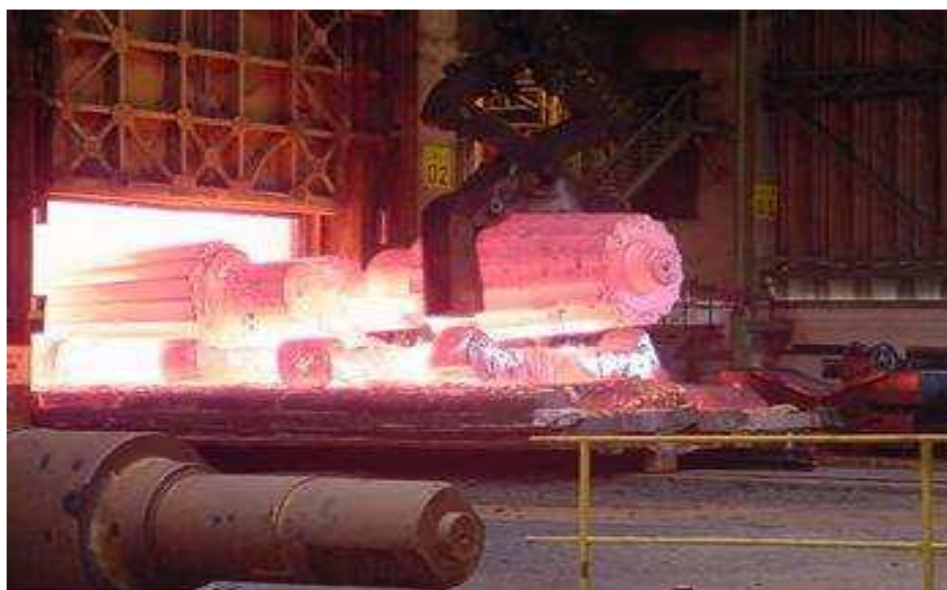
Figura 8 – Lingotes após tratamento térmico de soaking
