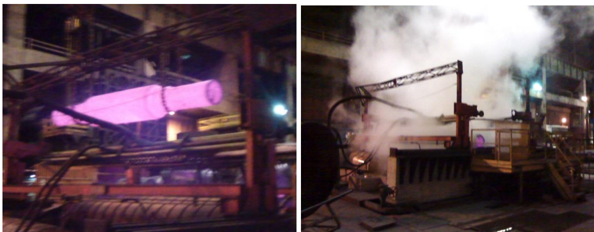
Figura 11 – Blank sendo posicionado na máquina de TPF e durante o resfriamento
