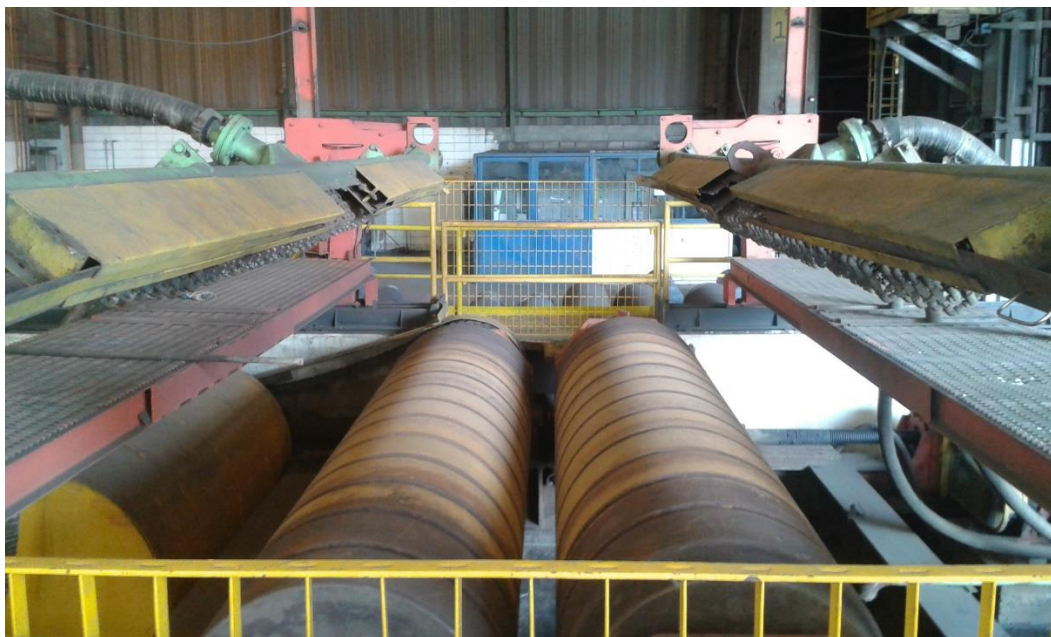
Figura 12 – Máquina de têmpera pós forjamento (TPF)
