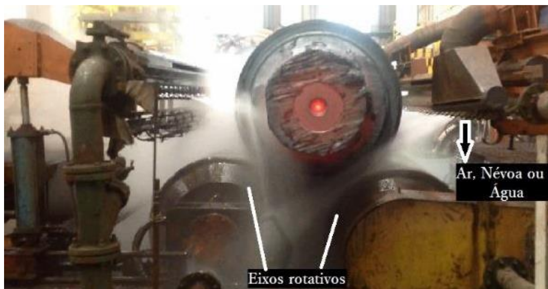
Figura 13 – Blank durante o TPF na vista frontal
