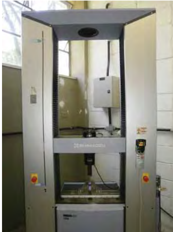
Figura 25A. Máquina Universal de Ensaio, SHIMADZU, modelo Autograph AG-X 50kN do Departamento de Materiais e Tecnologia da FEG/UNESP.
