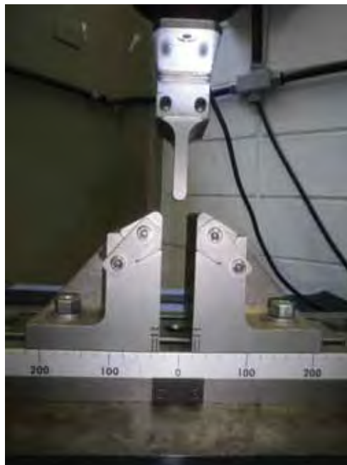
Figura 25B. Dispositivo da máquina universal de ensaios montado para o ensaio de dobramento de três pontos ao ar.
