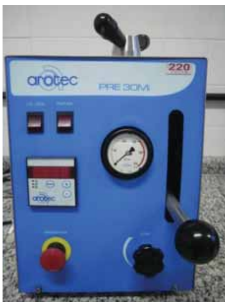
Figura 22. Embutidora Arotec, PRE 30Mi do Laboratório do Departamento de Materiais e Tecnologia da FEG/UNESP.
