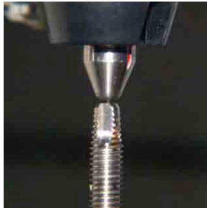
FIGURA 7 – Ensaio de dureza na base do implante.
