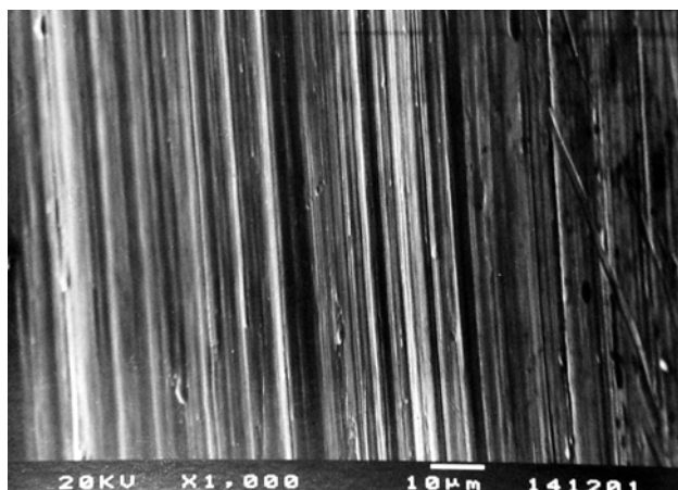
FIGURA 13 – MEV do implante 3i superfície lisa – grupo controle.
