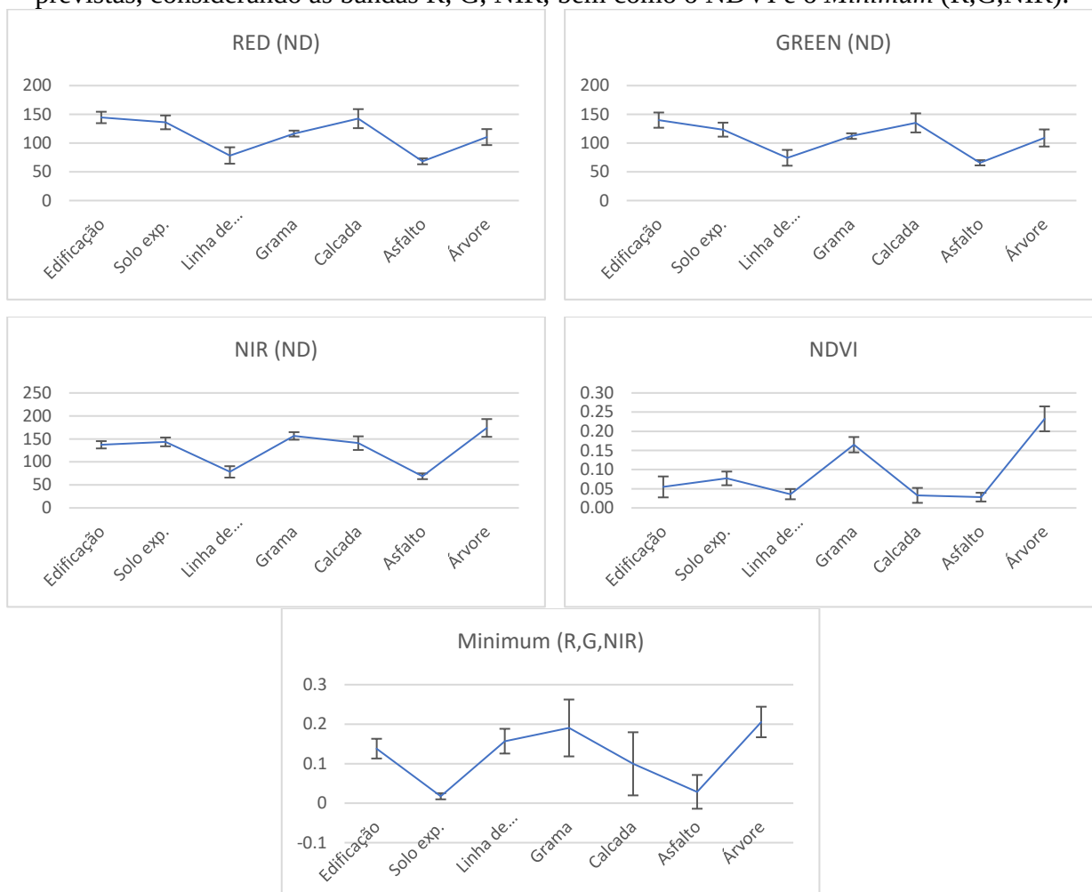
Figura 6.8 - Gráficos de média e desvio-padrão dos atributos radiométricos para as classes previstas, considerando as bandas R, G, NIR, bem como o NDVI e o Minimum (R,G,NIR).
