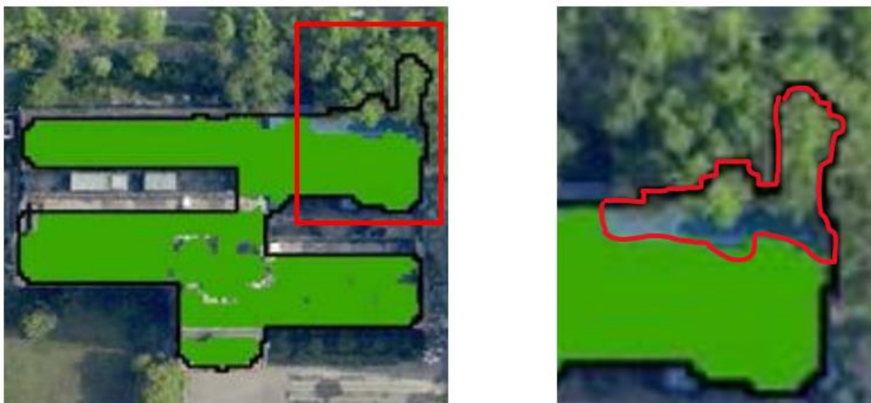
Figura 1.1 - Contorno de telhado parcialmente ocluído por vegetação.
