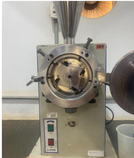
Figura 31- Moinho aberto mostrando o sistema de faca e contra faca
