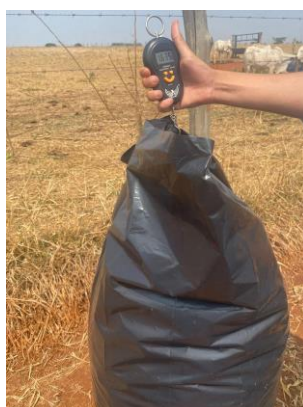
Figura 29 - Pesagem da massa total da amostra utilizando balança manual
