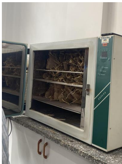
Figura 30 - Amostras em estufa a 65°C para análise de matéria seca total.
