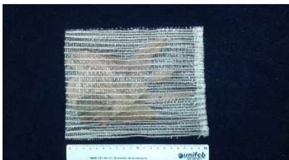
Figura 14: Litter bag utilizada nos experimentos de decomposição
