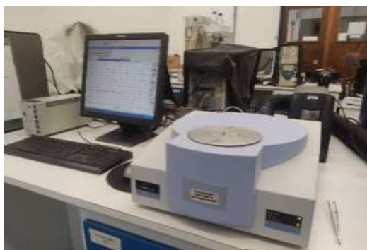
Figura 6 - TA Instrumento DSC Q20 no Laboratório de Imunobiológicos e Biofármacos da Faculdade de Ciências Farmacêuticas da USP.
