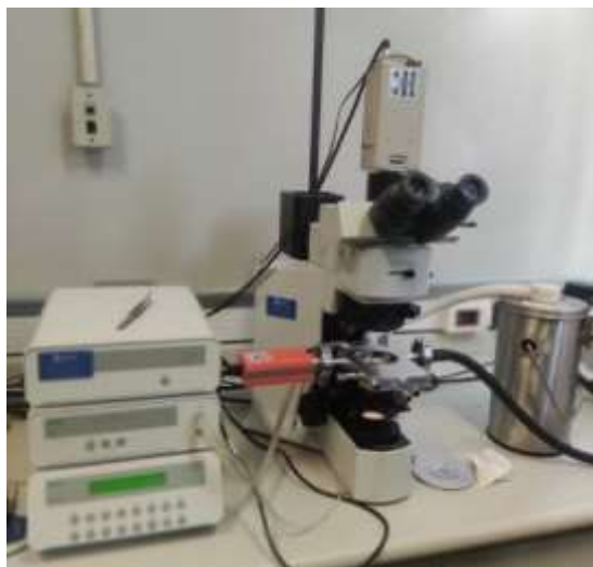
Figura 7 - FDM – Freezer Drying Microscopy do Laboratório de Imunobiológicos e Biofármacos da Faculdade de Ciências Farmacêuticas da USP.
