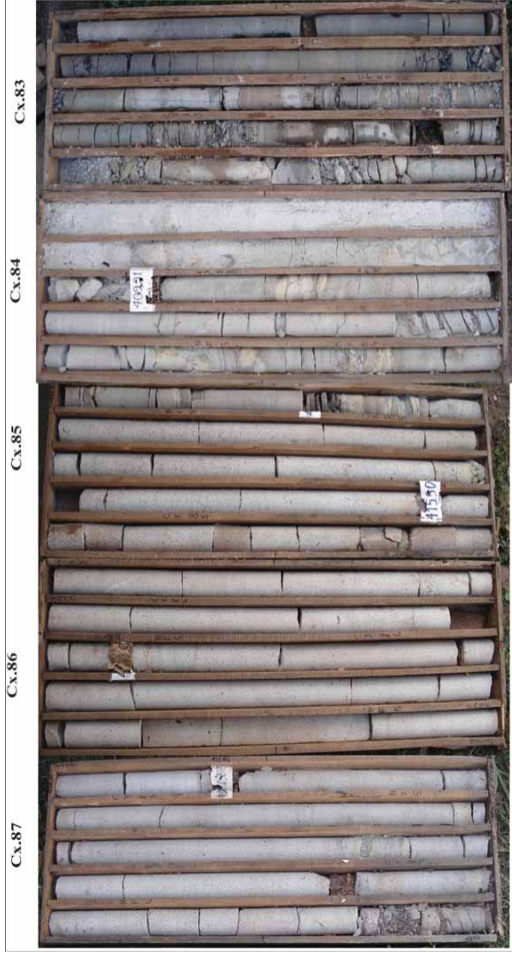
Figura 15. Apresenta testemunhos de sondagem a partir da cx. 87 à 83 de folhelho migrando para arenito
