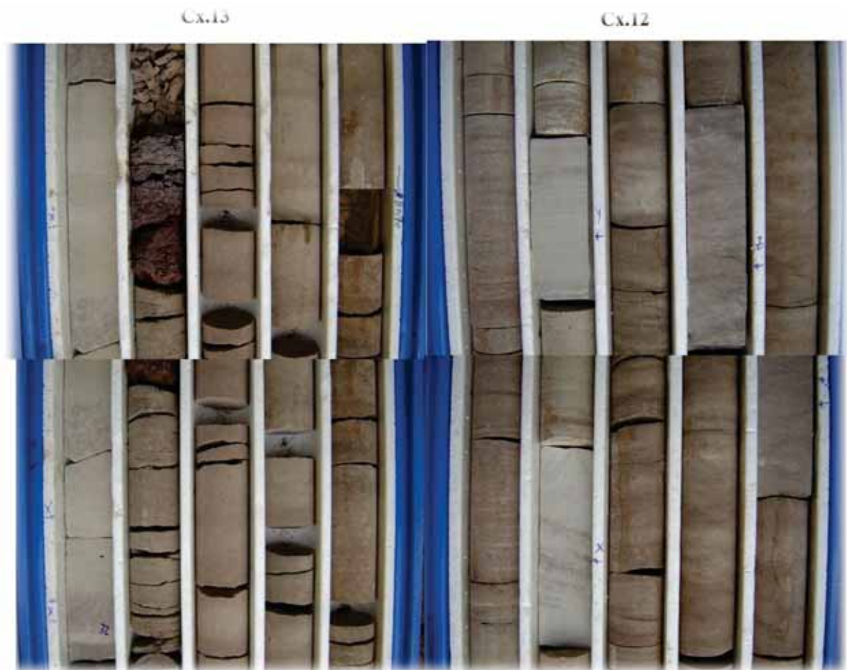
Figura 24. Arenito muito fino a fino com estratificação plano-paralela.
