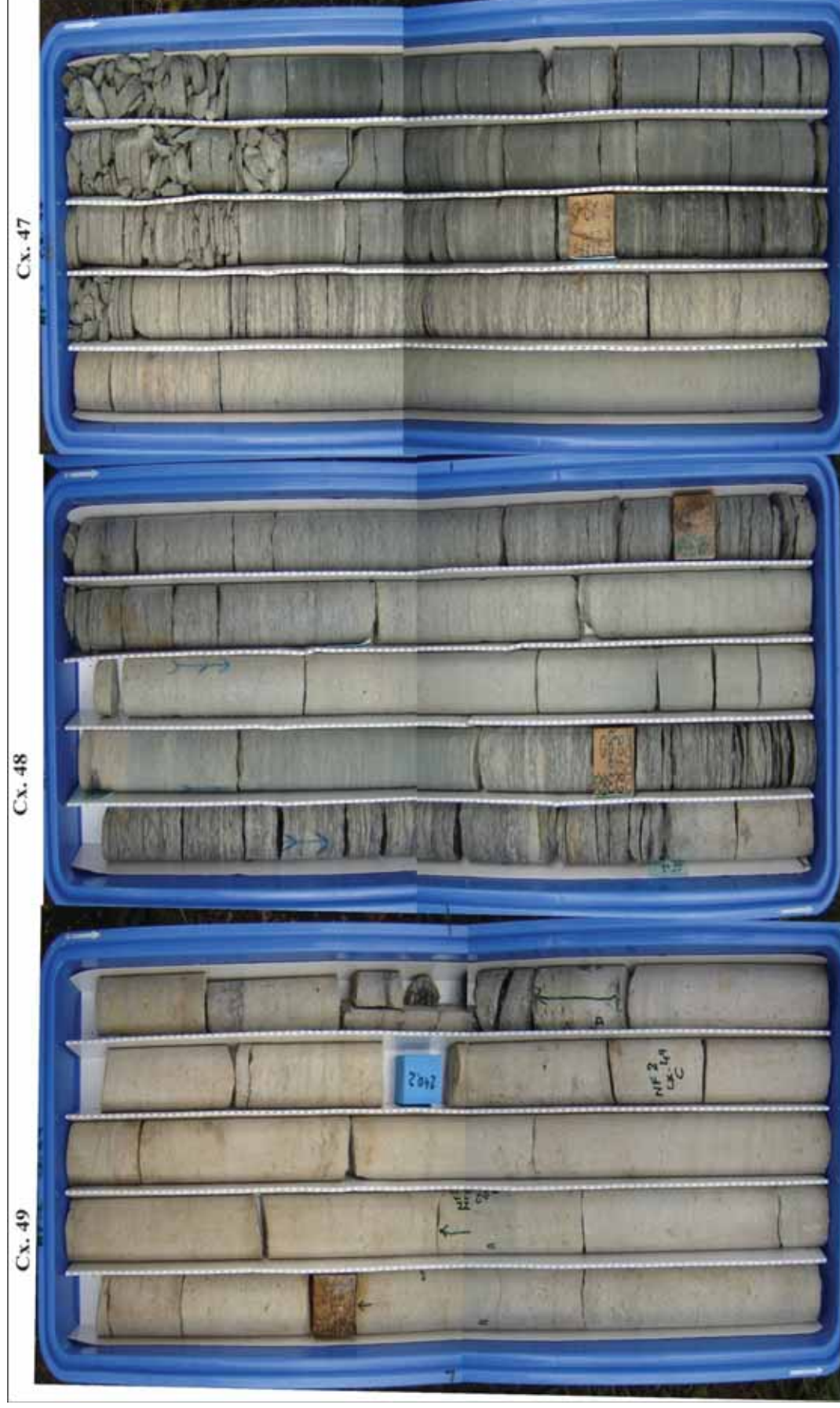
Figura 27. Folhelho migrando para siltito caracterizando um evento regressivo. Bastante bioturbado, poço NF-2.
