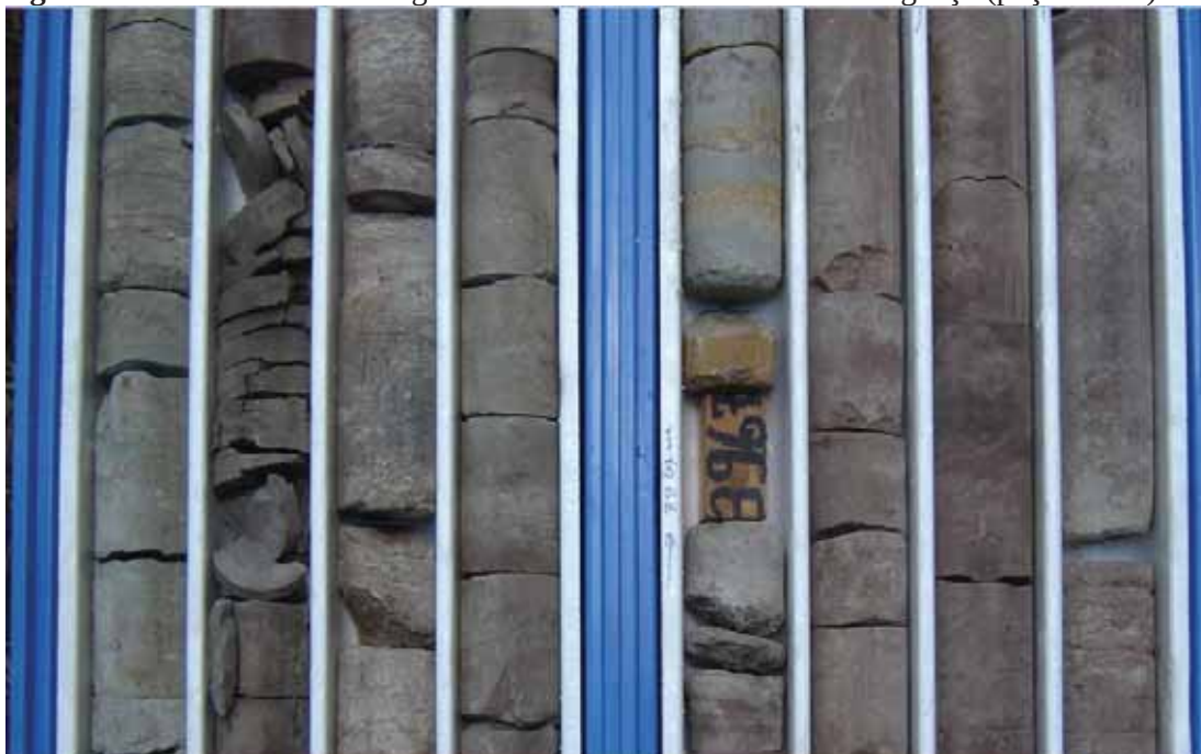
Figura 19: Fácies arenosas e argilosas acastanhadas do Membro Paraguaçu (poço PP-25).
