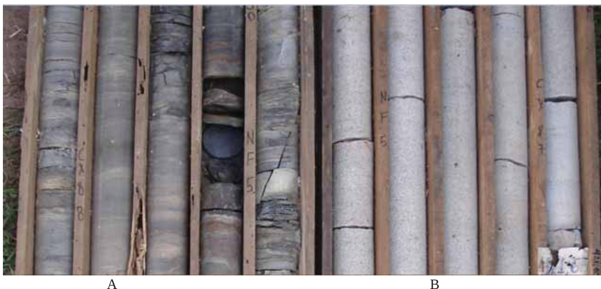
Figura 7. Fácies lamíticas (A) e arenosas (B) do Membro Triunfo, poço NF-5.
