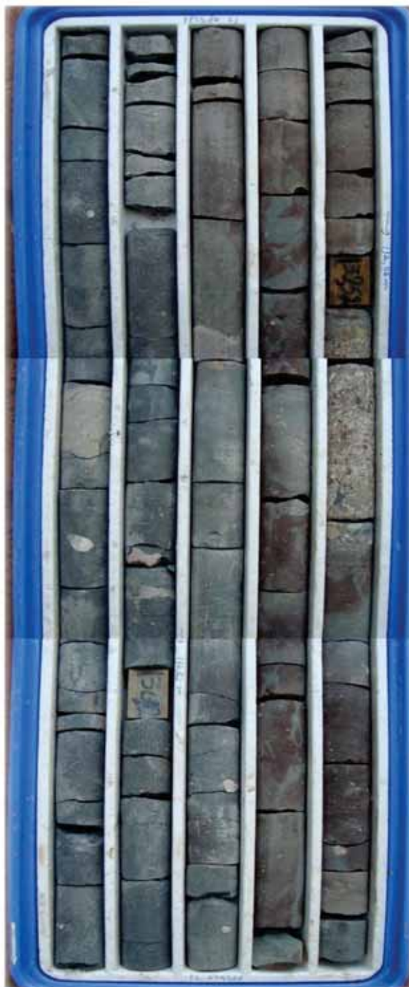
Figura 21. Diamictito do Gr. Itararé com intercalação de conglomerado.
