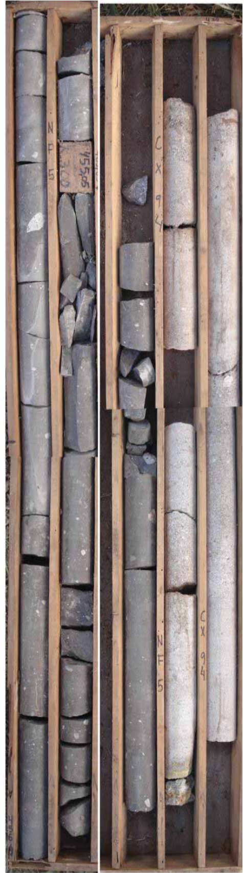
Figura 8. Diamictitos e arenito Chapéu de Sol (A cx. 96/95) sob arenito Triunfo (B, cx.94).
