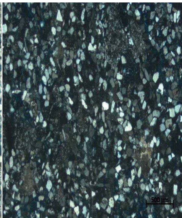
Figura.25: Arcóseo (Fotomicrografia de lâminas delgadas com nicóis paralelos (A,C ) e cruzados (B,D))
