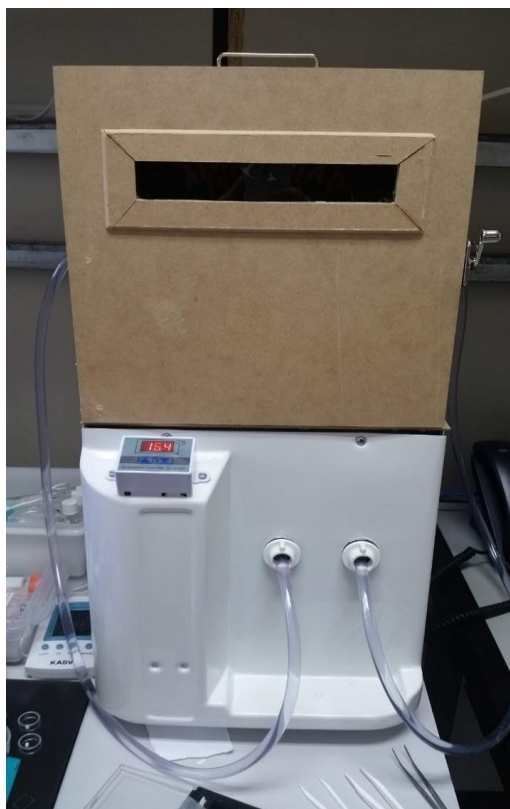
Figura 9 – Sistema de fotocatalise feito pelo autor do trabalho.
