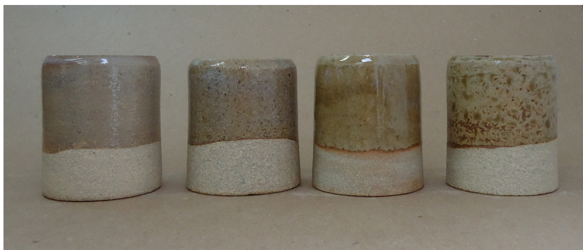
Figura 312. Triangulação 1 (P7, P8, P9, P10): argila branca, queima em forno a gás, cone 9 (1280°C).
