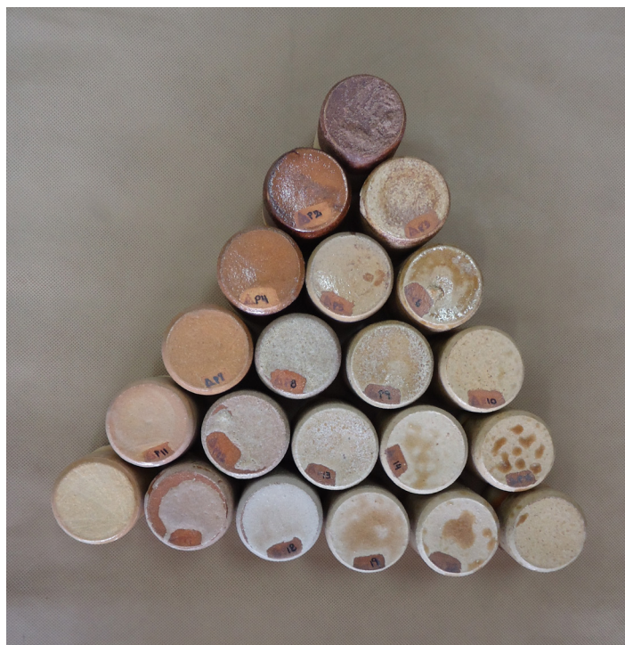
Figura 258. Triangulação1: argila branca, queima em forno elétrico cone 8 (1263°C).
