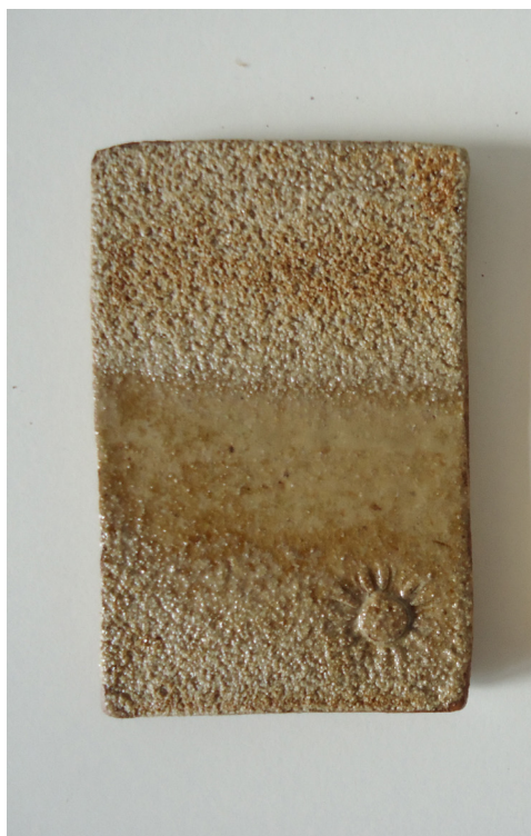
Figura 252. Argila branca: 50% euc. + 50% BC. Figura 253. Argila vermelha: 50% euc. + 50% BC.
