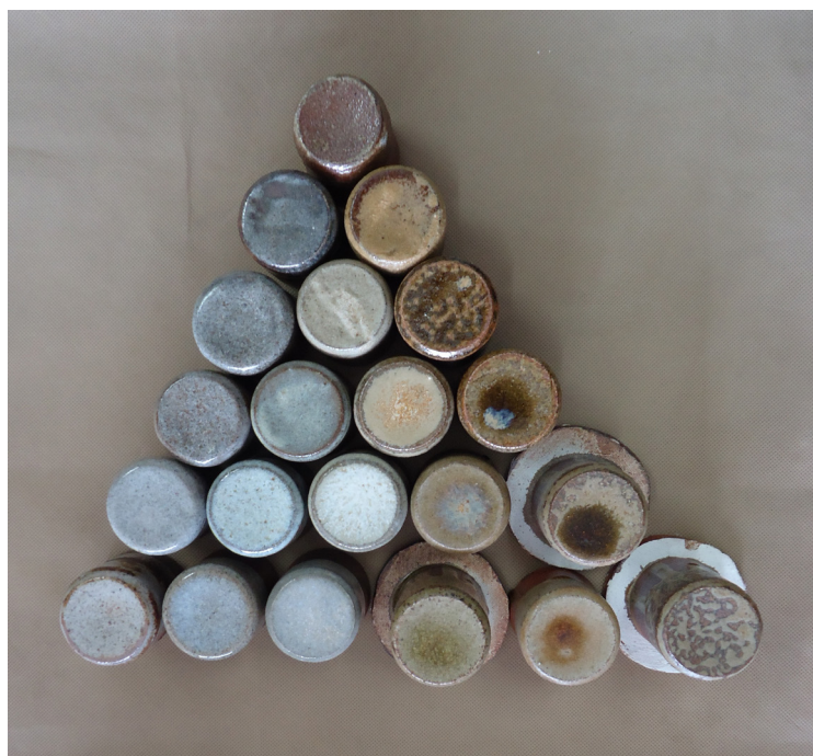
Figura 348. Triangulação 1: argila branca, queima em forno noborigama , cone 15 (1420°C).
