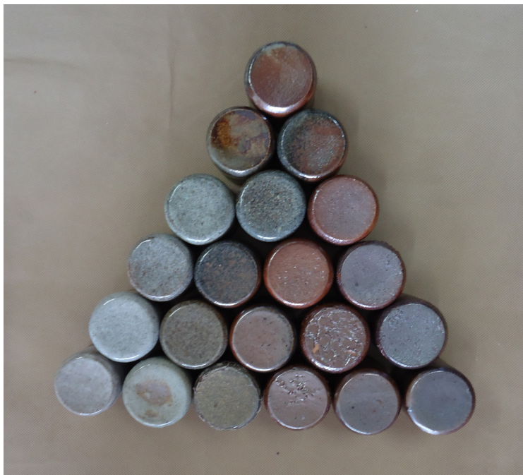
Figura 355. Triangulação 2: argila branca, queima em forno noborigama , cone 15 (1420°C)
