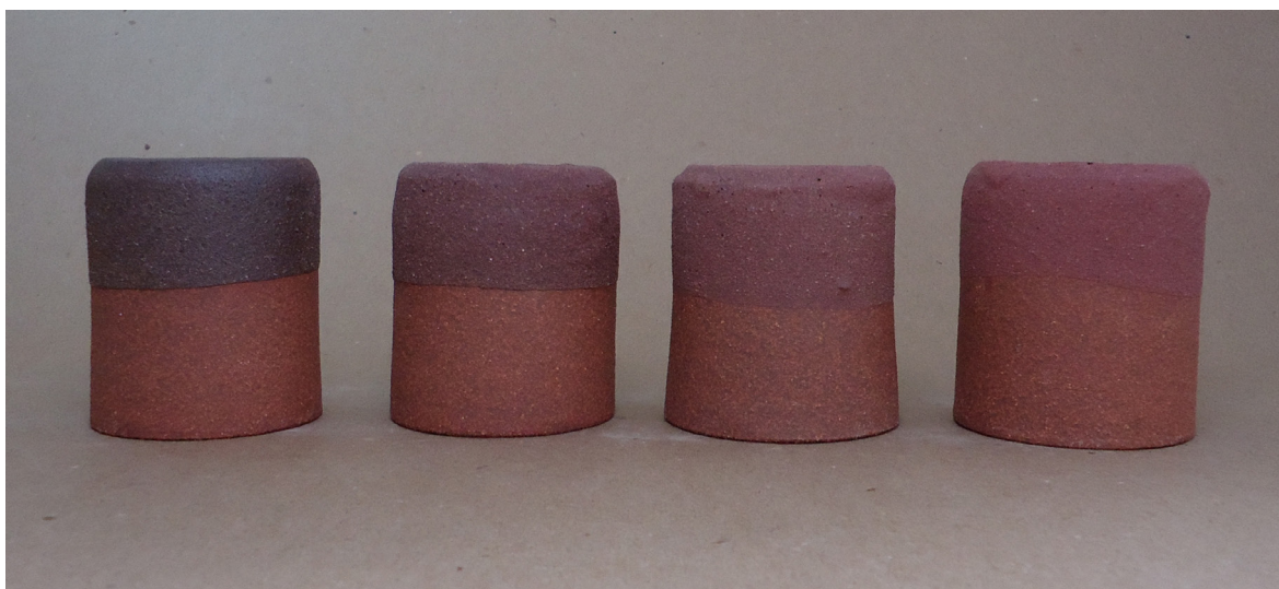
Figura 278. Triangulação 2 (P3, P6, P10, P15): argila vermelha, forno elétrico, cone 8 (1263°C).
