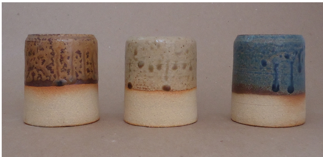
Figura 289. Pontos coloridos (base P10): argila branca, queima em forno elétrico, cone 8 (1263°C).
