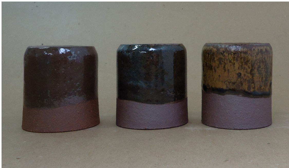
Figura 311. Triangulação 1 (P4, P5, P6): argila vermelha, queima em forno a gás, cone 9 (1280°C).
