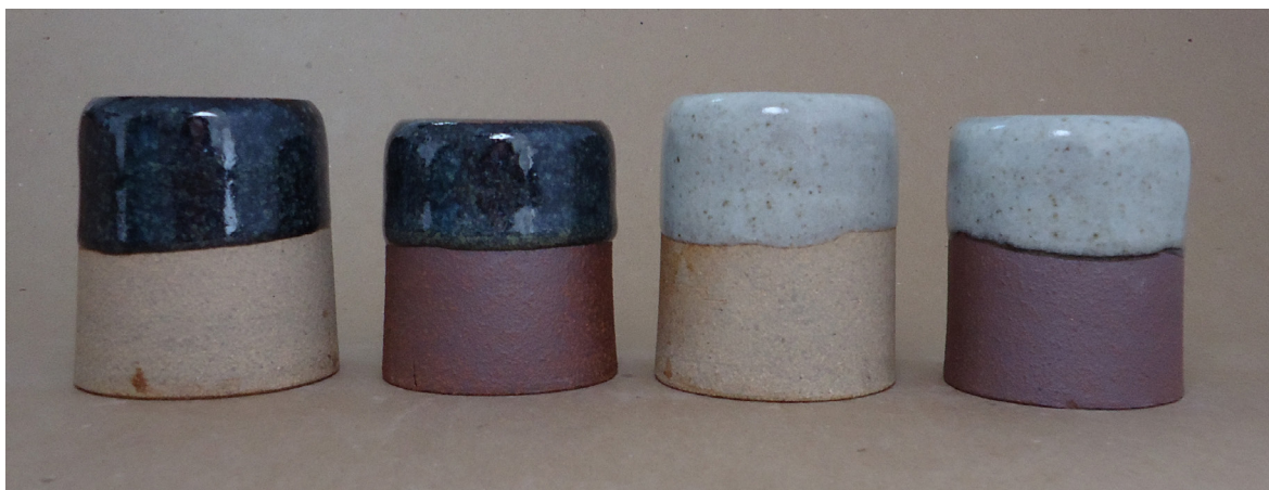
Figura 342. Vidrado pronto: argila branca e vermelha, queima em forno a gás, cone 9 (1280°C).
