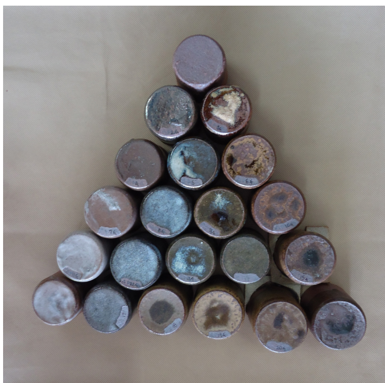
Figura 303. Triangulação 1: argila vermelha, queima em forno a gás, cone 9 (1280°C).
