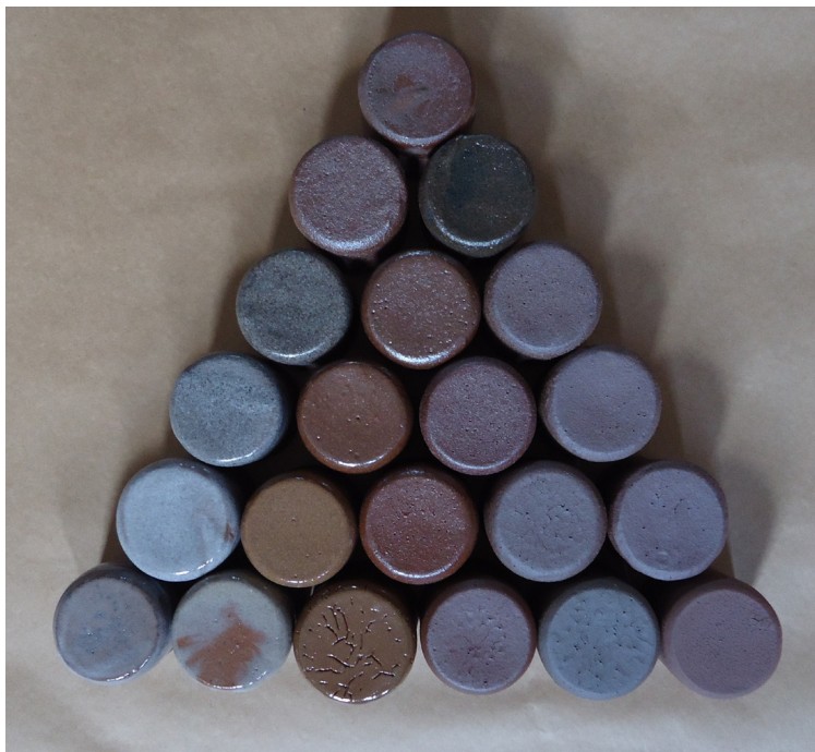
Figura 317. Triangulação 2: argila vermelha, queima em forno a gás, cone 9 (1280°C).
