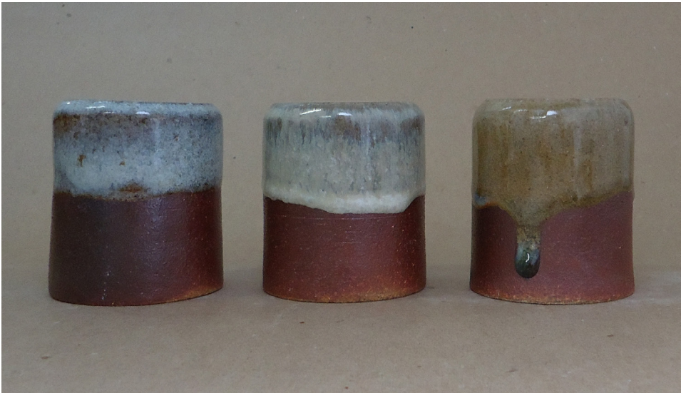
Figura 354. Triangulação 1 (P12, P13, P14): argila branca, queima em forno noborigama , cone 15 (1420°C)
