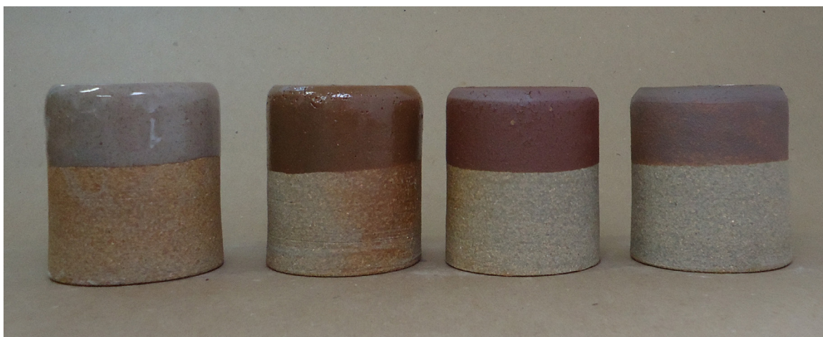
Figura 322. Triangulação 2 (P17, P18, P19, P20): argila branca, queima em forno a gás, cone 9 (1280°C).
