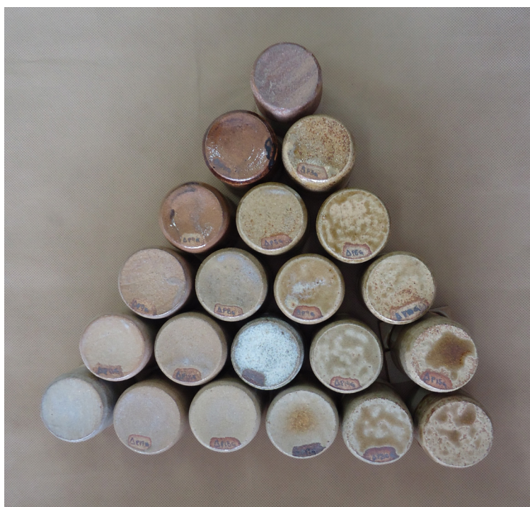
Figura 302. Triangulação 1: argila branca, queima em forno a gás, cone 9 (1280°C).
