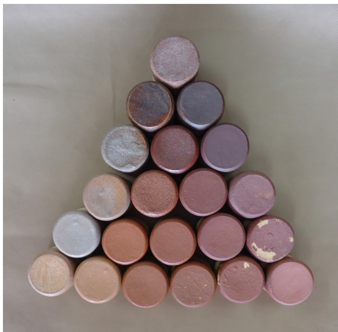
Figura 273. Triangulação 2: argila branca, queima em forno elétrico, cone 8 (1263°C).
