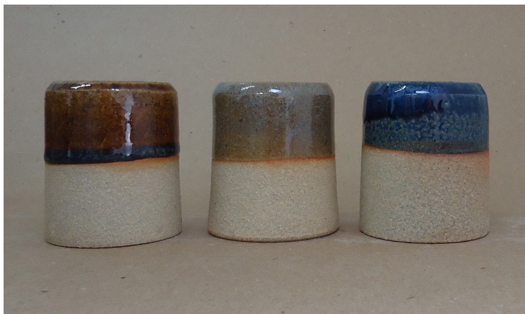
Figura 338. Pontos coloridos (base P13): argila branca, queima em forno a gás, cone 9 (1280°C).
