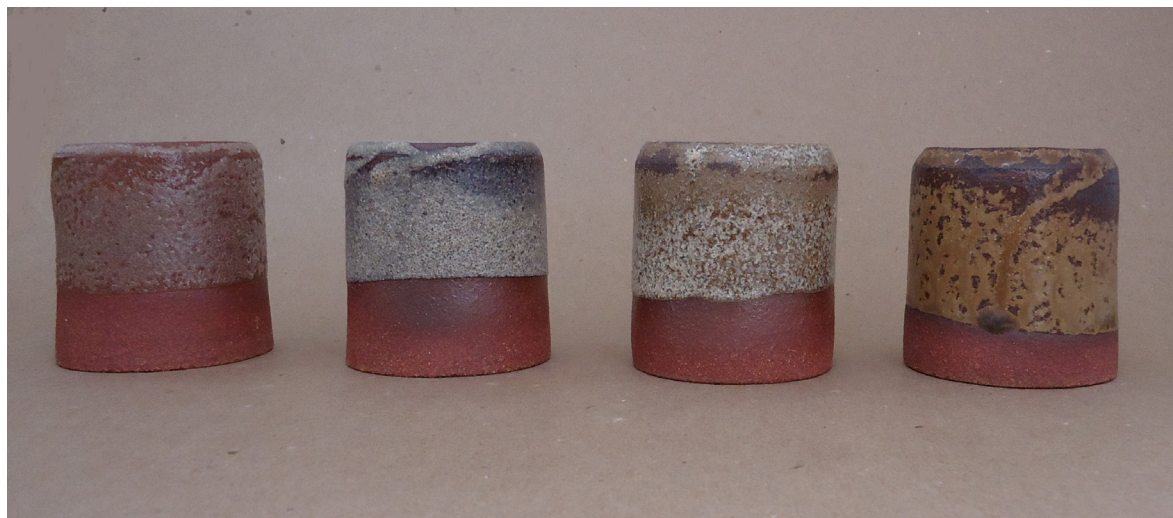
Figura 270. Triangulação 1 (P7, P8, P9, P10): argila vermelha, forno elétrico, cone 8 (1263°C).
