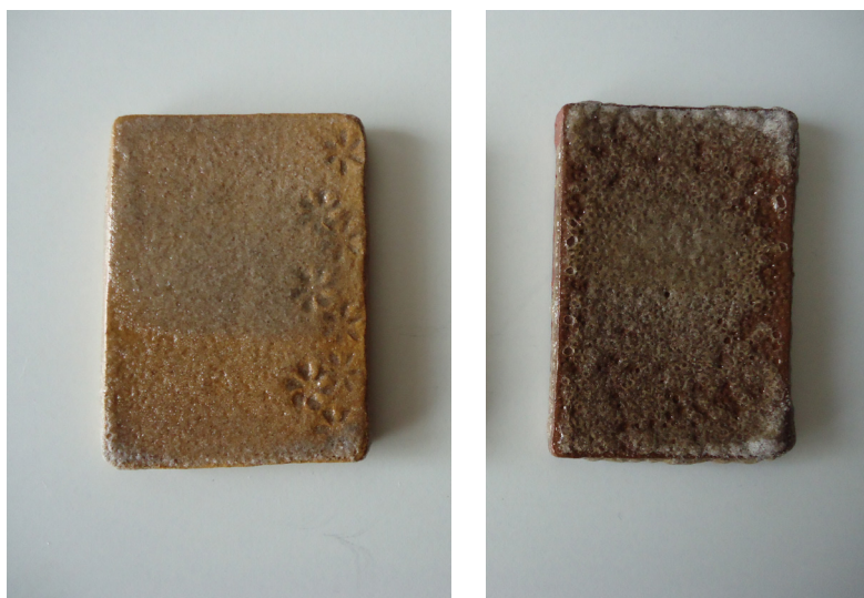
Figura 250. Argila branca: 50% BC + 50% feld. Figura 251. Argila vermelha: 50% BC+ 50% feld.
