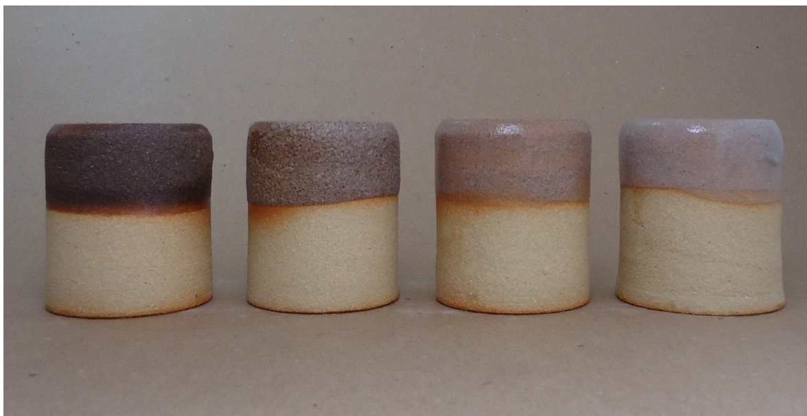
Figura 275. Triangulação 2 (P2, P4, P7, P11): argila branca, queima em forno elétrico, cone 8 (1263°C).
