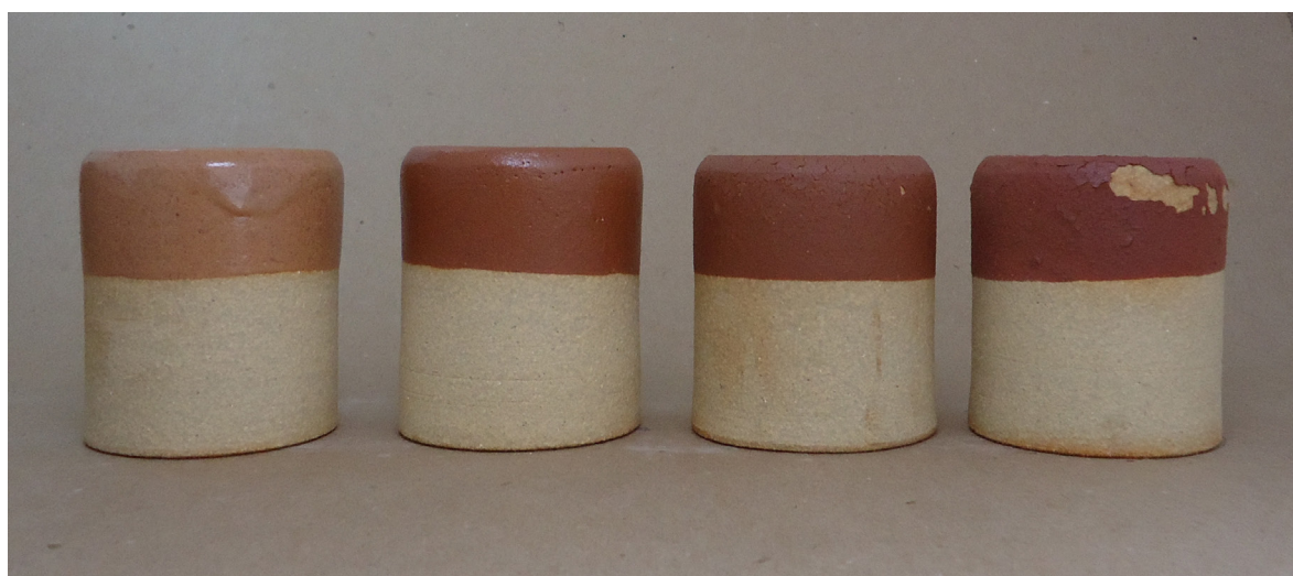
Figura 279. Triangulação 2 (P17, P18, P19, P20: argila branca, queima em forno elétrico, cone 8 (1263°C).
