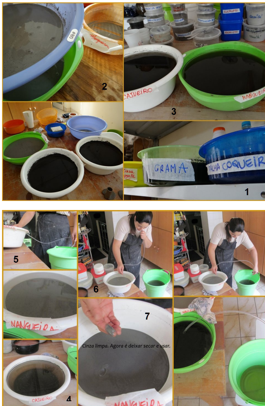
Figuras 214 e 215. Processo de lavagem das cinzas: 1- Separar e identificar as cinzas; 2- Peneirar; 3- Acrescentar água e deixar a cinza decantar; 4- Cinza decantada; 5 e 6- A água é trocada sete vezes com auxílio de uma mangueira (por sucção); 7- Feitas as sete lavagens, retira-se toda a água e coloca-se as cinzas para secar em uma caixa com jornal.
