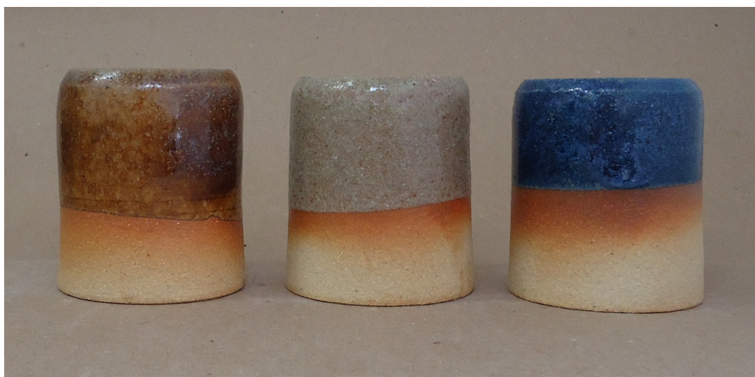
Figura 293. Pontos coloridos (base P13): argila branca, queima em forno elétrico, cone 8 (1263°C).
