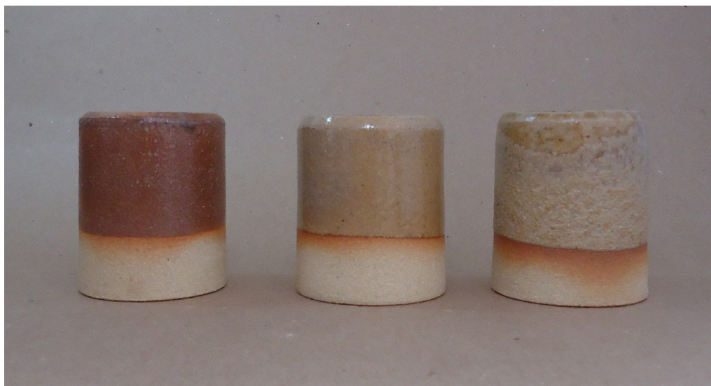
Figura 267. Triangulação1 (P4, P5, P6): argila branca, queima em forno elétrico, cone 8 (1263°C).
