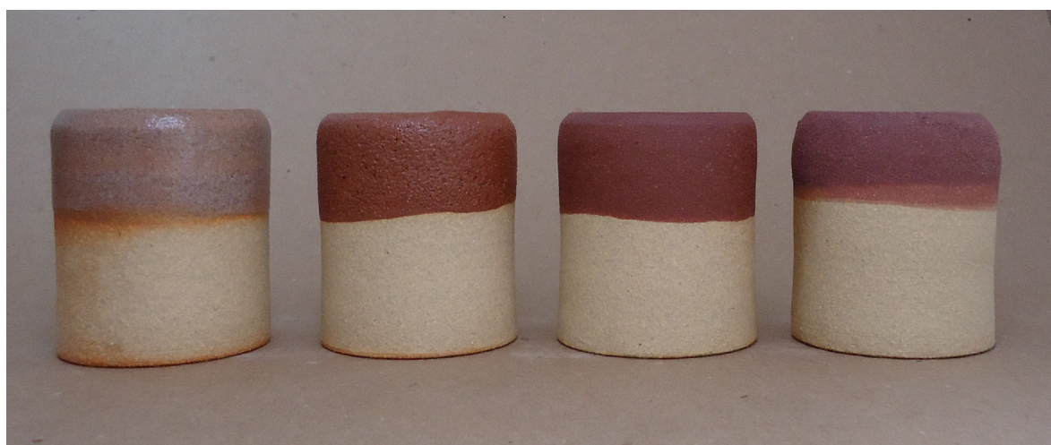
Figura 283. Triangulação 2 (P7, P8, P9, P10): argila branca, queima em forno elétrico- cone 8- 1263°C.
