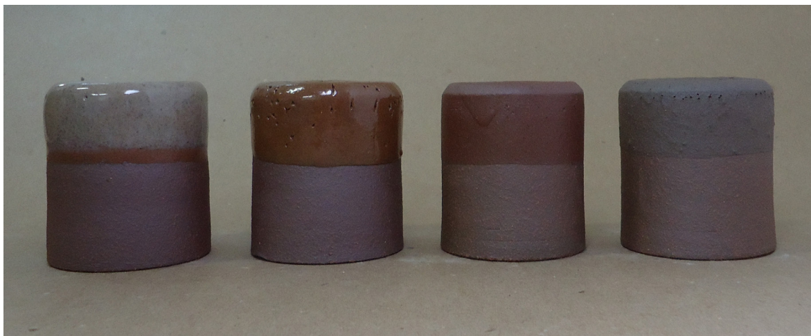
Figura 323. Triangulação 2 (P17, P18, P19, P20): argila vermelha, queima em forno a gás, cone 9 (1280°C).
