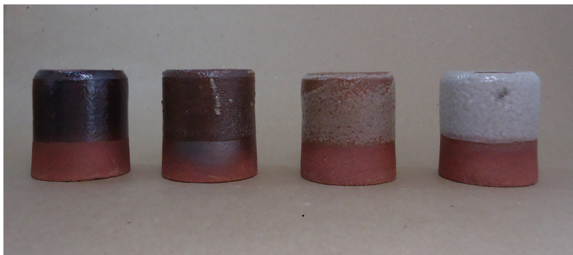
Figura 261. Triangulação (P2, P4, P7, P11): argila vermelha, forno elétrico, cone 8 (1263°C).
