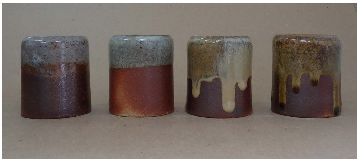
Figura 353. Triangulação 1 (P7, P8, P9, P10): argila branca, queima em forno noborigama , cone 15 (1420°C)
