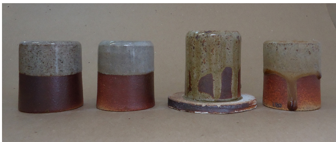
Figura 351. Triangulação 1 (P17, P18, P19, P20): argila branca, queima em forno noborigama , cone 15 (1420°C)
