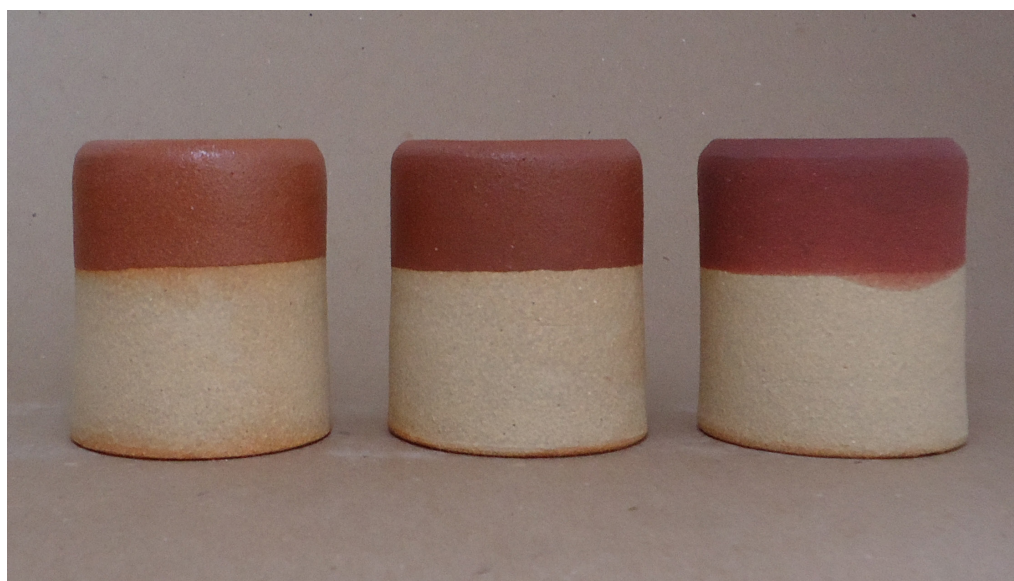
Figura 285. Triangulação 2 (P12, P13, P14): argila branca, queima em forno elétrico, cone 8 (1263°C).
