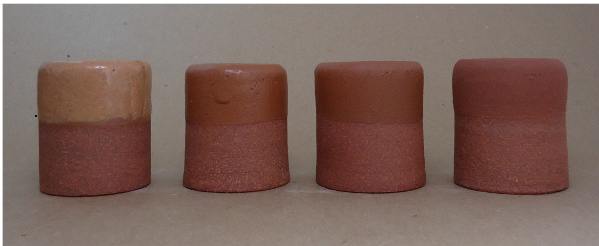
Figura 280. Triangulação 2 (P17, P18, P19, P20: argila vermelha, forno elétrico, cone 8 (1263°C)).
