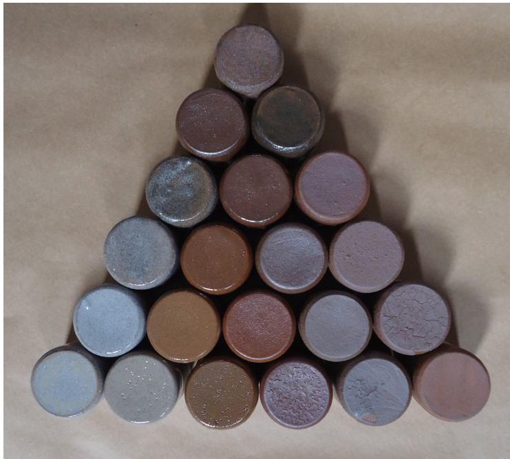
Figura 316. Triangulação 2: argila branca, queima em forno a gás, cone 9 (1280°C).
