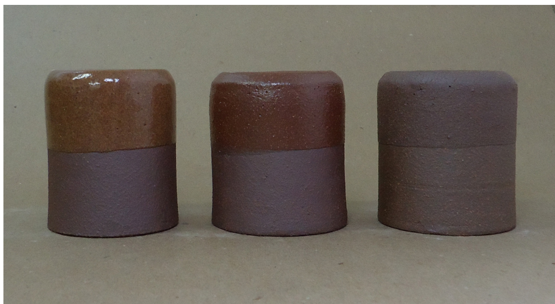
Figura 329. Triangulação 2 (P12, P13, P14): argila vermelha, queima em forno a gás, cone 9 (1280°C).
