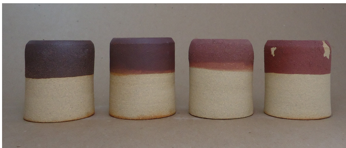
Figura 277. Triangulação 2 (P3, P6, P10, P15): argila branca, queima em forno elétrico, cone 8 (1263°C).
