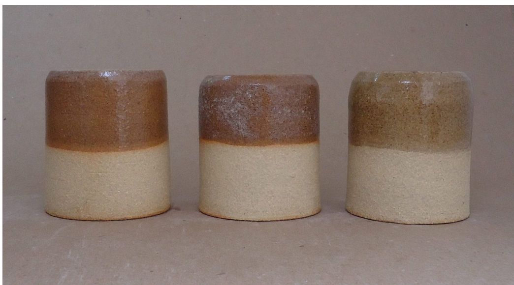
Figura 295. Pontos modificados: argila branca, queima em forno elétrico, cone 8 (1263°C).
