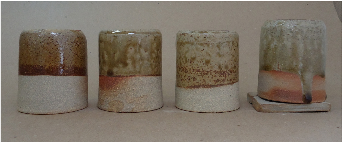
Figura 306. Triangulação 1 (P3, P6, P10, P15): argila branca, queima em forno a gás, cone 9 (1280°C).
