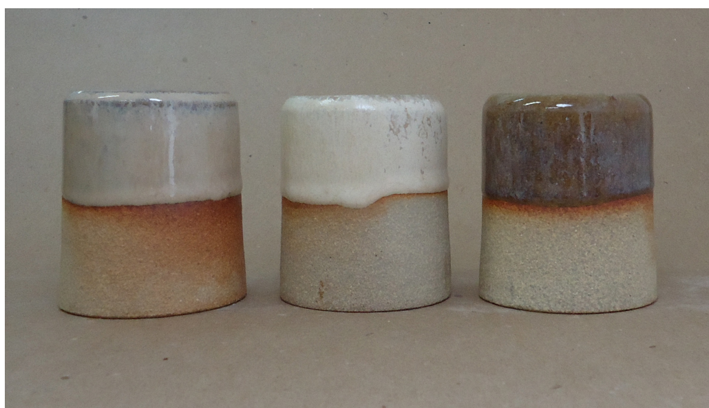
Figura 336. Pontos coloridos (base P13): argila branca, queima em forno a gás, cone 9 (1280°C).
