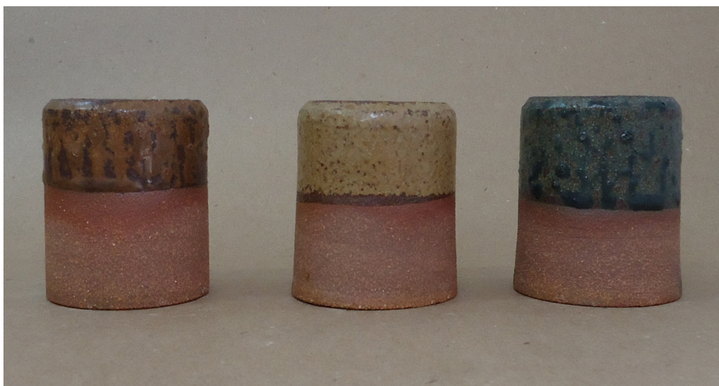
Figura 290. Pontos coloridos (base P10): argila vermelha, forno elétrico, cone 8 (1263°C).
