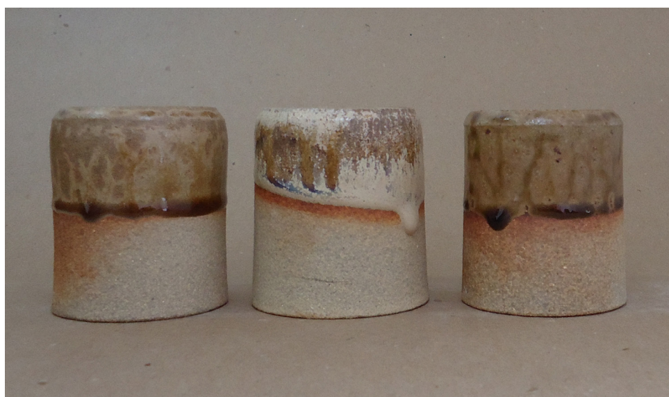
Figura 330. Pontos coloridos (base P10): argila branca, queima em forno a gás, cone 9 (1280°C).
