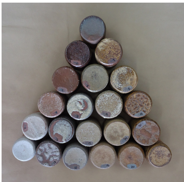
Figura 259. Triangulação 1: argila vermelha, forno elétrico, cone 8 (1263°C).
