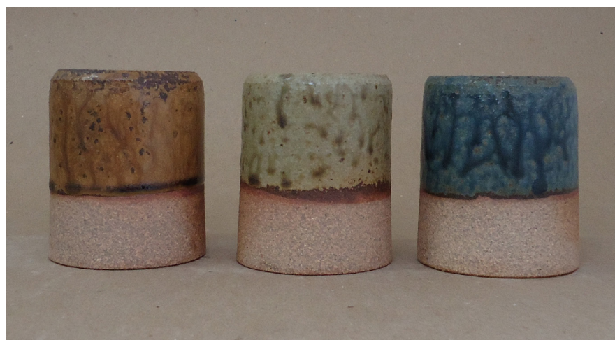
Figura 335. Pontos coloridos (base P10): argila branca, queima em forno a gás, cone 6 (1222° C).
