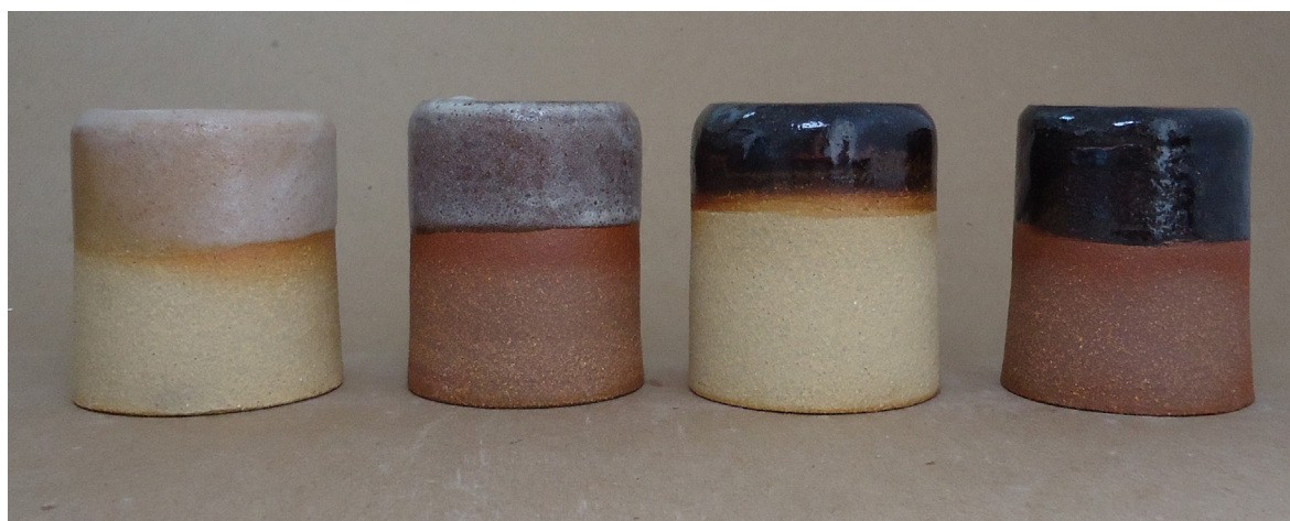
Figura 297. Vidrado pronto: argila branca e vermelha, queima em forno elétrico, cone 8 (1263°C).
