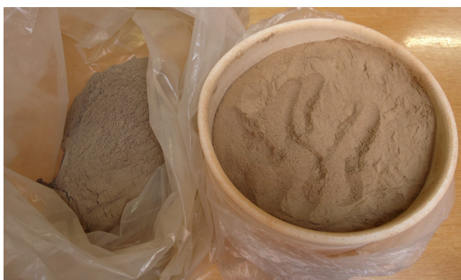
Figura 226. Cinza do bagaço da cana retirado da caldeira.
