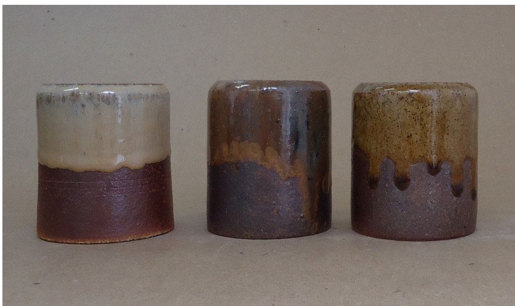
Figura 364. Pontos coloridos (base P13): argila branca, queima em forno noborigama , cone 15 (1420°C).
