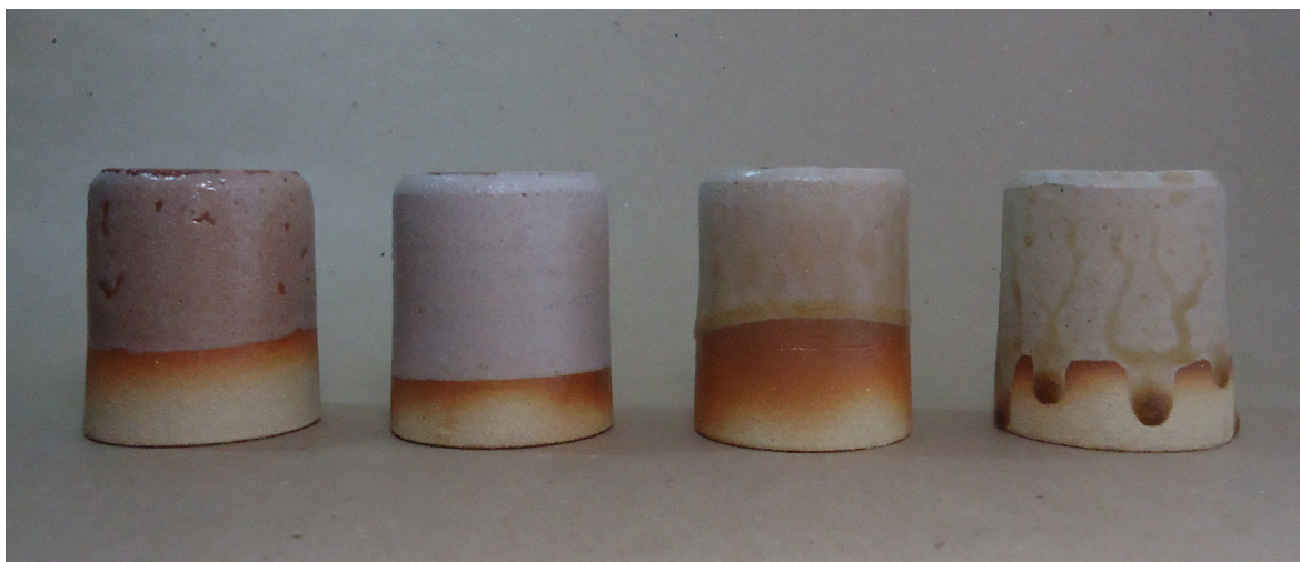
Figura 265. Triangulação 1 (P17, P18, P19, P20): argila branca, queima em forno elétrico, cone 8 (1263°C).
