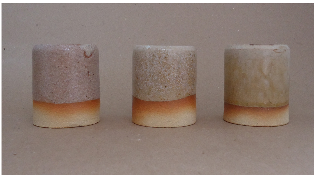
Figura 271. Triangulação 1 (P12, P13, P14): argila branca, queima em forno elétrico, cone 8 (1263°C).
