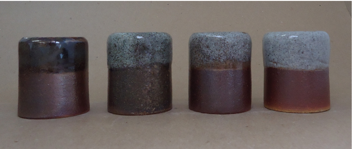
Figura 356. Triangulação 2 (P2, P4, P7, P11): argila branca, queima em forno noborigama , cone 15 (1420°C).
