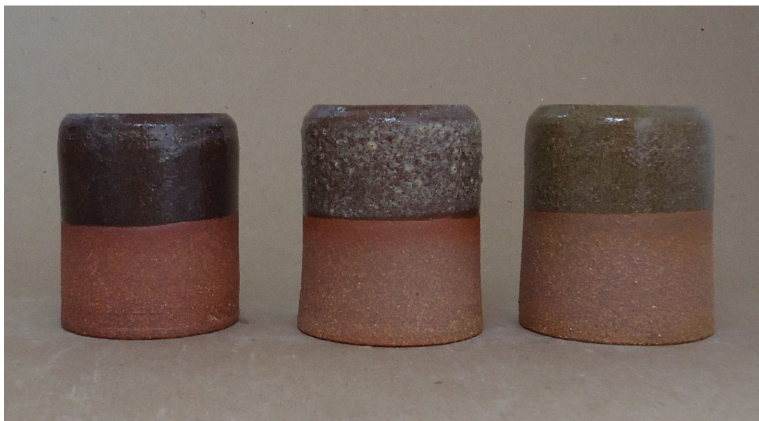
Figura 296. Pontos modificados- Argila vermelha –forno elétrico- cone8- 1263° C.
