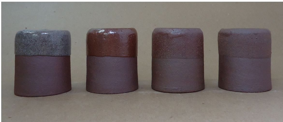
Figura 327. Triangulação 2 (P7, P8, P9, P10): argila vermelha, queima em forno a gás, cone 9 (1280°C).
