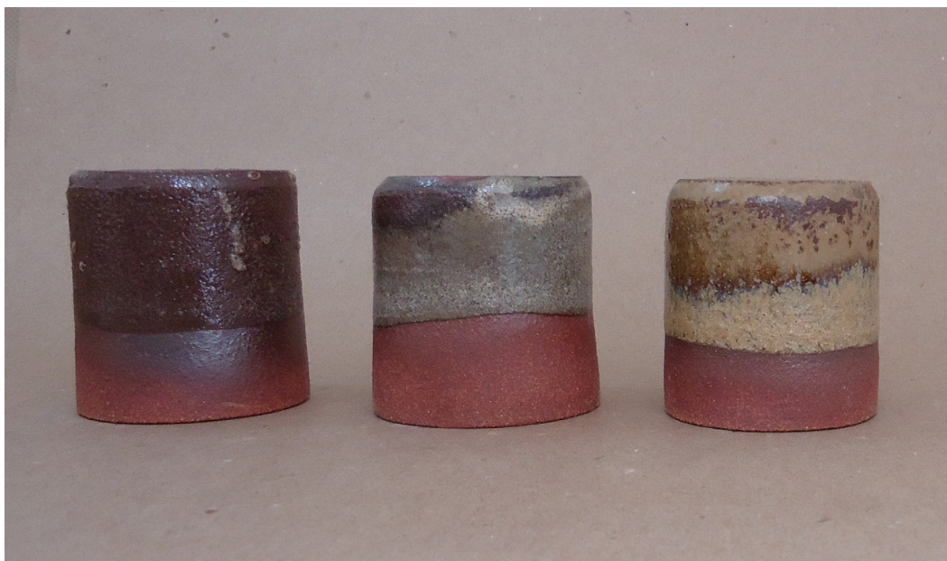
Figura 268. Triangulação 1 (P4, P5, P6): argila vermelha, forno elétrico, cone 8 (1263°C).
