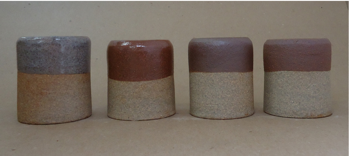
Figura 326. Triangulação 2 (P7, P8, P9, P10): argila branca, queima em forno a gás, cone 9 (1280°C).
