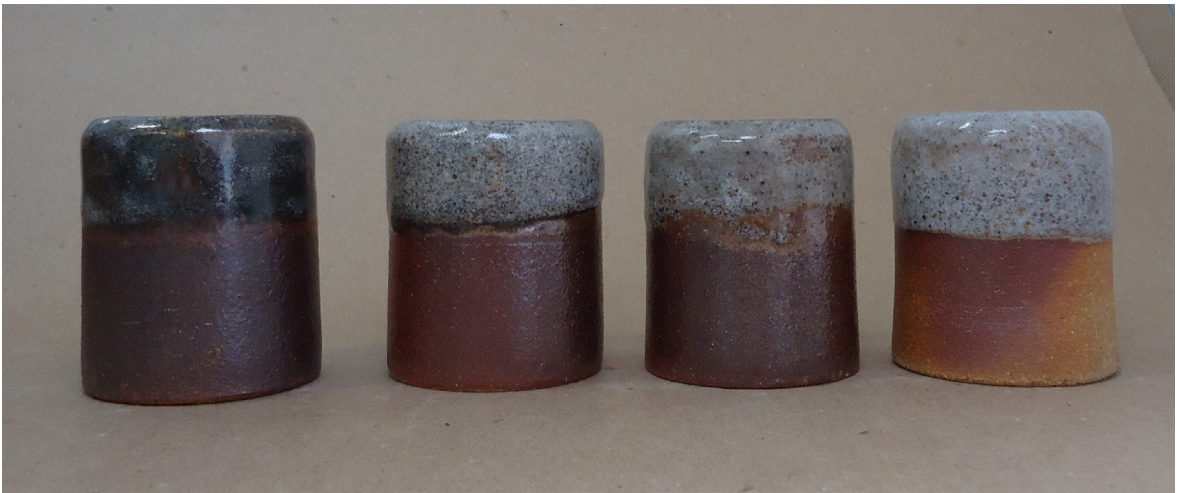
Figura 349. Triangulação 1 (P2, P4, P7, P11): argila branca, queima em forno noborigama , cone 15 (1420°C).
