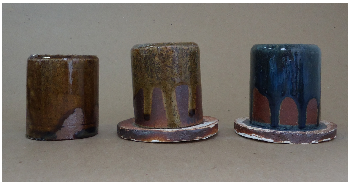
Figura 363. Pontos coloridos (Base P10): argila branca, queima em forno noborigama , cone 15 (1420°C).
