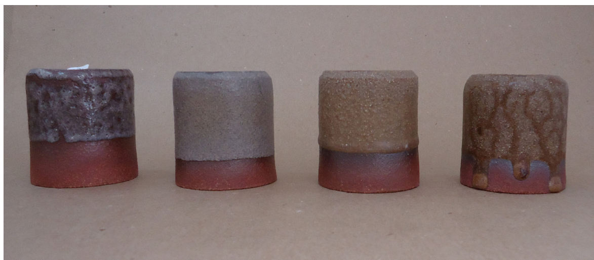
Figura 266. Triangulação 1 (P17, P18, P19, P20): argila vermelha, forno elétrico, cone 8 (1263°C).
