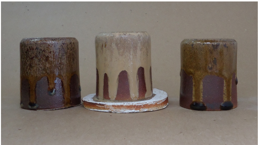
Figura 362. Pontos coloridos (base P10): argila branca, queima em forno noborigama , cone 15 (1420°C).
