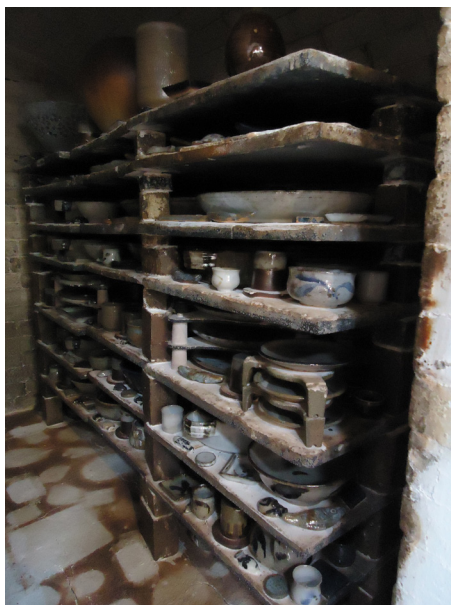
Figura 347. Câmara de forno noborigama na abertura de fornada.
