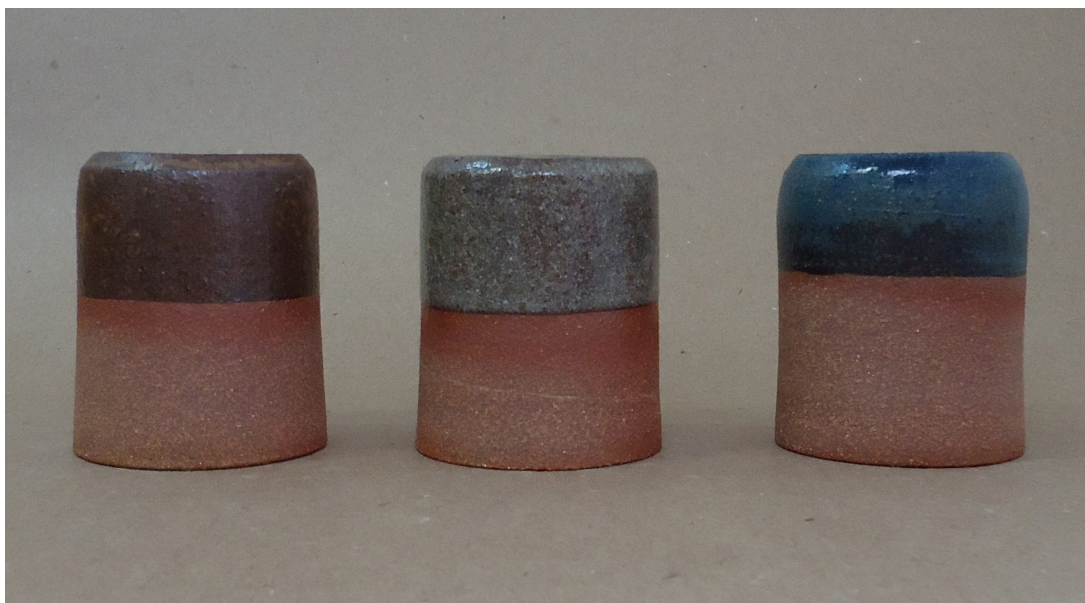
Figura 294. Pontos coloridos (base P13): argila vermelha, forno elétrico, cone 8 (1263°C).
