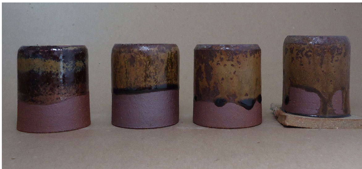
Figura 307. Triangulação 1 (P3, P6, P10, P15): argila vermelha, queima em forno a gás, cone 9 (1280°C).
