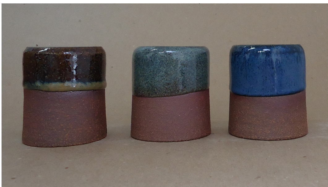
Figura 339. Pontos coloridos (base P13): argila vermelha, queima em forno a gás, cone 9 (1280°C).
