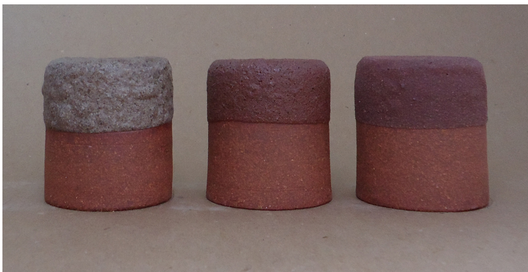
Figura 282. Triangulação 2 (P4, P5, P6), , argila vermelha, forno elétrico, cone 8 (1263°C).
