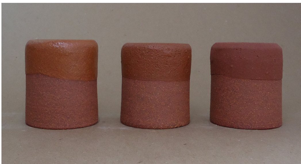
Figura 286. Triangulação 2 (P12, P13, P14): argila vermelha, forno elétrico, cone 8 (1263°C).
