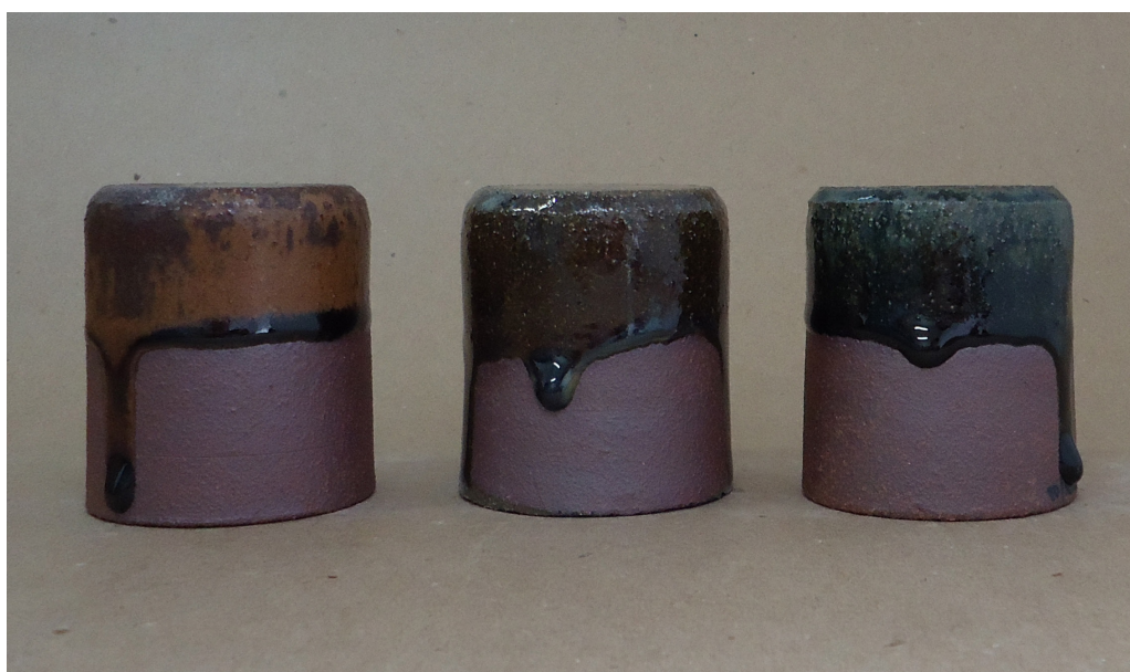
Figura 333. Pontos coloridos (base P10): argila vermelha, queima em forno a gás, cone 9 (1280°C).
