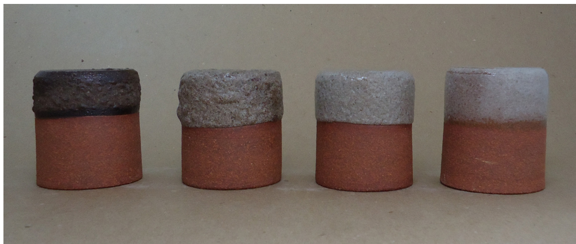
Figura 276. Triangulação 2 (P2, P4, P7, P11): argila vermelha, forno elétrico, cone 8 (1263°C).
