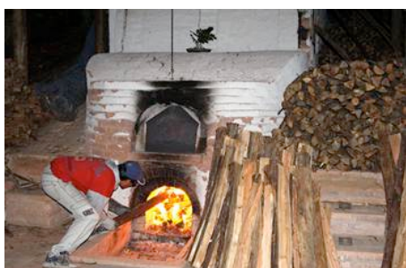
◇ Enfornamento das cerâmicas esmaltadas no forno Noborigama, prontas para a queima em alta temperatura
