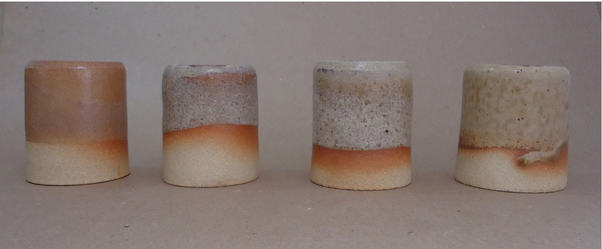
Figura 269. Triangulação 1 (P7, P8, P9, P10): argila branca, queima em forno elétrico, cone 8 (1263°C).
