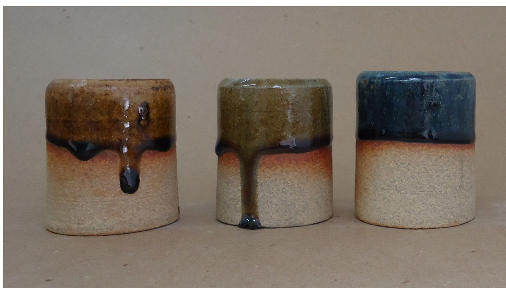
Figura 332. Pontos coloridos (base P10): argila branca, queima em forno a gás, cone 9 (1280°C).
