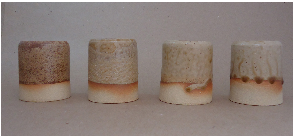
Figura 262. Triangulação 1 (P3, P6, P10, P15): argila branca, forno elétrico, cone 8 (1263°C).
