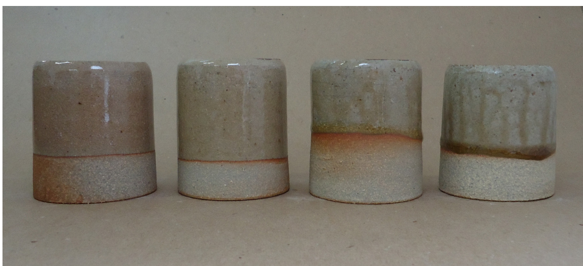
Figura 308. Triangulação 1 (P17, P18, P19, P20): argila branca, queima em forno a gás, cone 9 (1280°C).
