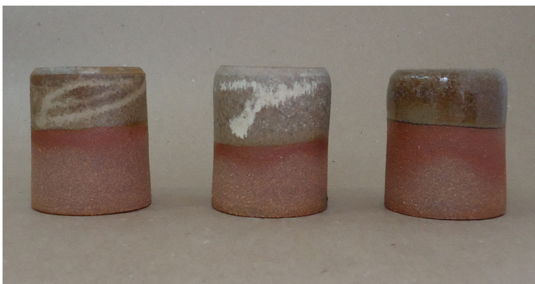
Figura 292. Pontos coloridos (base P13): argila vermelha, forno elétrico, cone 8 (1263°C).
