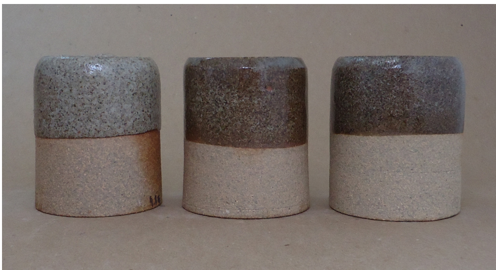
Figura 340. Pontos modificados: argila branca, queima em forno a gás, cone 9 (1280°C).
