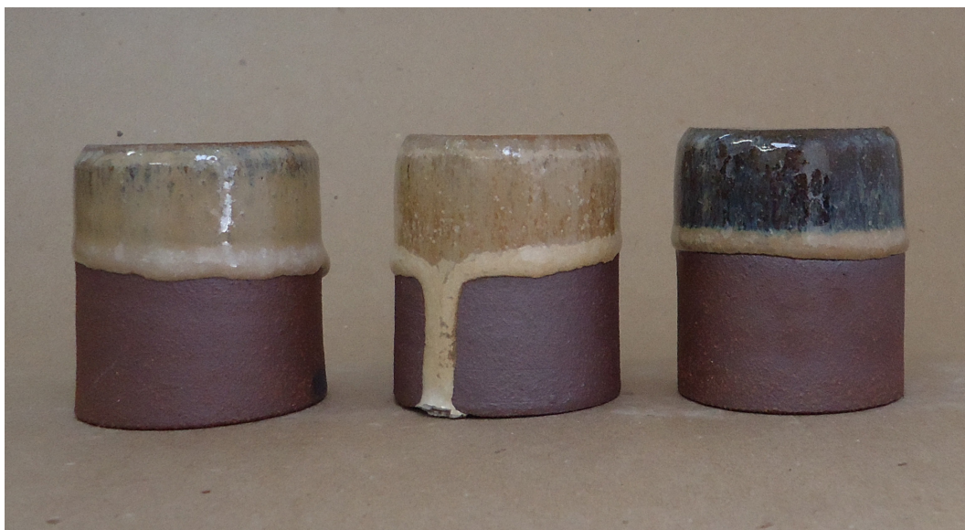
Figura 337. Pontos coloridos (base P13): argila vermelha, queima em forno a gás, cone 9 (1280°C).
