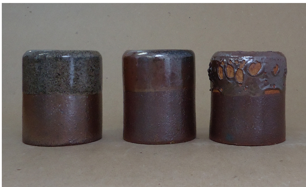
Figura 361. Triangulação 2 (P12, P13, P14): argila branca, queima em forno noborigama , cone 15 (1420°C).
