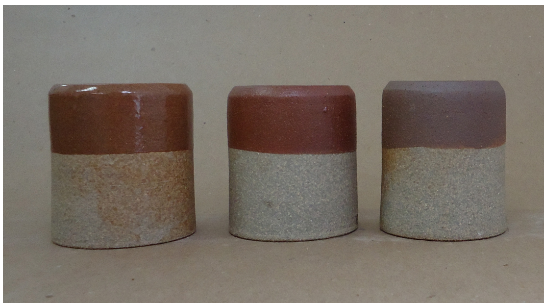
Figura 328. Triangulação 2 (P12, P13, P14): argila branca, queima em forno a gás, cone 9 (1280°C).
