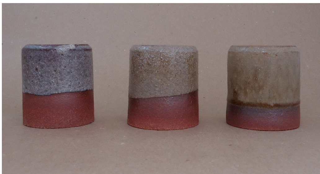
Figura 272. Triangulação 1 (P12, P13, P14): argila vermelha, forno elétrico, cone 8 (1263°C).
