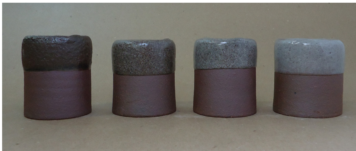
Figura 319. Triangulação 2 (P2, P4, P7, P11): argila vermelha, queima em forno a gás, cone 9 (1280°C).
