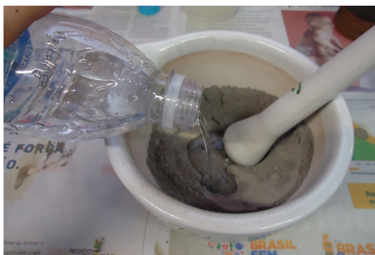
Figura 232. Moagem a seco. Figura 233. Acrescentando água.
