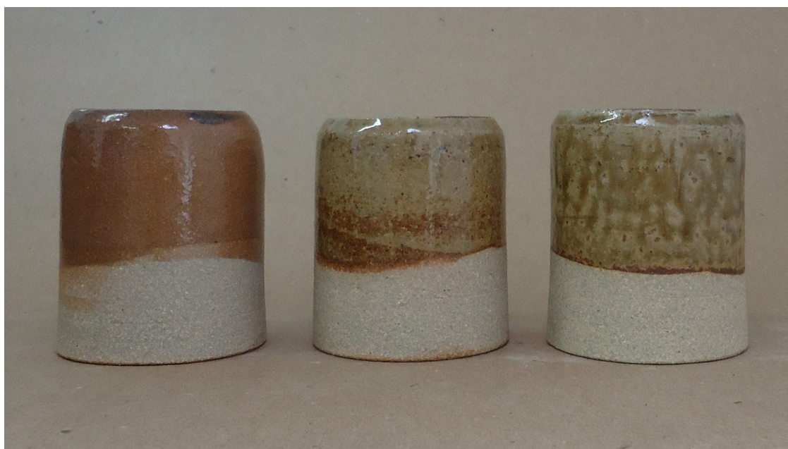
Figura 310. Triangulação 1 (P4, P5, P6): argila branca, queima em forno a gás, cone 9 (1280°C).
