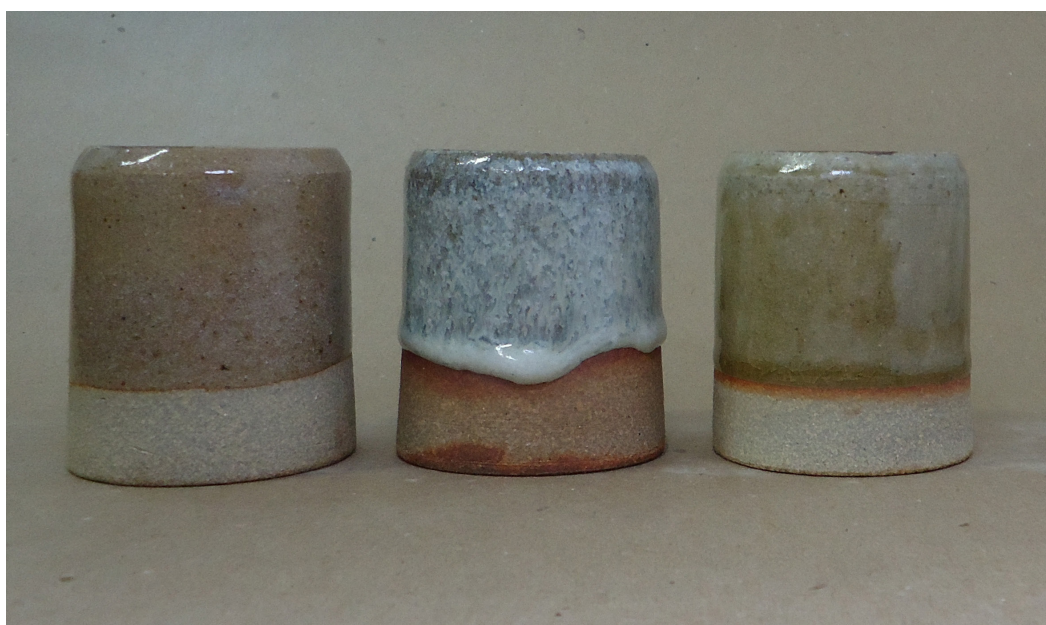
Figura 314. Triangulação1 (P12, P13, P14): argila branca, queima em forno a gás- cone 9 (1280°C).
