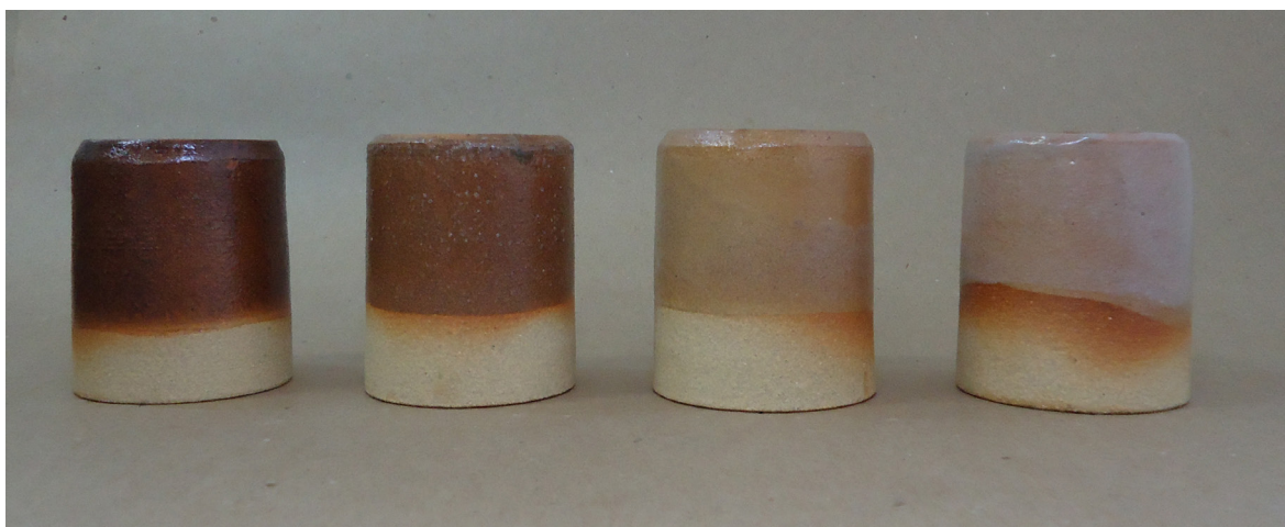
Figura 260. Triangulação1 (P2, P4, P7, P11): argila branca, queima em forno elétrico, cone 8 (1263°C).
