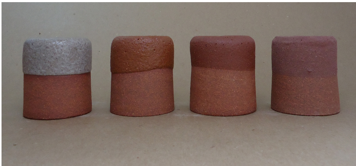
Figura 284. Triangulação 2 (P7, P8, P9, P10): argila vermelha, forno elétrico, cone 8 (1263°C).
