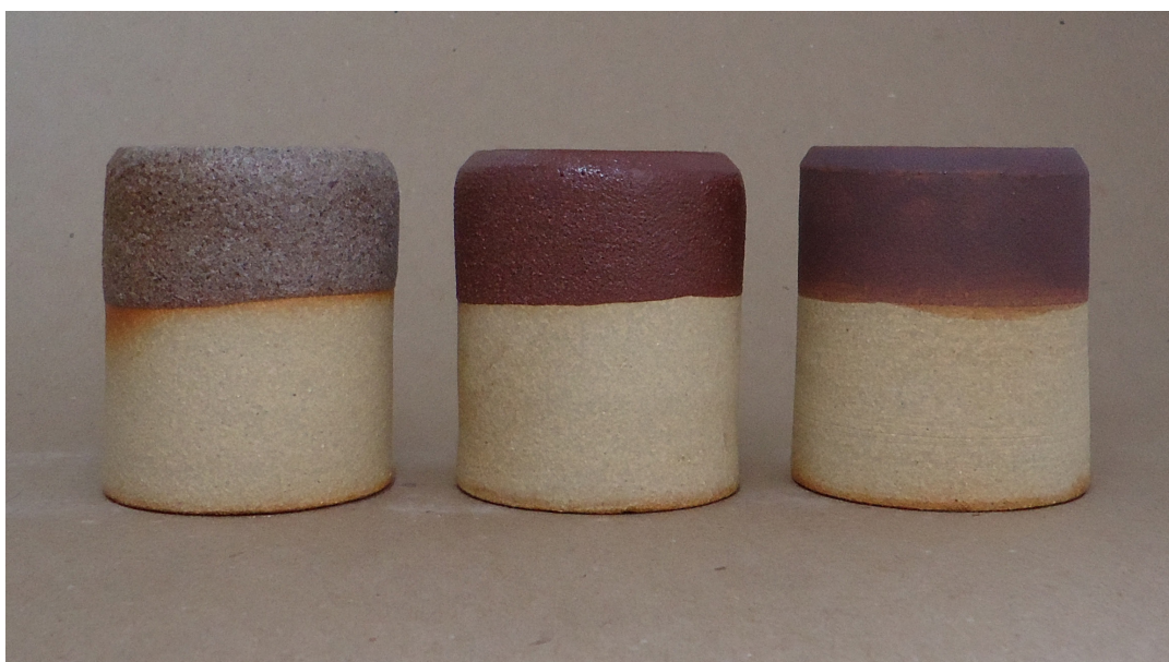
Figura 281. Triangulação 2 (P4, P5, P6), argila branca, queima em forno elétrico, cone 8 (1263°C).
