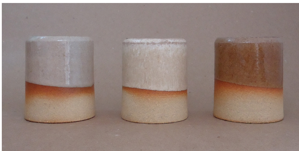
Figura 291. Pontos coloridos (base P13): argila branca, queima em forno elétrico, cone 8 (1263°C).
