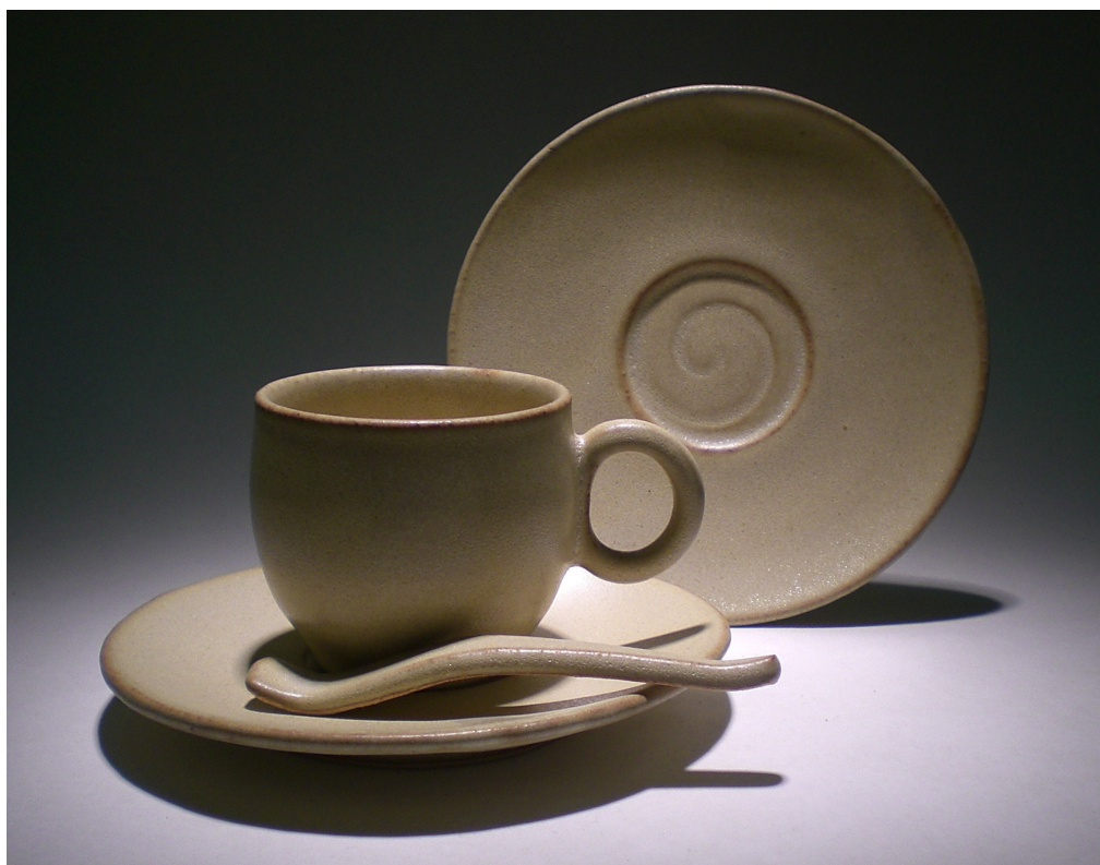
Figura 198. Utilitário com vidrado de cinzas (40%), queima em forno elétrico.
