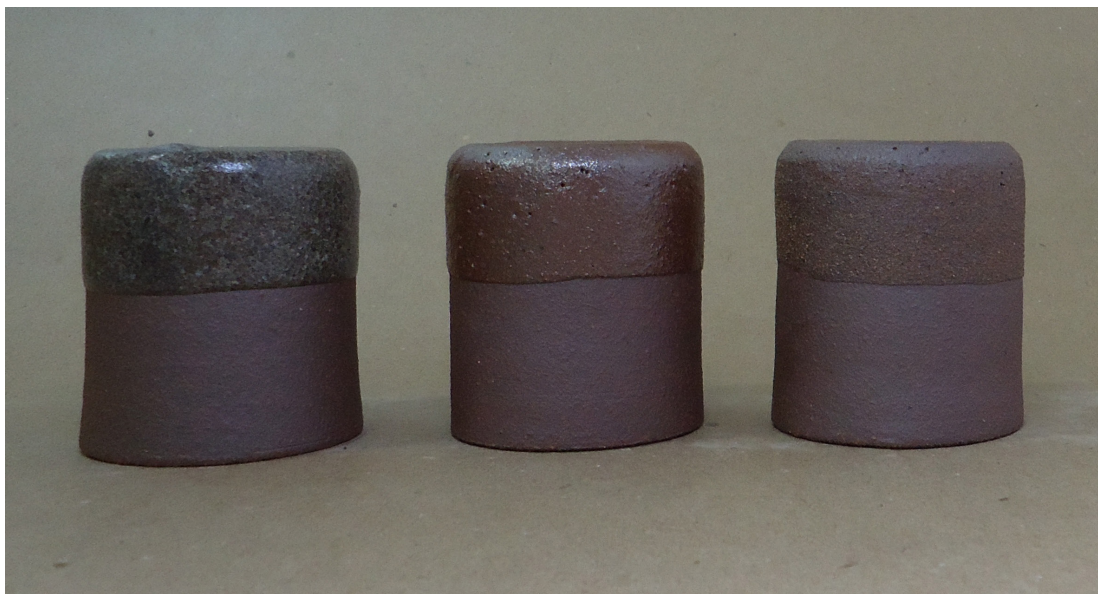
Figura 325. Triangulação 2 (P4, P5, P6): argila vermelha, queima em forno a gás, cone 9 (1280°C).
