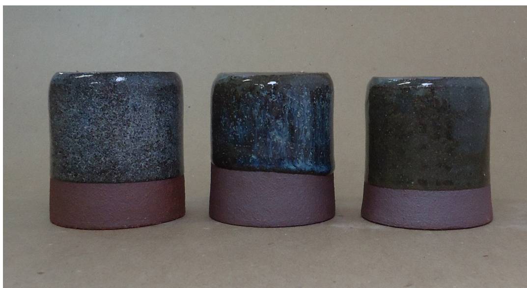
Figura 315. Triangulação 1 (P12, P13, P14): argila vermelha, queima em forno a gás, cone 9 (1280°C).
