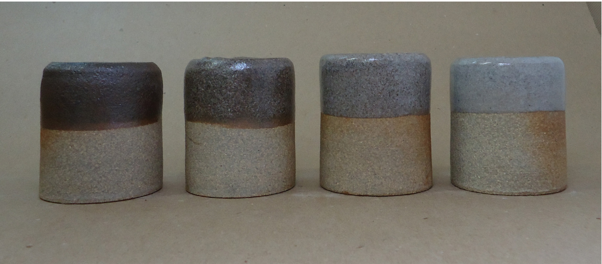
Figura 318. Triangulação 2 (P2, P4, P7, P11): argila branca, queima em forno a gás, cone 9 (1280°C).
