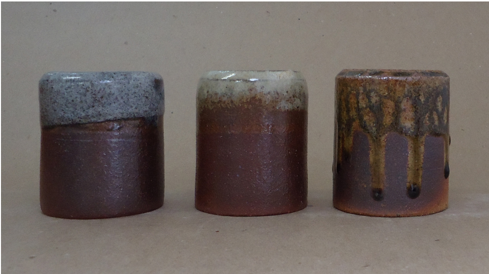
Figura 352. Triangulação 1 (P4, P5, P6): argila branca, queima em forno noborigama , cone 15 (1420°C).
