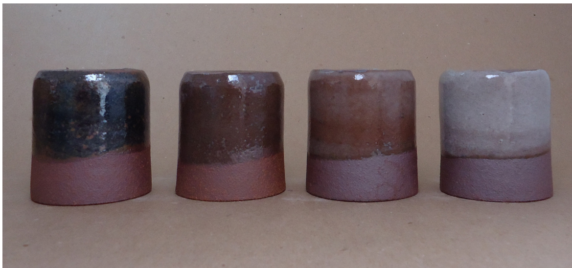
Figura 305. Triangulação 1 (P2, P4, P7, P11): argila vermelha, queima em forno a gás, cone 9 (1280°C).
