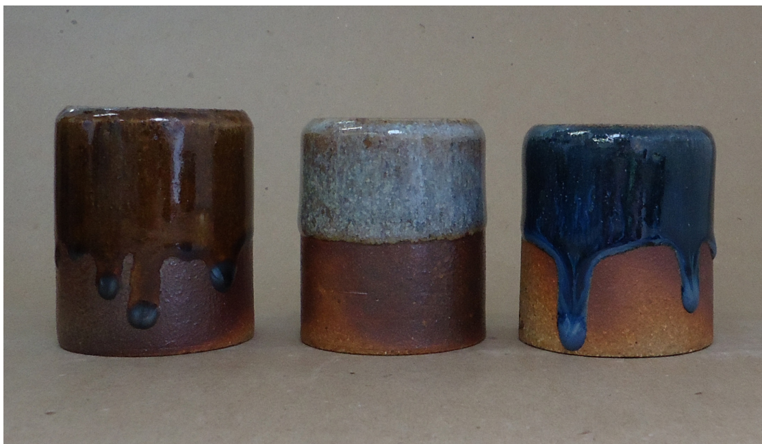
Figura 365. Pontos coloridos (base P13): argila branca, queima em forno noborigama , cone 15 (1420°C).
