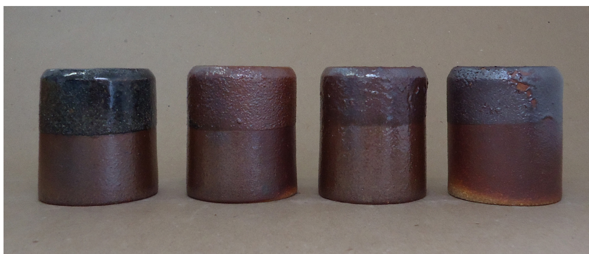
Figura 357. Triangulação 1 (P3, P6, P10, P15): argila branca, queima em forno noborigama , cone 15 (1420°C).
