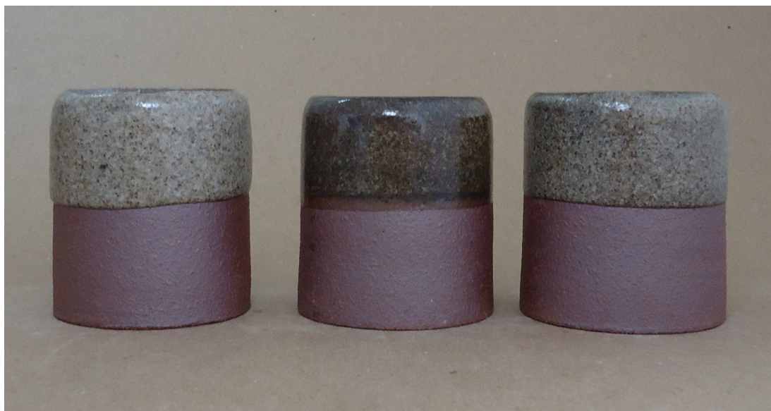
Figura 341. Pontos modificados: argila branca, queima em forno a gás, cone 9 (1280°C).
