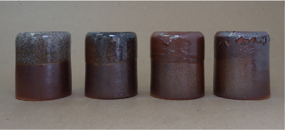
Figura 360. Triangulação 2 (P7, P8, P9, P10): argila branca, queima em forno noborigama , cone 15 (1420°C).
