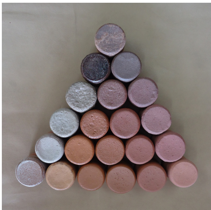
Figura 274. Triangulação 2: argila vermelha, forno elétrico, cone 8 (1263°C).
