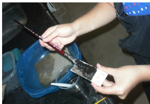
Figura 242. Esmaltação por deposição.
