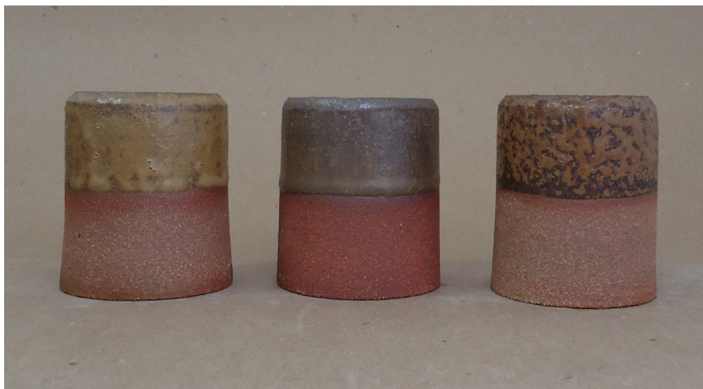
Figura 288. Pontos coloridos (base P10): argila vermelha, forno elétrico, cone 8 (1263°C).
