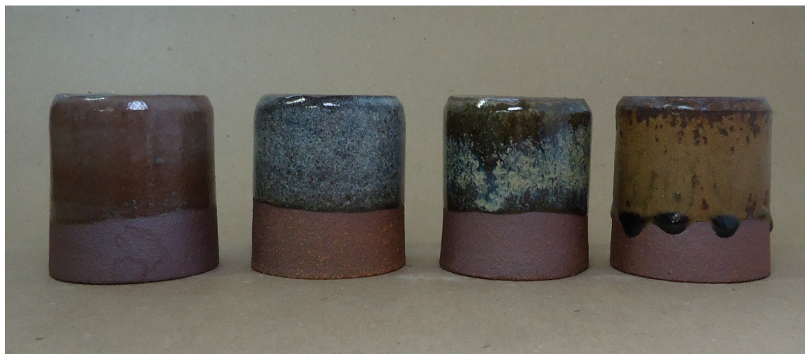
Figura 313. Triangulação 1 (P7, P8, P9, P10): argila vermelha, queima em forno a gás, cone 9 (1280°C).
