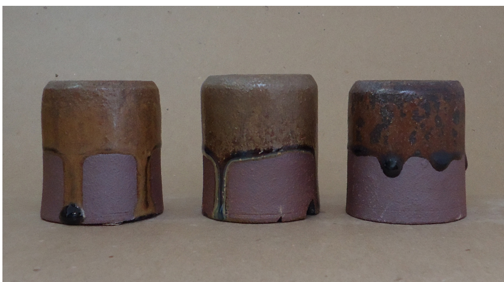
Figura 331. Pontos coloridos (base P10): argila vermelha, queima em forno a gás, cone 9 (1280°C).
