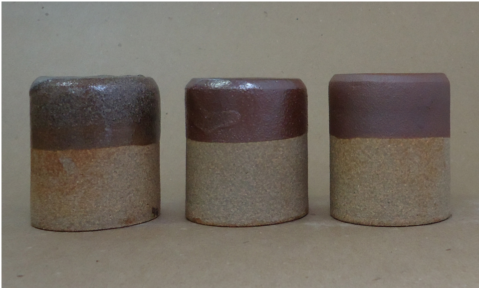
Figura 324. Triangulação 2 (P4, P5, P6): argila branca, queima em forno a gás, cone 9, (1280°C).
