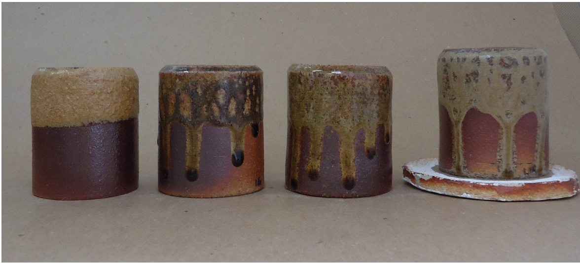
Figura 350. Triangulação 1 (P3, P6, P10, P15): argila branca, queima em forno noborigama , cone 15 (1420°C)
