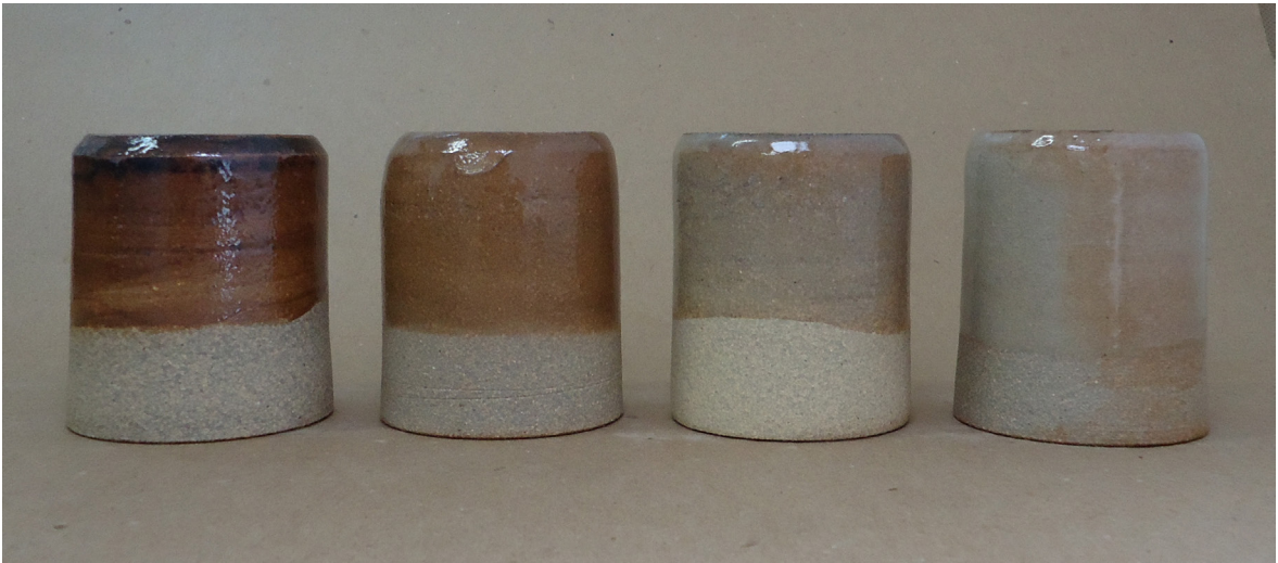
Figura 304. Triangulação 1 (P2, P4, P7, P11): argila branca, queima em forno a gás, cone 9 (1280°C).
