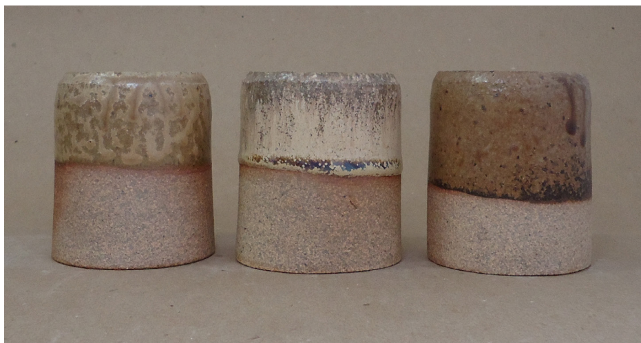
Figura 334. Pontos coloridos (base P10): argila branca, queima em forno a gás, cone 6 (1222°C).
