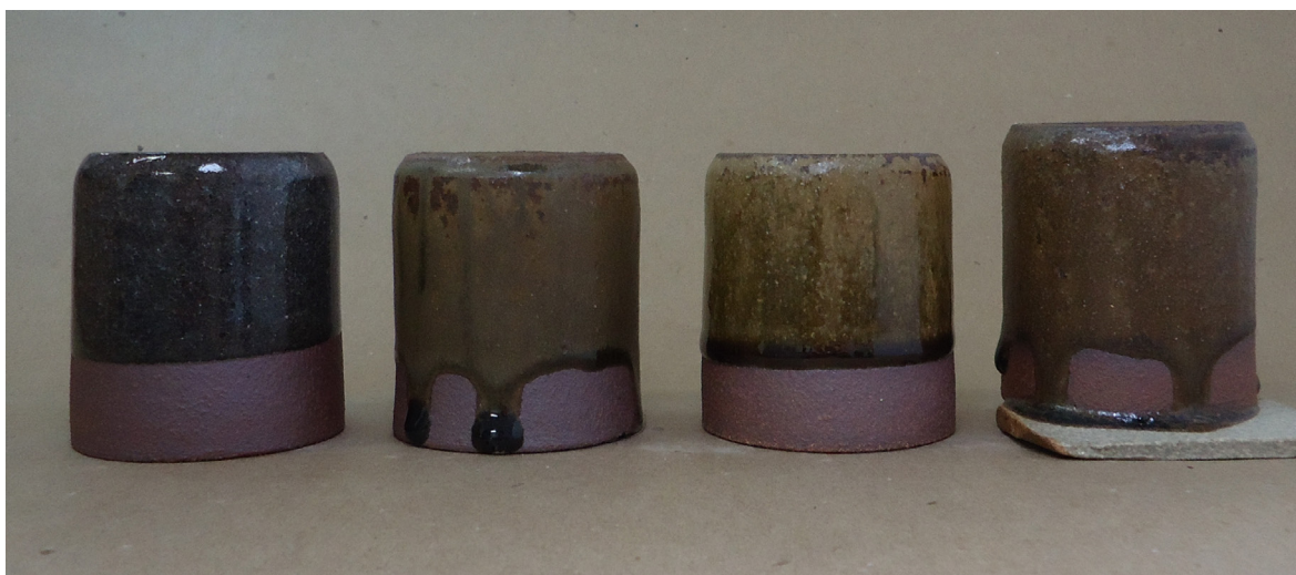
Figura 309. Triangulação 1 (P17, P18, P19, P20): argila vermelha, queima em forno a gás, cone 9 (1280°C).
