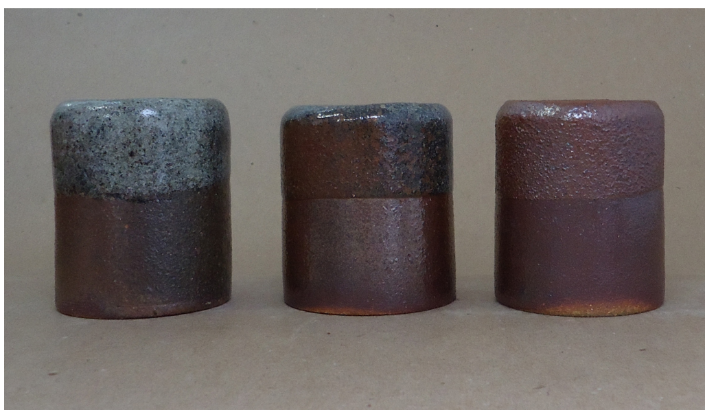
Figura 359. Triangulação 2 (P4, P5, P6): argila branca, queima em forno noborigama , cone 15 (1420°C).
