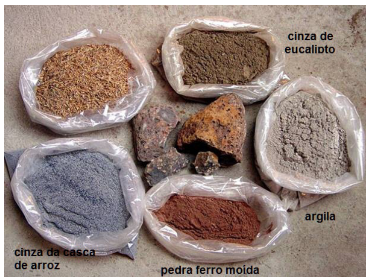
Figura 180. Materiais que compõem o vidrado de pedra-ferro.
