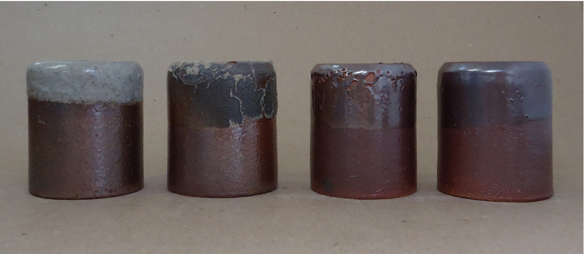
Figura 358. Triangulação 2 (P17, P18, P19, P20): argila branca, queima em forno noborigama , cone 15 (1420°C).
