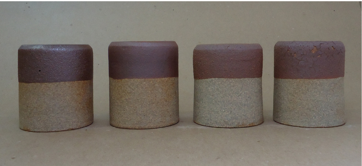
Figura 320. Triangulação 2 (P3, P6, P10, P15): argila branca, queima em forno a gás, cone 9 (1280°C).
