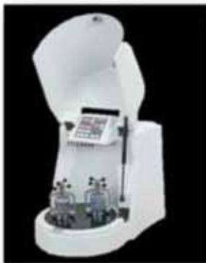
3. Moinho de Bola utilizado para triturar os grãos de hidroxiapatita (Planetary Micro Mill Pulverisette, Fritsh).
