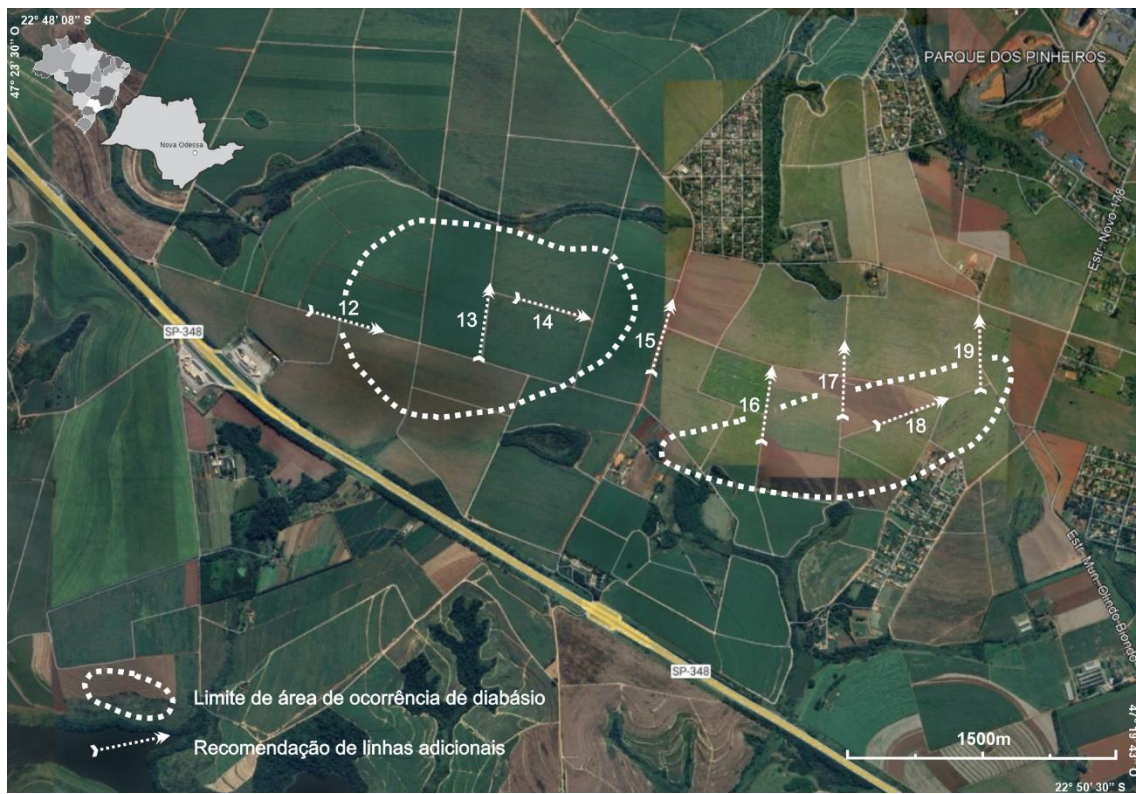
Figura 8 – Localização da área de estudos, com destaque para as linhas de tomografia elétrica realizadas em estudo posterior.
