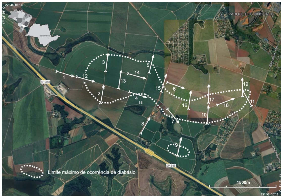
Figura 29 – Limite do diabásio a partir dos contatos e áreas de ocorrência reconhecidos nas seções geofísicas.
