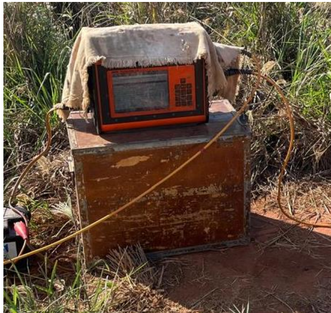
Figura 6 – Resistímetro Terrameter LS usado nas aquisições de campo.
