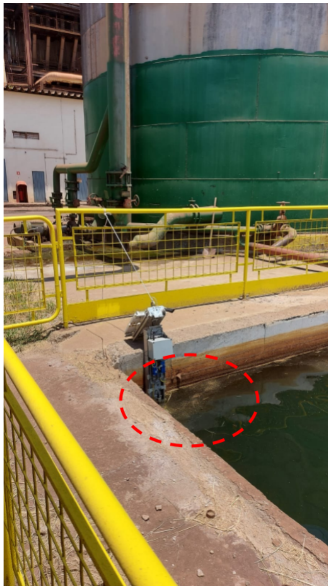
Figura 41 - Acúmulo de biomassa nas regiões dos receptores dos sensores.
