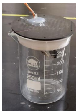
Figura 3.6: Becker com tampa feita por impressora 3D.
