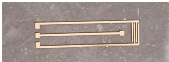
Figura 3.5: Eletrodo interdigitado feito sobre o substrato de vidro pelo método de evaporação térmica.
