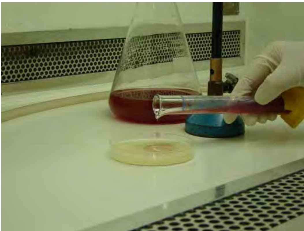
FIGURA 5 – Adição da solução 0,1% de cloreto de trifênil tetrazolium e 1% de ágar
