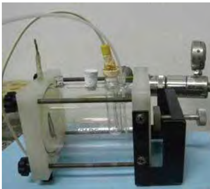
Figura 6 - Imagem da célula eletroquímica utilizada nos ensaios de polarização potenciodinâmica.
