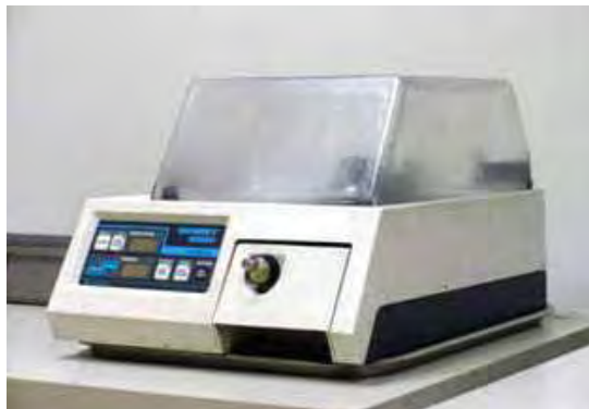
Figura 15 - Serra de precisão Buehler Isomet 1000.
