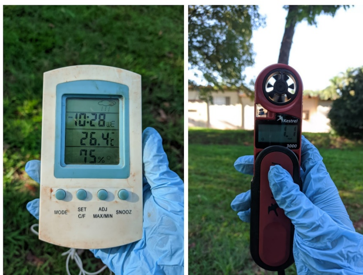
Figura 1. Aparelhos utilizados para a medição das variáveis climáticas no momento das aplicações. 01 - Temperatura (°C) e UR (%) no início da aplicação; 02 - Registro da velocidade do vento (km/h) durante da aplicação.
