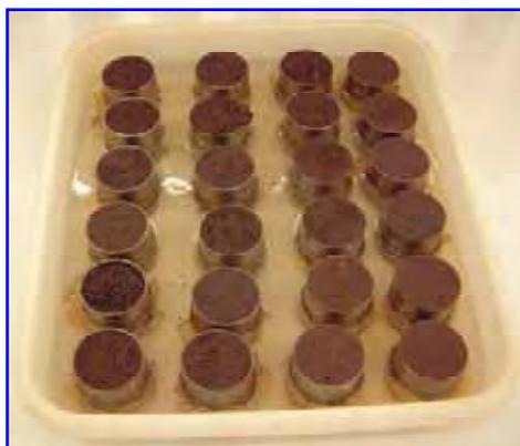
**Figura 8.** Amostras volumétricas sendo saturadas.
