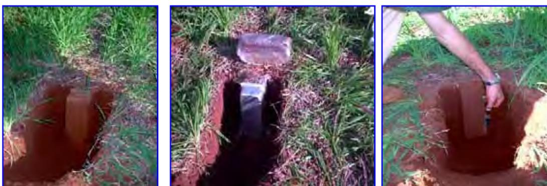
**Figura 10.** Detalhe da trincheira para coleta do bloco de solo em sistema de semeadura direta.
