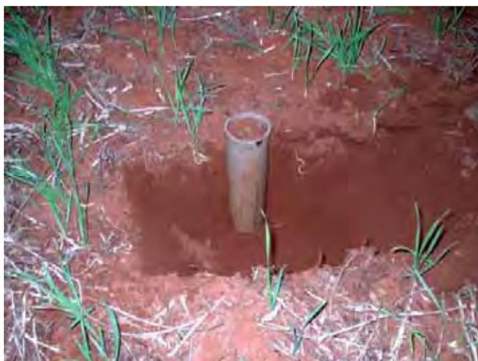
**Figura 3.** Coleta com amostrador de PVC de 0-0,20 m no tratamento semeadura direta.
