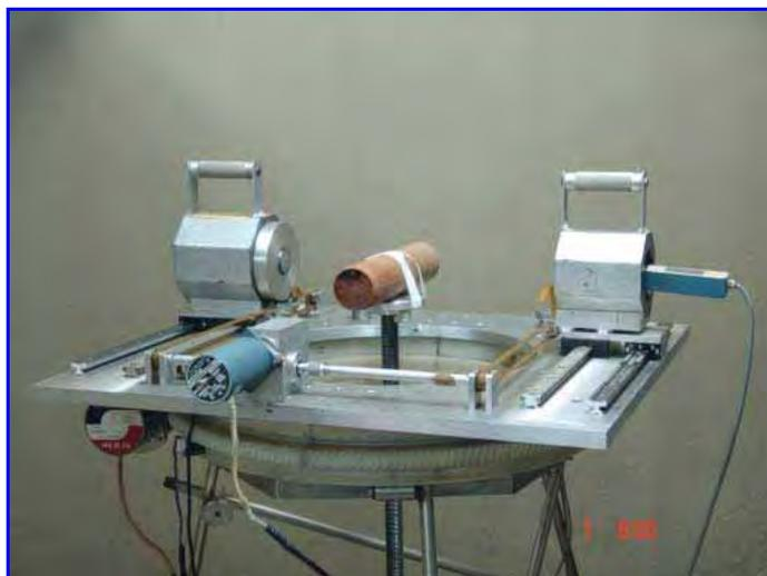
**Figura 5.** Amostra sendo processada no tomógrafo de primeira geração.
