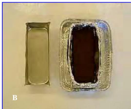
**Figura 11.** A) Impregnação da amostra com resina com auxílio de bomba a vácuo e dessecador. B) Detalhe do amostrador de aço usado em campo para a coleta e da amostra impregnada dentro da forma de alumínio.
