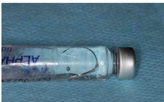
Figura 2.10 - Vidro rachado no tubete odontológico. Imagem: Elaborada pelo autor.
