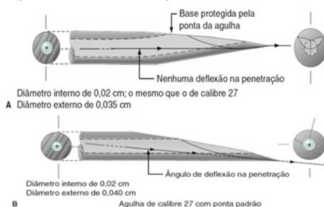
Figura 3.4 - A. A ponta de uma agulha não defletora está localizada no centro do eixo, minimizando a deflexão à medida que a agulha penetra nos tecidos moles; B. Agulha odontológica convencional. A ponta da agulha encontra-se na borda inferior do eixo da agulha, produzindo deflexão à medida que a agulha passa através do tecido mole. Imagem: Malamed, 2013.
