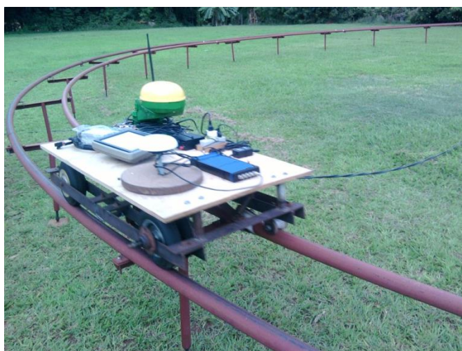
Figura 51 - Receptores B e C instalados no veículo motorizado já sobre o trilho.
