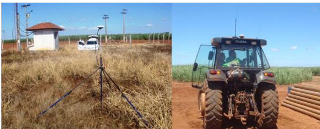
Figura 50 - Base utilizada para a inferência dos parâmetros de atividade da ionosfera e trator utilizado como Rover .
