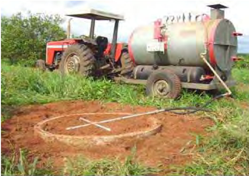
Figura 2. Caldeira móvel a diesel utilizada para o tratamento do solo das microparcels com vapor (COPEC - Indústria e Comércio de Caldeiras Ltda. Espírito Santo do Pinhal - SP).
