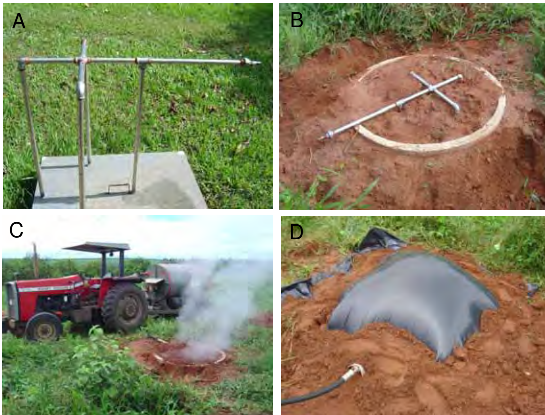
Figura 3. Tratamento do solo das microparcelsas com vapor. A) Dispositivo para a aplicação do vapor em profundidade. B) Dispositivo fincado no solo para possibilitar a aplicação uniforme do vapor em profundidade. C) Aplicação do vapor produzido por uma caldeira móvel. D) Microparcelsa coberta com lona plástica de 120 \mu\text{m} de espessura para a retenção do vapor.
