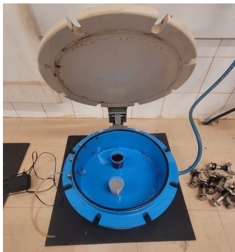
Figura 1 – Extrator (câmara) de Richards para ensaio de resistência dos microrganismos à pressão
