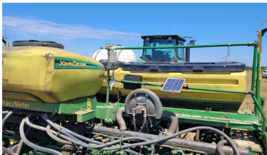
Figura 3 - Semeadora para plantio de soja, com tanque de injeção de inoculante (em branco) e sensores de temperatura do ar e da calda para monitoramento
