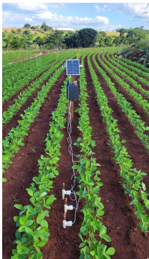
Figura 1 - Vista dos tensiômetros automáticos, em três profundidades, para manejo da irrigação
