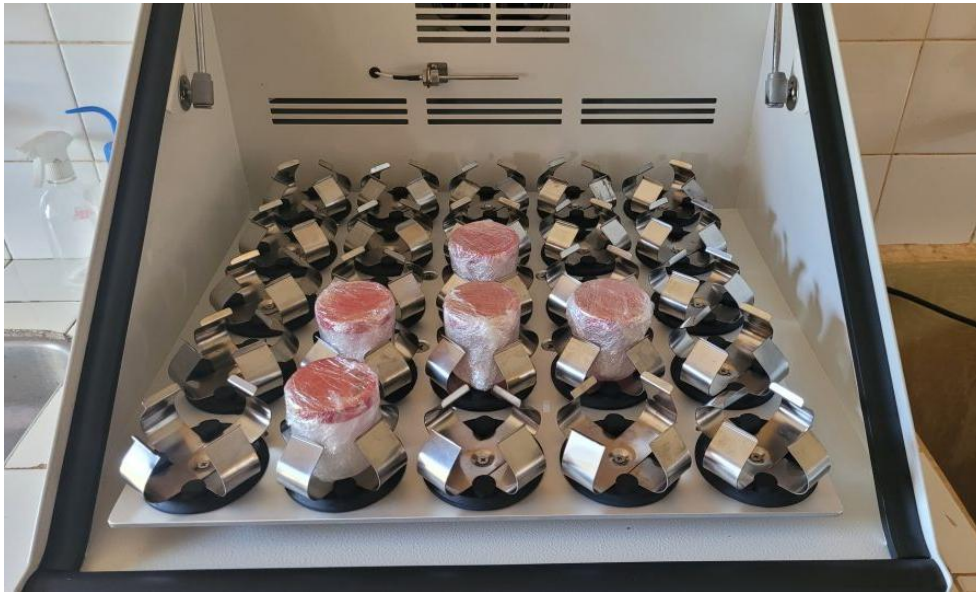
Figura 2 - Amostras em agitador orbital para ensaio de resistência a diferentes valores de pH
