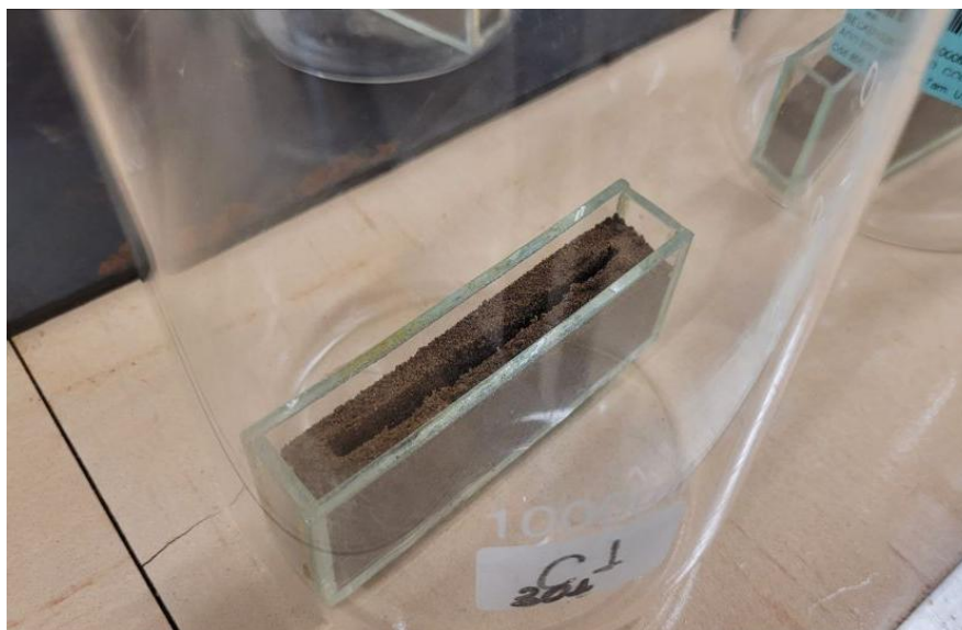
Figura 13 - Cuba de vidro com solo para simulação de um sulco de plantio para condução dos testes com os inoculantes simulando sua aplicação direta no solo
