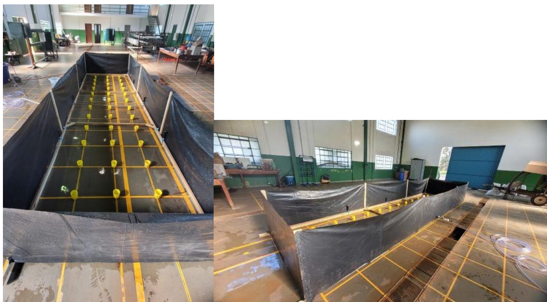
Figura 2 - Estrutura para aplicação dos tratamentos via irrigação por aspersão e ensaio de uniformidade do sistema
