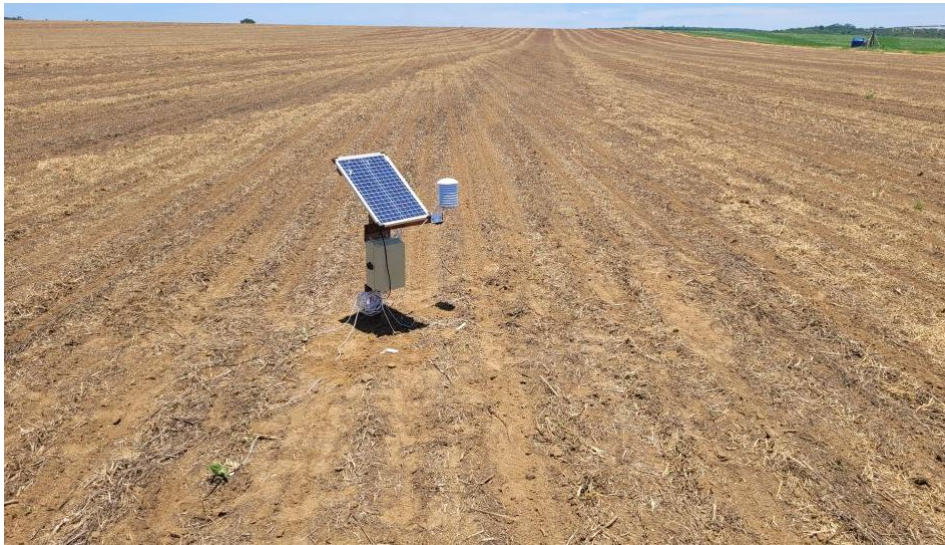
Figura 8 - Instalação dos sensores de temperatura do solo, do ar e da umidade relativa, imediatamente após o plantio para monitoramento contínuo
