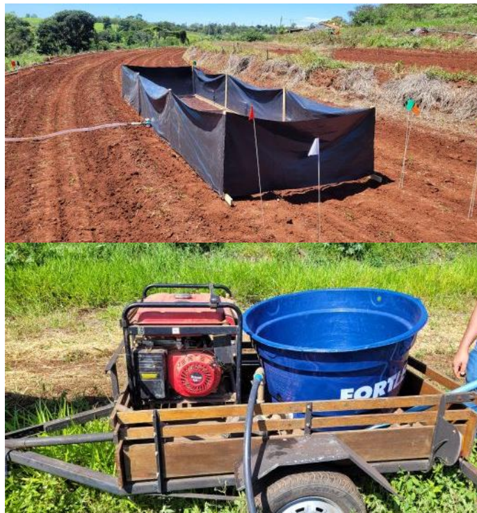
Figura 3 - Estrutura para aplicação dos tratamentos via irrigação por aspersão e sistema móvel para injeção da calda, composto por uma bomba d'água, gerador e caixa d'água
