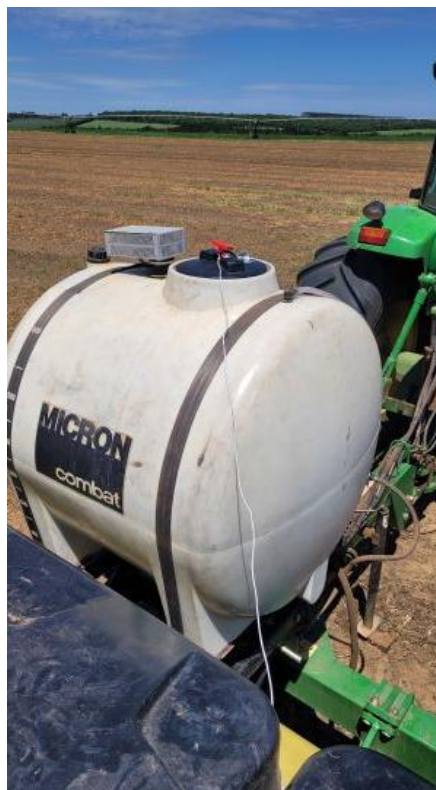
Figura 4 - Vista do tanque de injeção de inoculantes da semeadora com sensor de temperatura (cabo branco) instalado em seu interior para monitoramento da temperatura da calda
