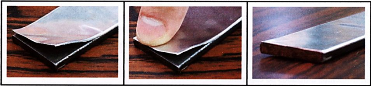
Figure 6.1 - Colagem do adesivo na viga, caso 1
