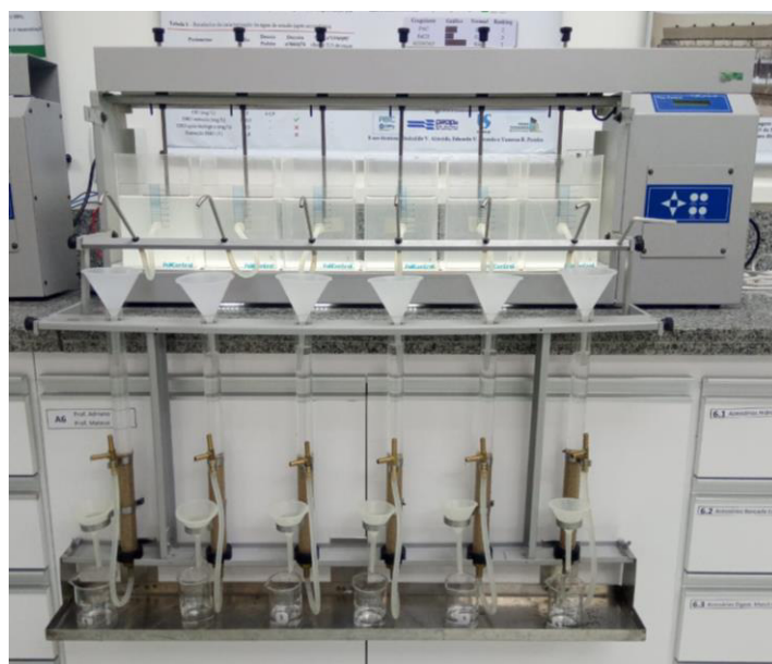
Figura 19: Jar test de 6 jarros com filtro de areia acoplado da marca PoliControl modelo FlocControl III utilizado nos ensaios deste trabalho.
