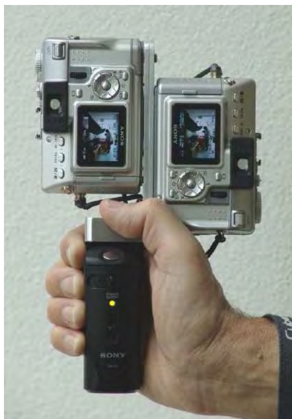
Ilustração 71: Duas câmeras fotográficas digitais da Sony montadas lado a lado num trilho adaptador, de forma a realizar fotos estereoscópicas, podendo fixá-las num tripé – as duas câmeras ficam com seu lado esquerdo voltado para baixo (left side down). Fonte: Imagens de Gert Jan Wolkers and Co van Ekeren, encontradas no Help do software StereoMovie Maker, versão 0,93.
