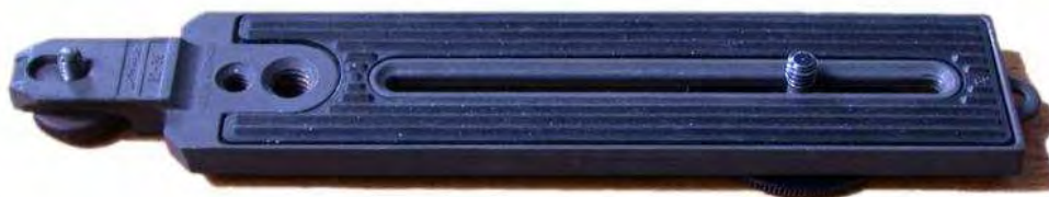
Ilustração 75: Adaptador de tripé com a função de auxiliar na obtenção de fotos estereoscópicas com apenas uma câmera. Nele, é possível realizar a primeira imagem e deslizar a câmera no trilho para realizar a outra foto, mantendo as duas imagens paralelas. Fonte: http://www.stanford.edu/dept/SUSE/projects/ireport/articles/3D/3D%20VR%20types.pdf
