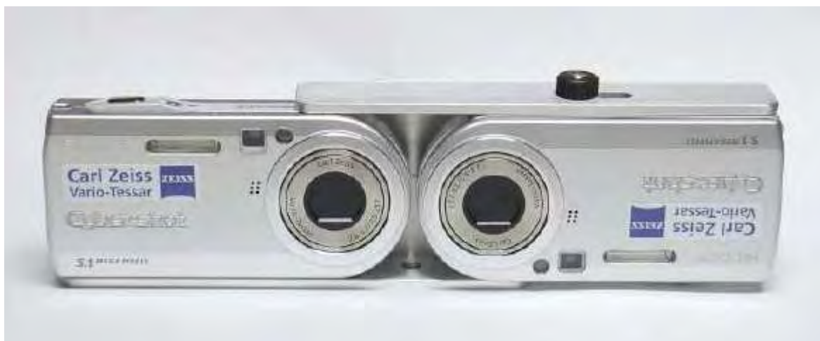
Ilustração 70: Duas câmeras fotográficas digitais da Sony montadas lado a lado num trilho adaptador, de forma a realizar fotos estereoscópicas, podendo fixá-las num tripé – a câmera esquerda fica de ponta-cabeça. Fonte: Imagens de Gert Jan Wolkers and Co van Ekeren, encontradas no Help do software StereoMovie Maker, versão 0,93.
