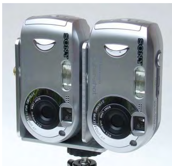
Ilustração 71: Duas câmeras fotográficas digitais da Sony montadas lado a lado num trilho adaptador, de forma a realizar fotos estereoscópicas, podendo fixá-las num tripé – as duas câmeras ficam com seu lado esquerdo voltado para baixo (left side down). Fonte: Imagens de Gert Jan Wolkers and Co van Ekeren, encontradas no Help do software StereoMovie Maker, versão 0,93.
