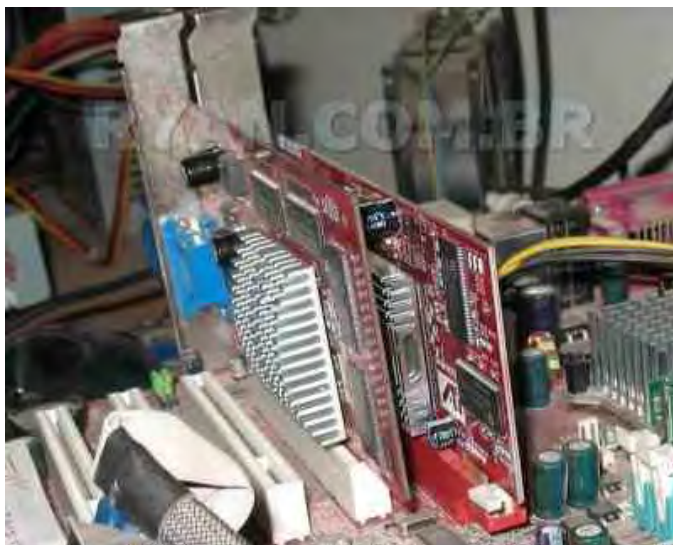
Ilustração 162: Duas placas de vídeo não-dual, conectadas em um computador. Fonte: http://jefferson-ryan.blogspot.com/2007/04/multi-monitores-e-o-problema-da-minha.html
