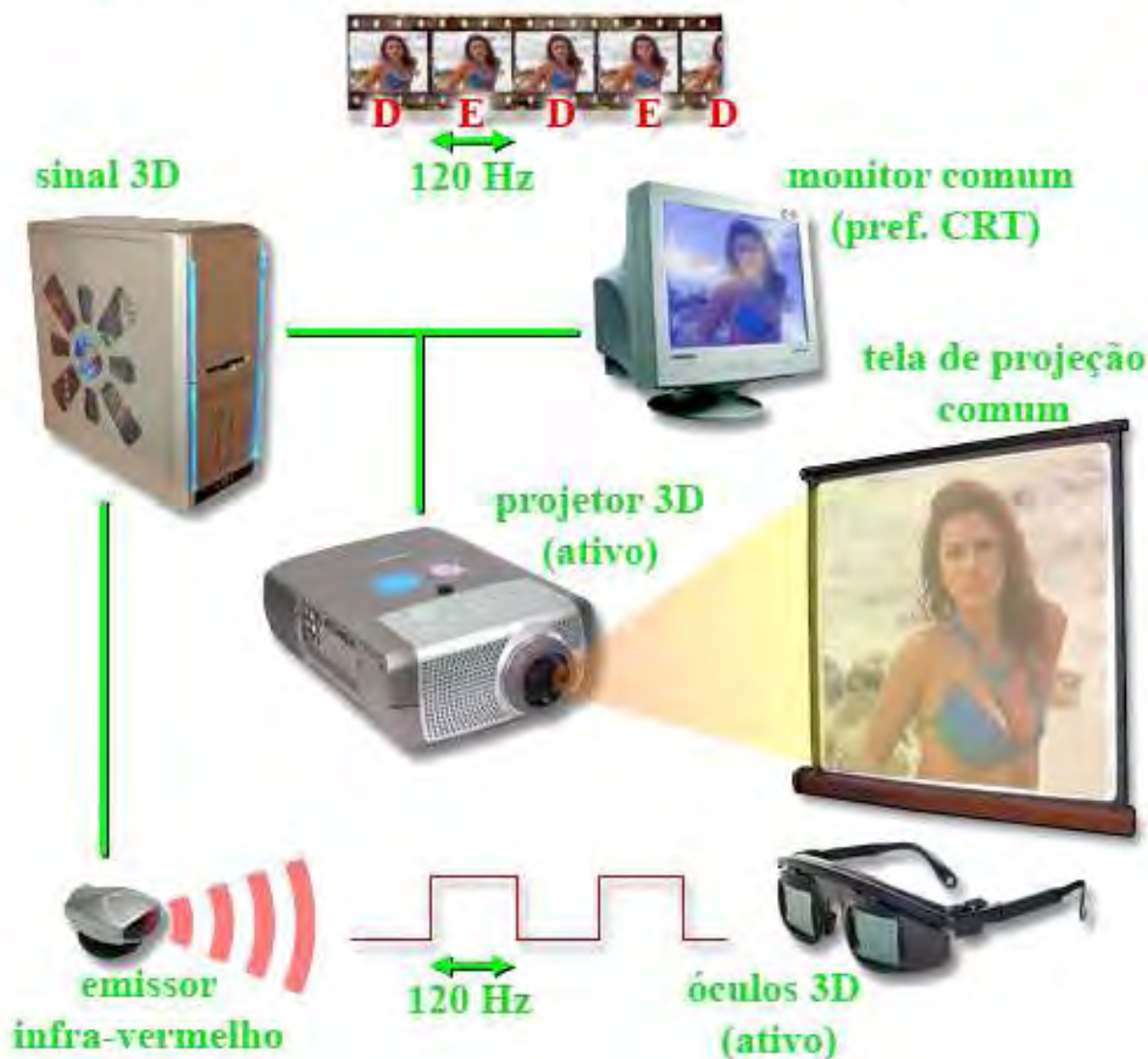
Ilustração 104: Formas de visualização estereoscópica ativa. Imagem modificada. Fonte: http://www.gali-3d.com/en/techno-passive-stereo/techno-passive-stereo.php
