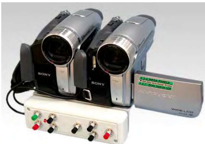
Ilustração 79: Câmeras de vídeo e foto controladas por um sincronizador LANC. Fonte: http://www.3d-shop.ro/?p=productsMore&iProduct=74
