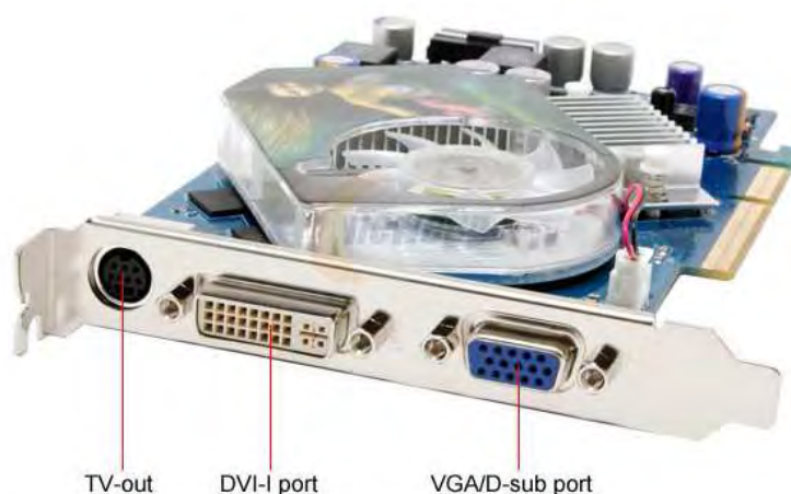
Ilustração 159: Placa de vídeo dual com uma saída DVI, uma saída VGA e uma de TV. Fonte: http://www.forumdohardware.com.br/viewtopic.php?t=169358
