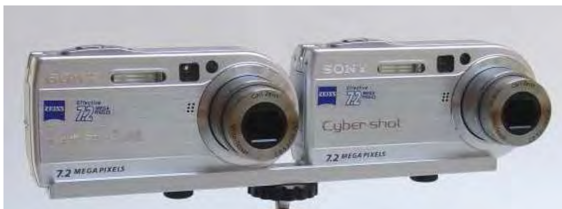
Ilustração 69: Duas câmeras fotográficas digitais da Sony montadas lado a lado num trilho adaptador, de forma a realizar fotos estereoscópicas, podendo fixá-las num tripé. Fonte: Imagens de Gert Jan Wolkers and Co van Ekeren, encontradas no Help do software StereoMovie Maker, versão 0,93.
