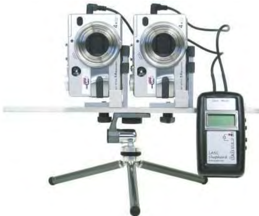
Ilustração 80: Par de câmeras digitais em um tripé adaptado, utilizando a central de controle Sheperd. Fonte: http://www.stanford.edu/dept/SUSE/projects/ireport/articles/3D/3D%20VR%20types.pdf
