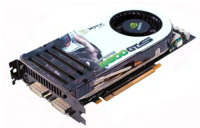
Ilustração 160: Placa de vídeo dual com duas saídas DVI, e saída de TV (HDTV, S-Video, Composite). Fonte: http://produto.mercadolivre.com.br/MLB-65324672-placa-de-video-xfx-geforce-8800-gts-640mb-320bits-dx10-1ano-_JM
