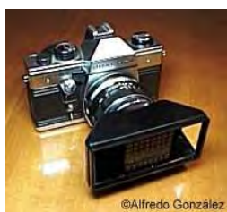
Ilustração 52: Lente adaptadora para câmera fotográfica normal, para poder realizar fotos estereoscópicas. Fonte: http://www.users.red3i.es/~stereoweb/fotograf.htm
