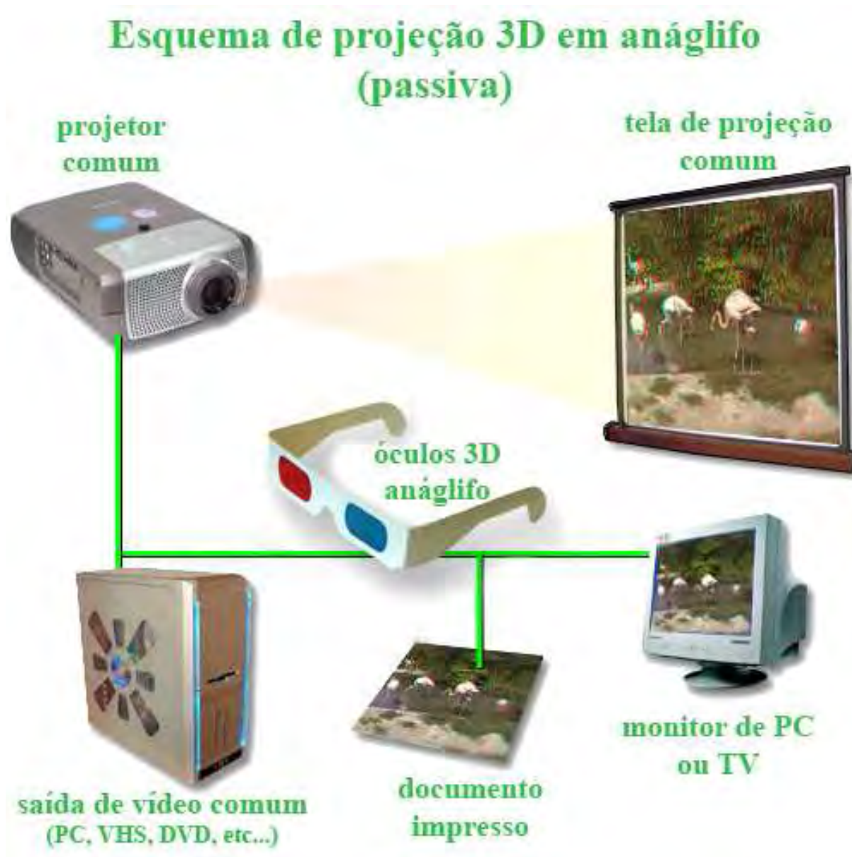
Ilustração 96: Sistema anáglifo e suas possibilidades. Imagem modificada. Fonte: http://www.gali-3d.com/en/techno-anaglyph/techno-anaglyph.php
