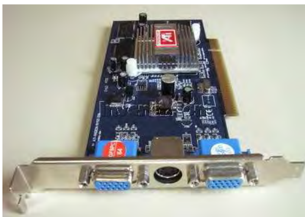
Ilustração 161: Placa de vídeo dual com duas saídas VGA, e saída de TV. Fonte: http://invenci.com/home/images/invenci/produtos/hardwares/placasdevideo/pcidualati/dualvideoati1.jpg
