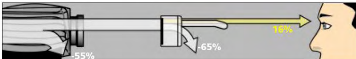
Ilustração 150: Projeção Ativa (apenas um projetor CRT ou DLP™). Fonte: http://www.barco.com/virtualreality/en/downloads/brochures.asp
