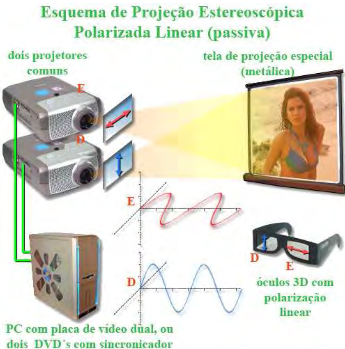
Ilustração 100: Sistema de projeção de vídeo estereoscópico utilizando-se a polarização da luz de forma linear. Imagem modificada. Fonte: http://www.gali-3d.com/en/techno-passive-stereo/techno-passive-stereo.php
