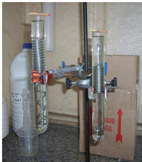
Figura 25 – Processo de embutimento das molas em resina
