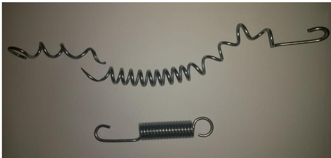
Figura 42 – Configuração deformada da mola após segundo ensaio de tração até a ruptura
