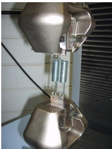
Figura 23 – Associação de duas molas em paralelo sob tração
