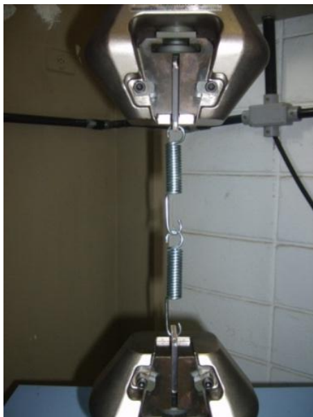
Figura 22 – Associação de duas molas em série sob tração
