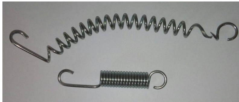
Figura 40 – Configuração deformada da mola após primeiro ensaio de tração até a ruptura
