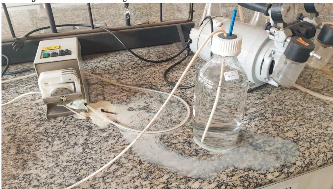
Figura 14. Vazamento da mangueira do efluente do biorreator durante o 32º dia de ensaio.
