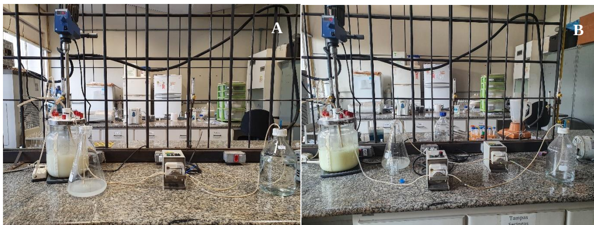
Figura 13. Imagem do sistema contínuo no início da operação (A) e imagem após realizar a troca da mangueira e igualar as vazões (B).
