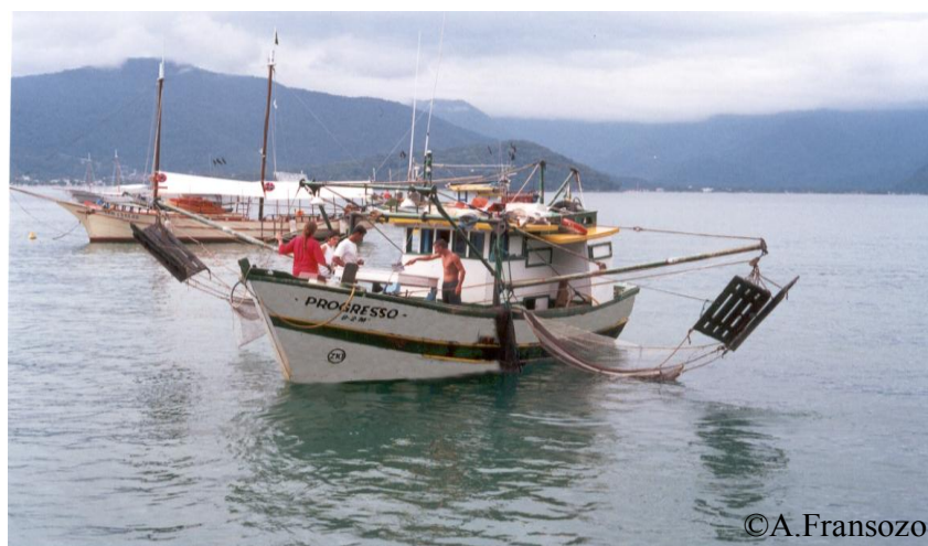
Figura 3. Barco camaroneiro equipado com redes de arrasto do tipo double-rig utilizado durante as coletas.
