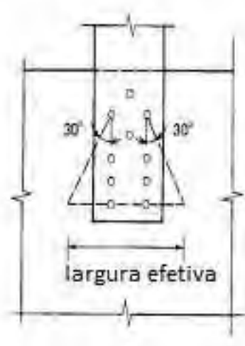
Figura 33 – Dispersão das tensões normais para obtenção da seção efetiva (“Whitmore Section”)
