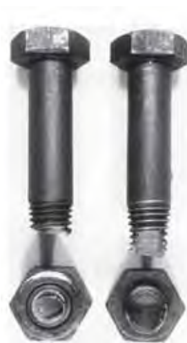
Figura 20 – Comparação entre rupturas de parafusos ocasionadas por torque excessivo e por tração direta
