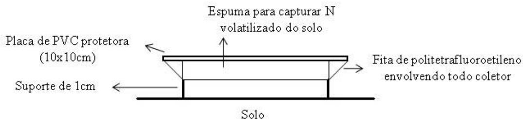
Figura 2. Esquema do absorvedor de espuma com ácido e politetrafluoroetileno (AE).
