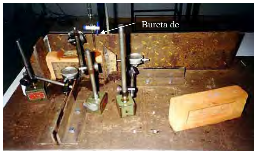
Figura 33- Confinamento do corpo de prova na bancada de testes.
