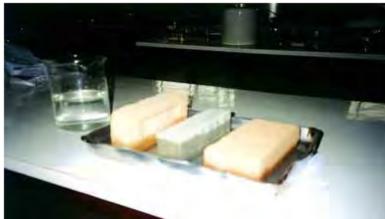
Figura 37- Visão da frente de percolação dos corpos de prova para estudo da velocidade de umidificação.
