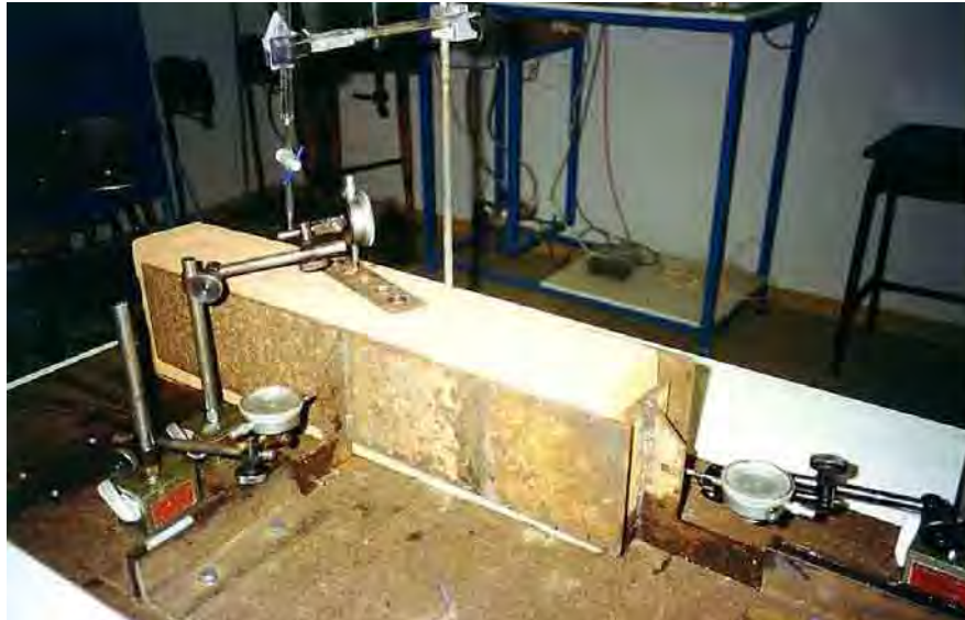
Figura 35 – Confinamento do Corpo de Prova PAREDE na bancada
