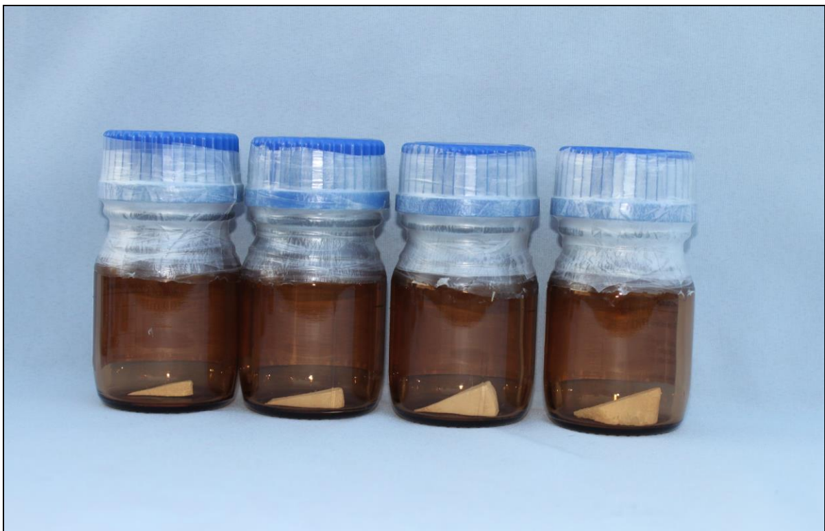
Figura 2: Implantes ósseos caninos córtico-esponjosos submetidos ao processo de liofilização e esterilização por meio de irradiação gama. Notar formato de cunha com larguras variadas, da esquerda para a direita: 3, 6, 9, e 12 mm. Observar ainda a ambarização dos frascos, antes translúcidos, ocasionada pela irradiação gama.: Arquivo pessoal (2014).
