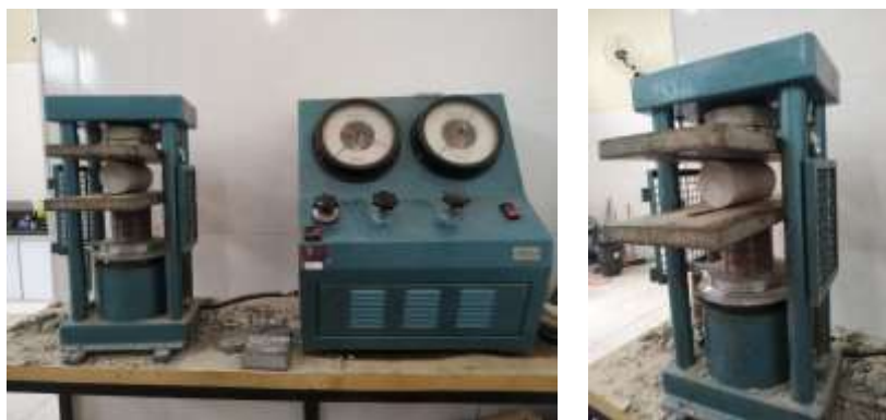
Figura 6 – Execução do ensaio de resistência à tração por compressão diametral.
