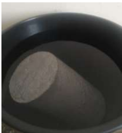
Figura 9 – Execução do ensaio lixiviação, CP inteiro
