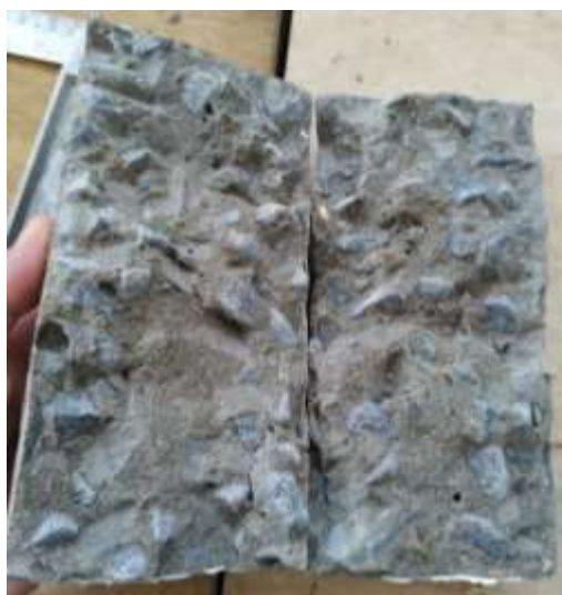
Figura 10 – Execução do ensaio lixiviação, CP rompido
