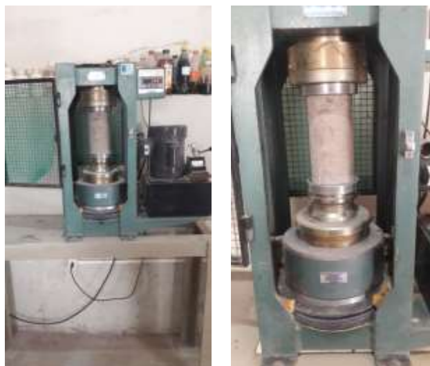
Figura 5 - Execução do ensaio de resistência à compressão
