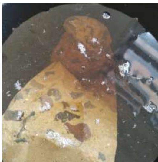
Figura 10 – Execução do ensaio lixiviação, CP rompido
