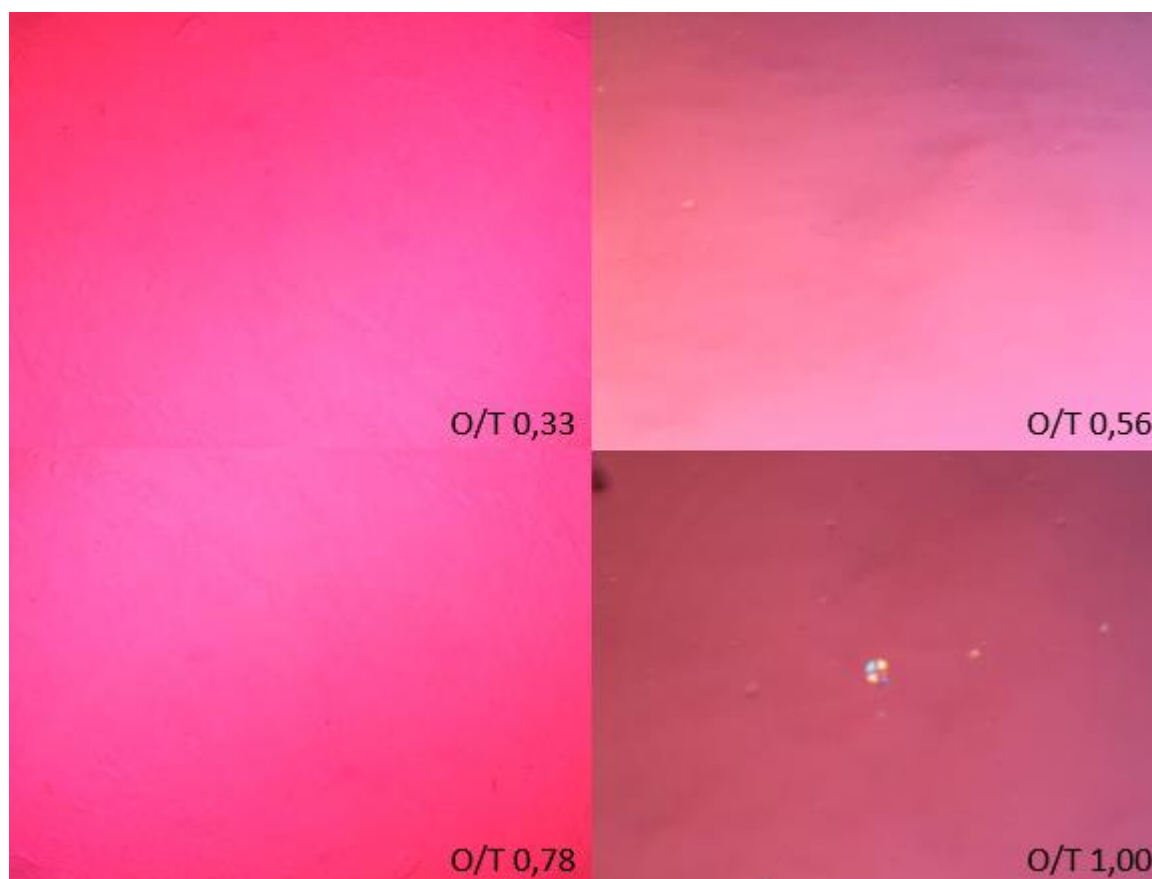
Figura 33: Fotomicrografias dos sistemas preparados com proporções crescentes da razão O/T. Aumento de 40x.
