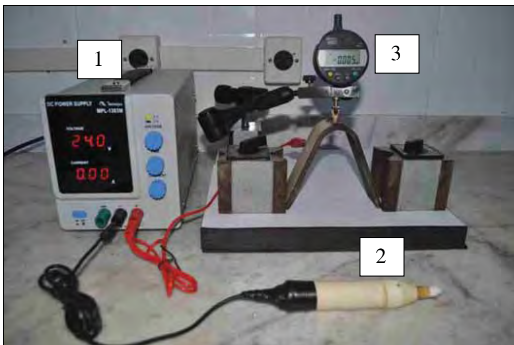
Figura 16: Equipamento utilizado para polimento eletrolítico: (1) fonte de tensão e corrente; (2) pincel com eletrólito; (3) – relógio comparador digital (FONTE: LAT/UFF) Laboratório de Análise de Tensões - LAT - UFF.
