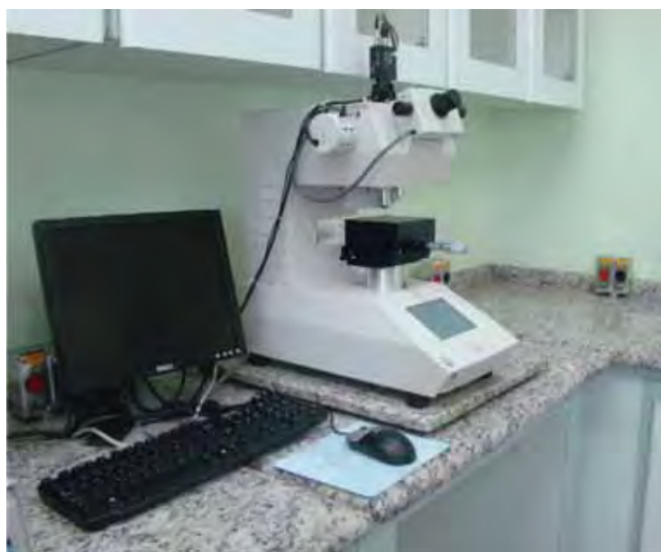
Figura 17: Equipamento utilizado para a o ensaio de microindentação – Laboratório de fadiga – FEG/UNESP.
