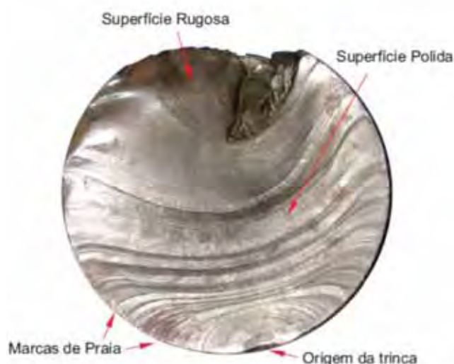
Figura 12: Aspecto macroscópico de uma superfície de fratura por fadiga (SOUZA, 1982).
