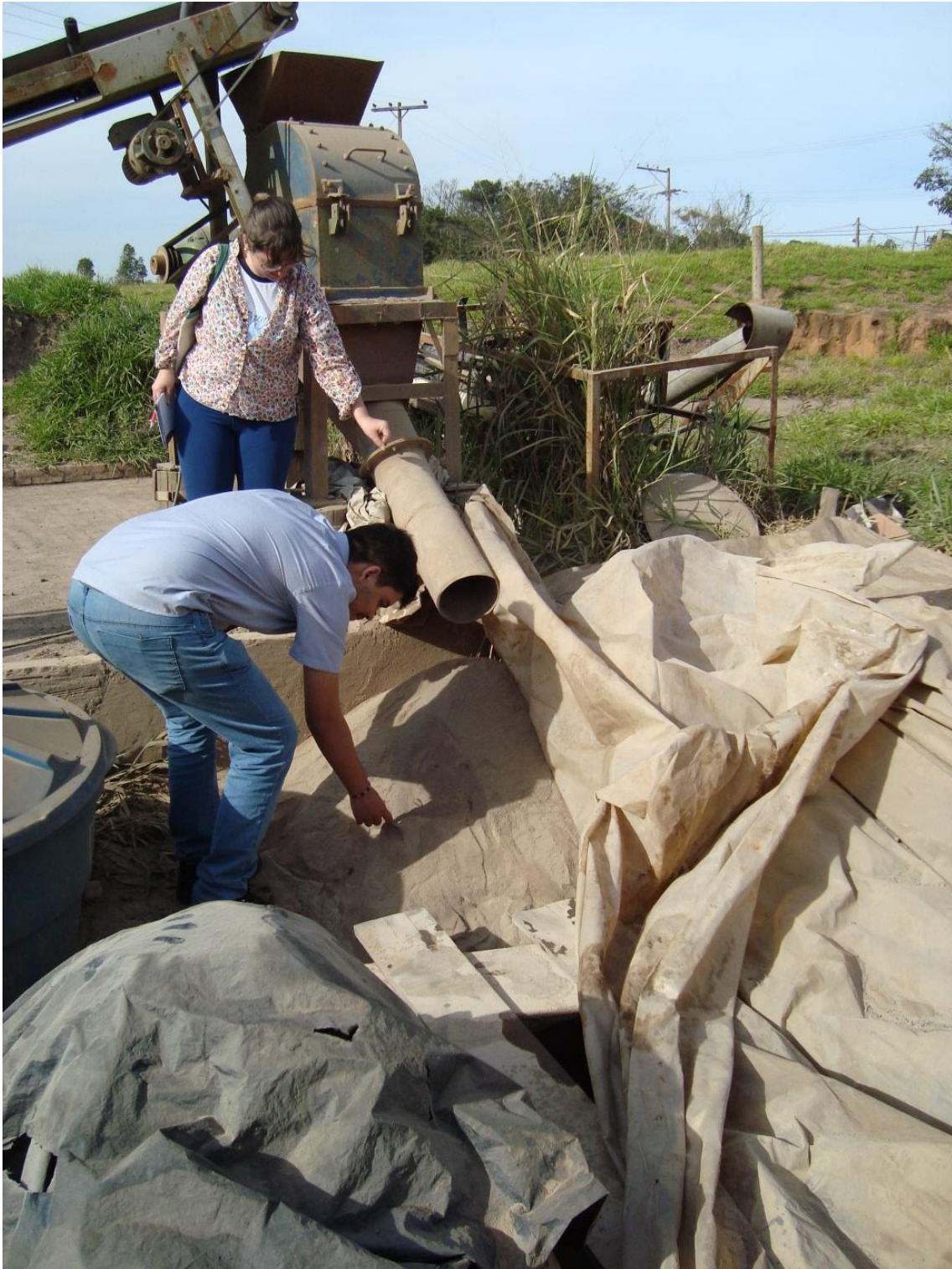
Figura 11: Torrões de argila já triturados, o procedimento a seguir é a hidratação do material.
