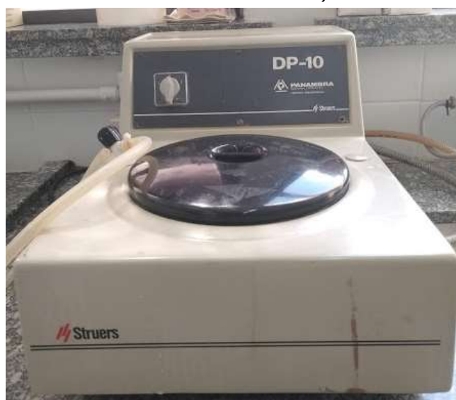
Figura 12 – Equipamento utilizado para lixar os espécimes (Politriz - Panambrá DP-10)
