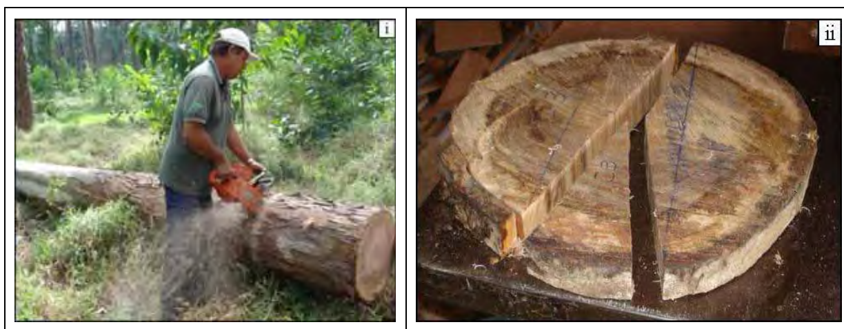
Figura 9 – Etapas da produção do material para as análises. (i): corte da tora de 70 cm a partir do DAP em direção à base. (ii): retirada da cunha utilizada na determinação da densidade básica média da cunha.
