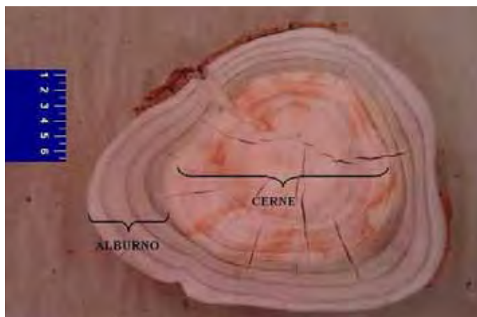
Figura 3 – Corte de tronco de Eucalyptus , evidenciando o cerne e o alburno.
