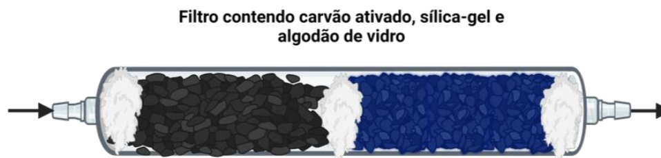
Figura 13 – Filtro para purificação de ar, contendo carvão ativado, sílica-gel e algodão de vidro.
