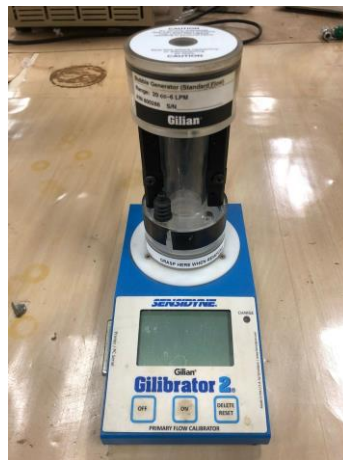
Figura 10 – Gerador de bolha Gilian Gilibrator 2 Calibration System Standard Kits – Sensidyne – utilizado como medidor de vazão padronizado.
