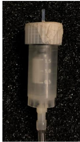
Figura 41 – Amostrador \mu -impinger montado. Descrição de montagem no texto.
