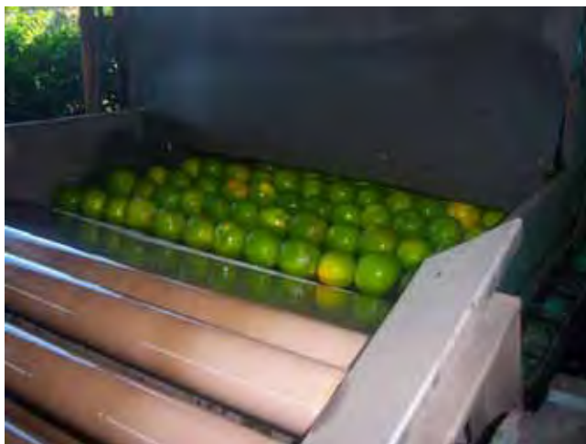
Figura 25 – Vista parcial da lavagem das frutas com solução de água e cloro.
