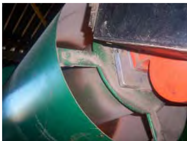
Figura 29 – Vista parcial do túnel para aplicação da cera em torno de 60°C.
