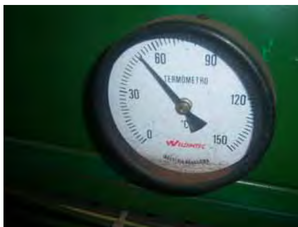
Figura 28 – Vista do termômetro com indicação da temperatura de aplicação da cera.
