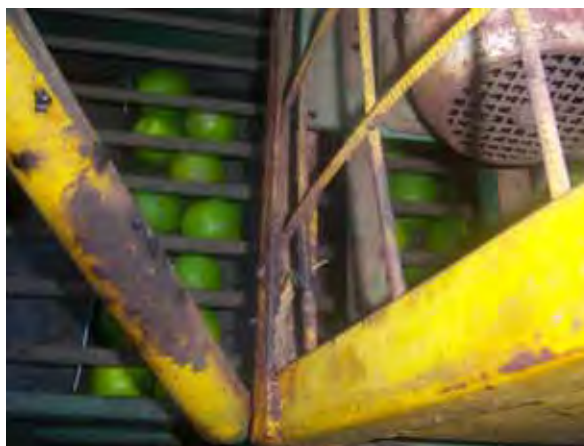
Figura 31 – Vista parcial do mecanismo de classificação dos frutos, em função de seu tamanho.
