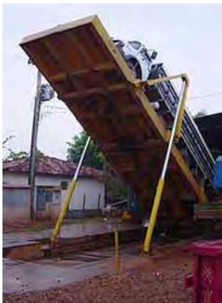
Figura 22 - Descarregamento de laranjas do caminhão em plataforma, em tanque de água. (Fonte: FEAGRI, 2011)
