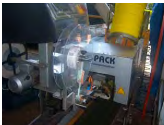
Figura 32 – Vista parcial da máquina para embalar e etiquetar as frutas em saco de rede de 3, 5 e 20 kg.
