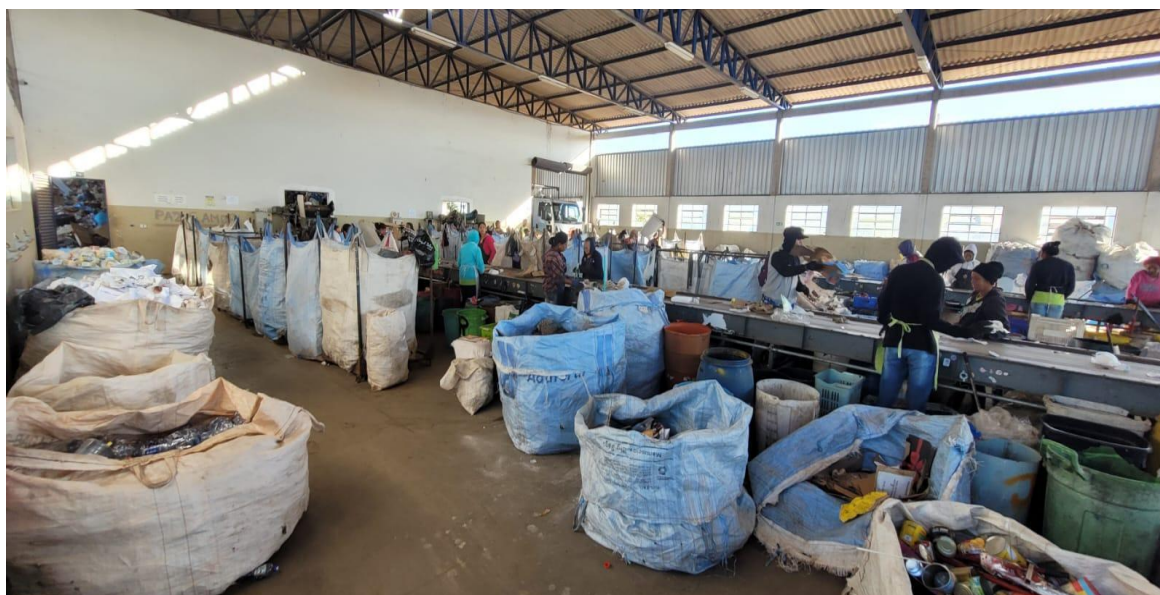
Figura 6 - Esteira de separação dos resíduos localizada dentro do galpão da cooperativa.
