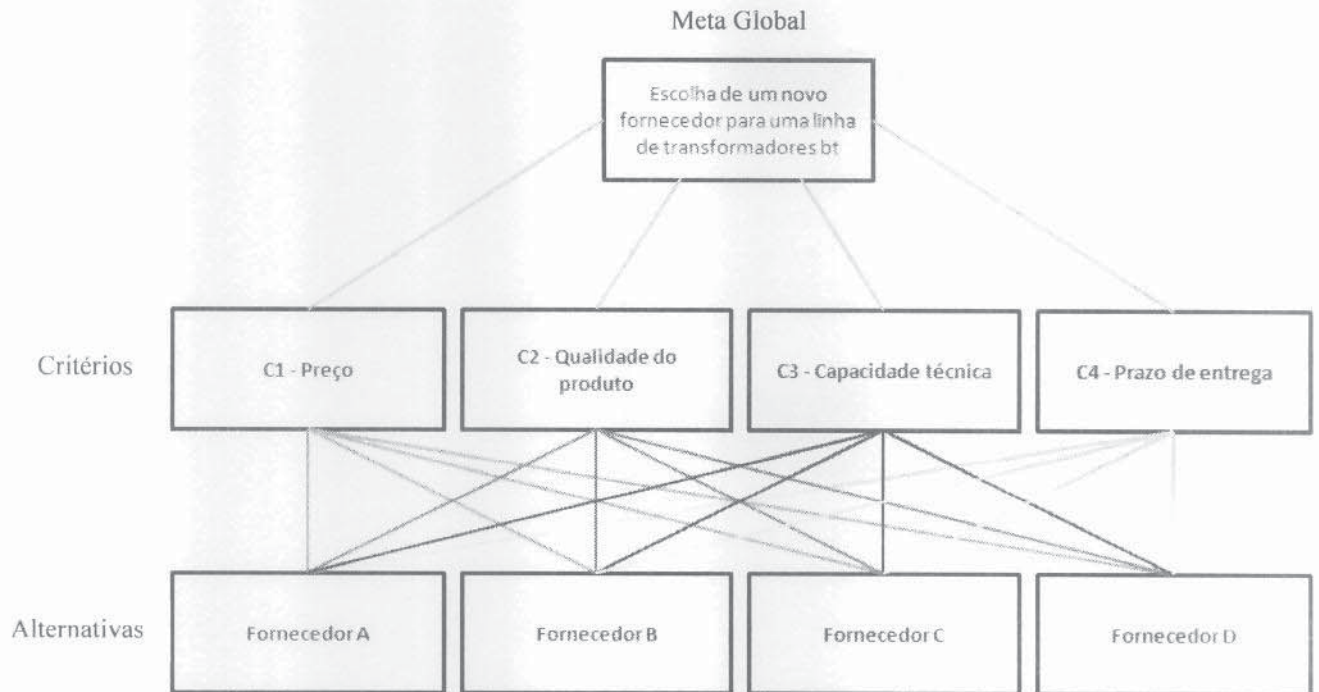
Figura 4 – Estrutura de decisão hierárquica
