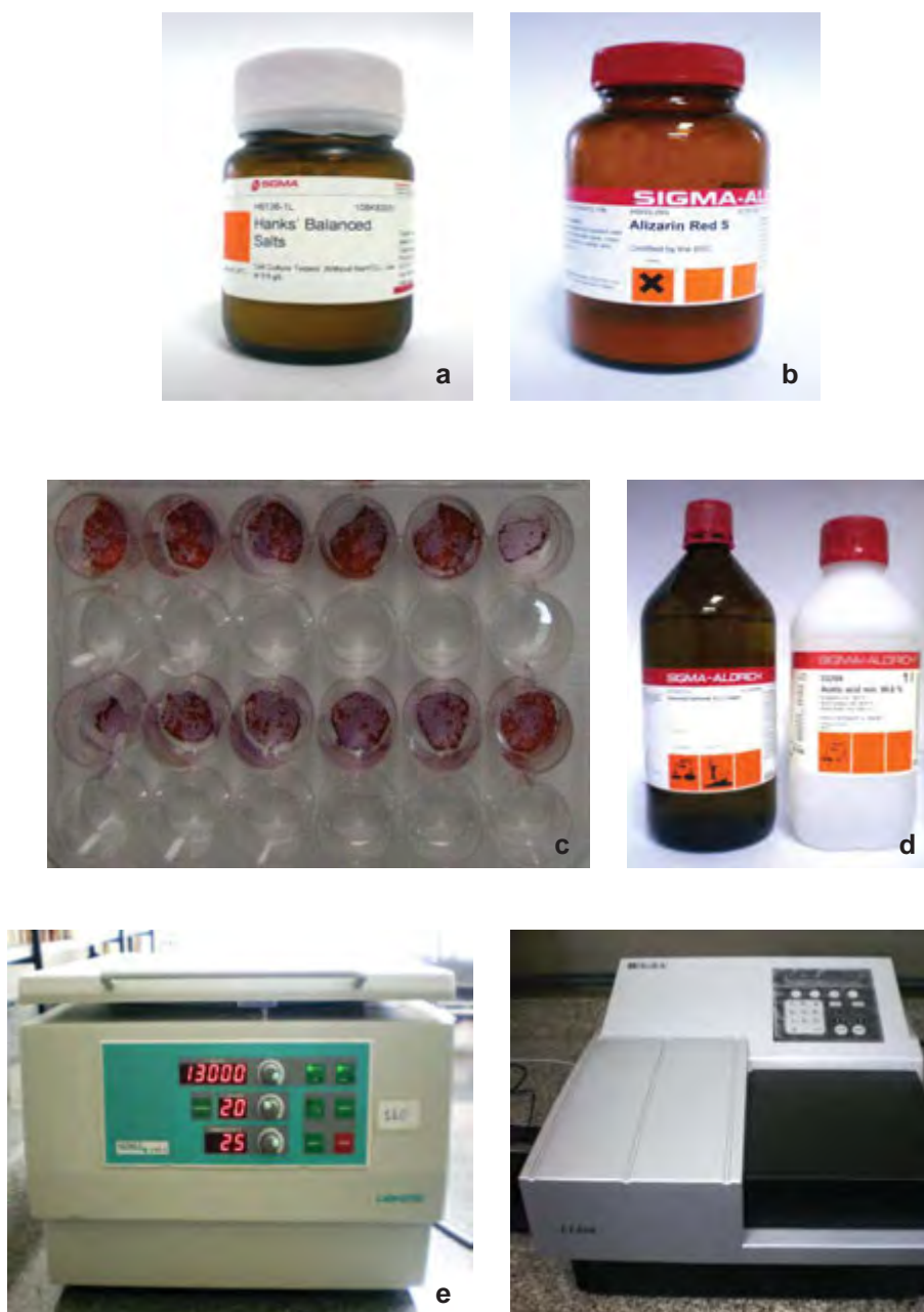
Figura 9 – Quantificação de formações nodulares e matriz mineralizada. a) sal de Hank's; b) corante vermelho Alizarina S; c) formações nodulares coradas com vermelho Alizarina S; d) os reagentes hidróxido de amônia e ácido acético; e) centrífuga (Centrífuga Labnet - HERMLE Z 300 K); f) espectrofotômetro (Biotek – EL808IU).
