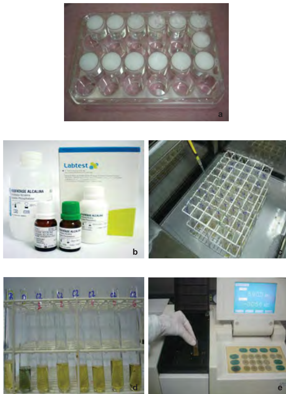
Figura 8 – Fosfatase alcalina. a) lisados celulares; b) kit comercial Labtest; c) tubos de ensaio com reagentes recebendo alíquotas das amostras; d) tubos de ensaio contendo os reagentes e as alíquotas das amostras; e) espectrofotômetro (Shimadzu Europa GmbH UV 1203).
