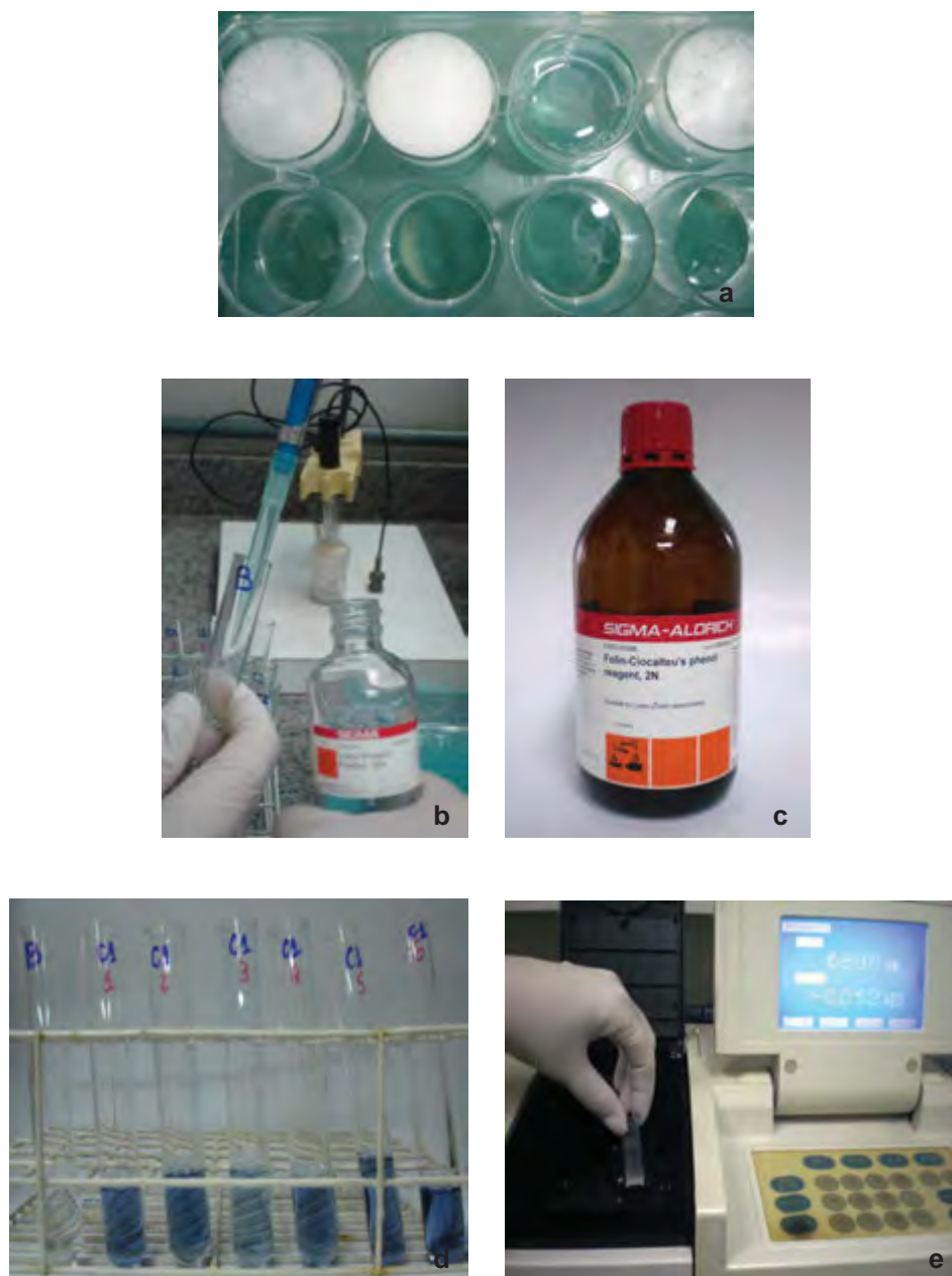
Figura 7 – Proteína total. a) poços preenchidos com lauril sulfato de sódio; b) tubos de ensaio recebendo reagente de Lowry; c) reagente de Folin e Ciocalteu; d) tubos de ensaio contendo os reagentes e as alíquotas das amostras; e) espectrofotômetro (Shimadzu Europa GmbH UV 1203).
