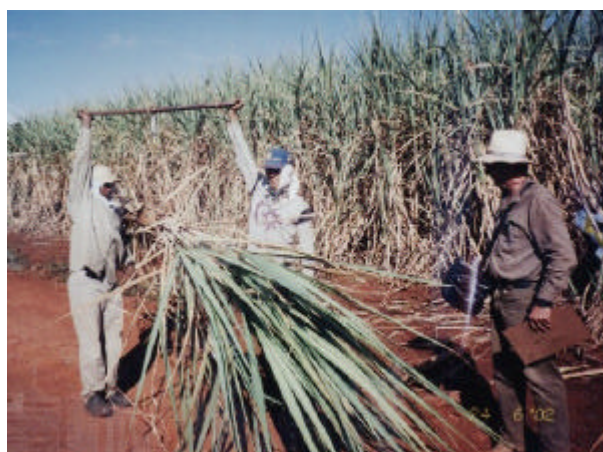
Figura 11. Pesagem de biomassa da parte aérea, com o uso de célula de carga.
