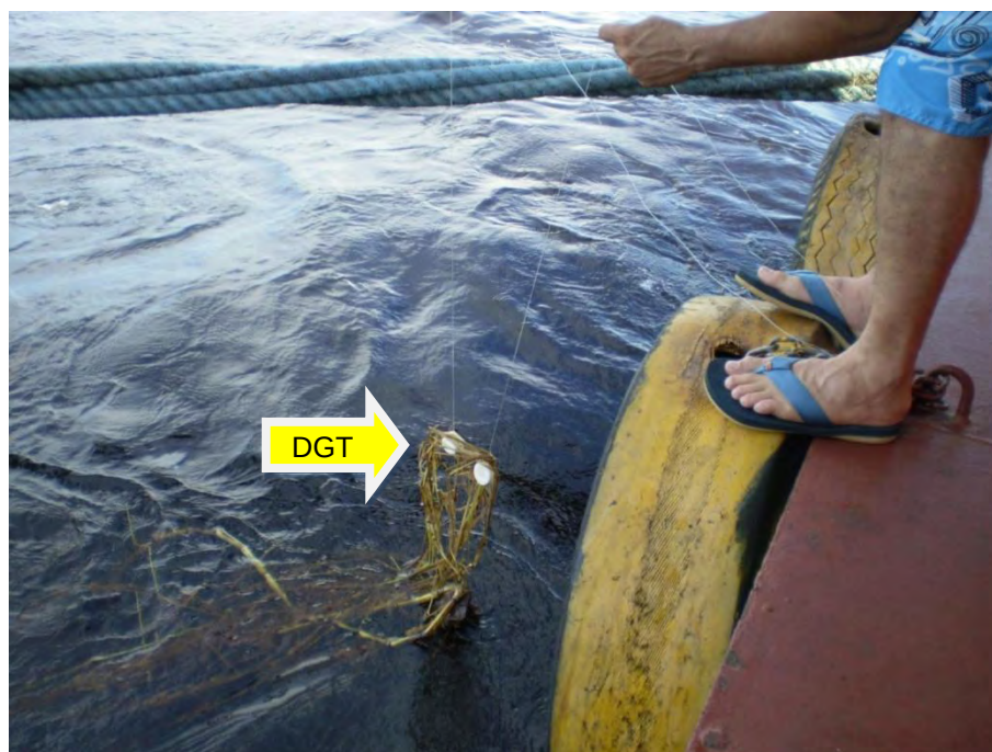
Figura 13 - Sistema de imersão in situ dos dispositivos DGT em rios da bacia Amazônica. Esta foto refere-se ao ponto de amostragem no rio Negro (ponto flutuante de abastecimento de barcos – Manaus).
