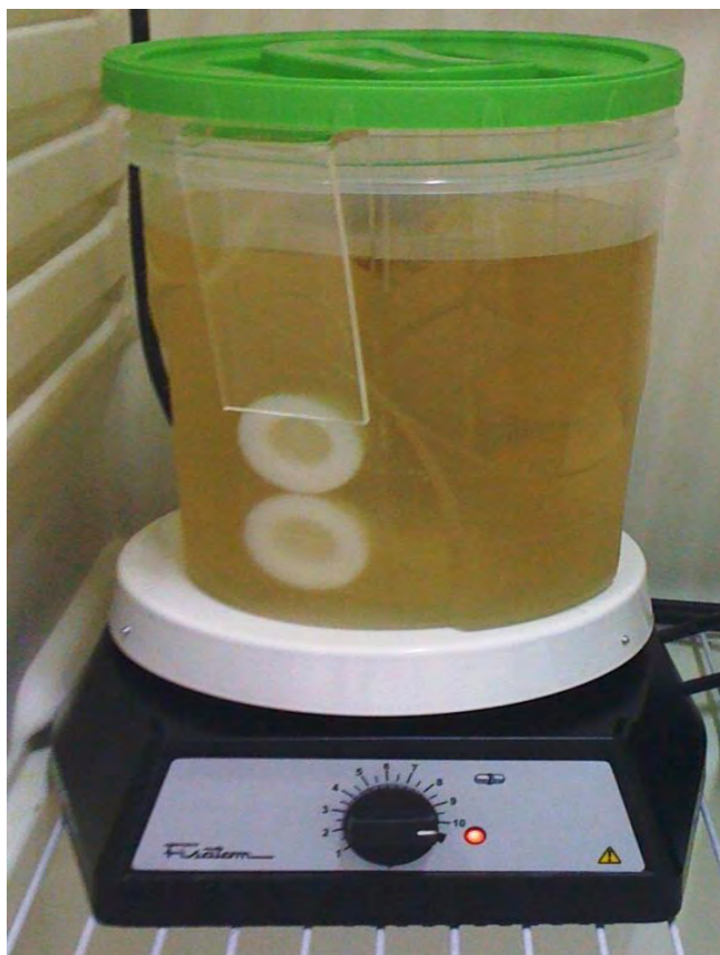
Figura 11 – Imersão em laboratório com amostra de água do rio Amazonas.
