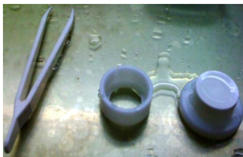
Figura 9 – Pistão com a resina ligante, gel difusivo e membrana de acetato de celulose e presilha ao lado.
