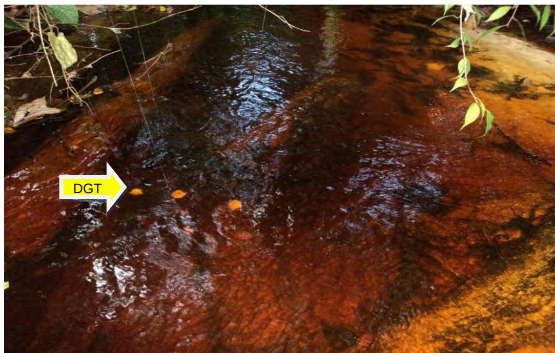
Figura 12 - Sistema de imersão in situ dos dispositivos DGT em rios da bacia Amazônica. Esta foto refere-se ao ponto de amostragem no alto rio Negro (5°BIS – São Gabriel da Cachoeira).
