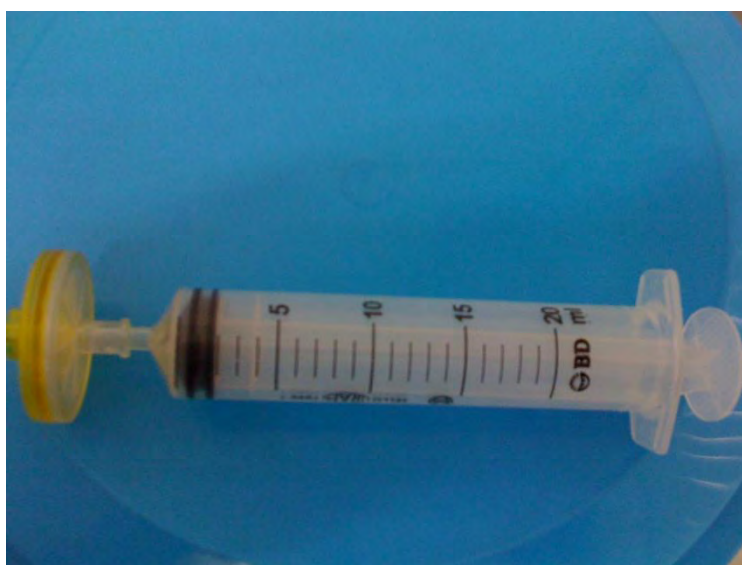
Figura 14 - Sistema de filtragem com filtro seringa, para a determinação de metais dissolvidos.
