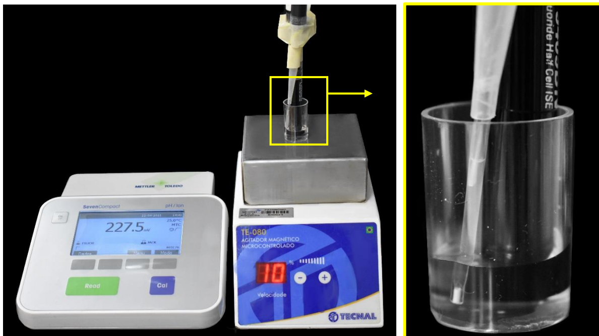
Análise de fluoreto no esmalte com eletrodo específico 9409BN e microeletrodo de referência acoplados a um analisador de íons.
