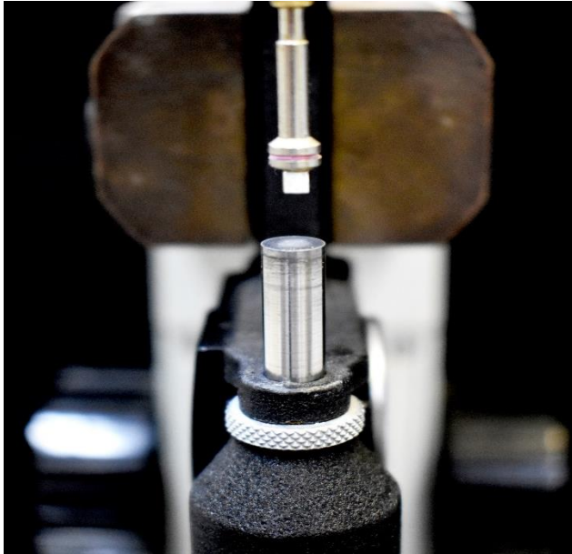
Bloco de esmalte seccionado no sentido longitudinal e fixado com cola adesiva em mandril para peça reta para realização da microabrasão do esmalte.
