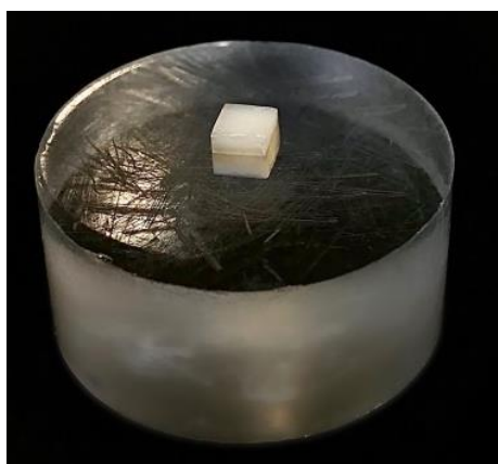
Bloco de esmalte fixado com cera pegajosa em disco de resina acrílica após o polimento.
