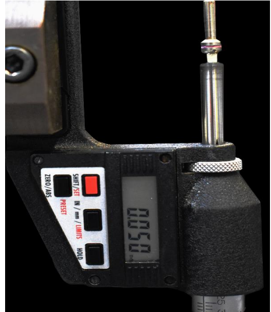
Mensuração com micrômetro eletrônico digital após a microabrasão do esmalte (50 \mu\text{m} ).
