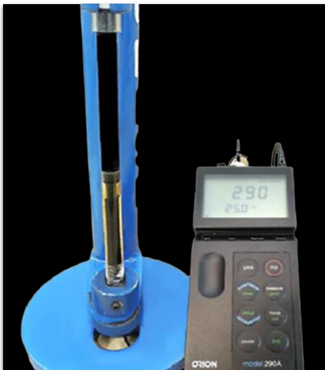
Análise de fluoreto no biofilme com eletrodo específico, potenciômetro e um analisador de íons.
