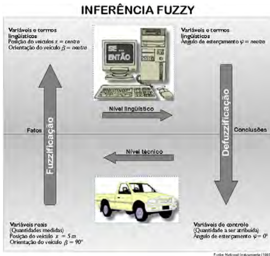
Figura 9: Estrutura completa de um controlador Fuzzy
