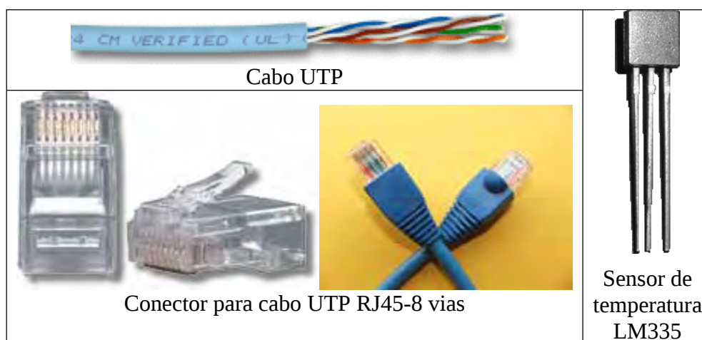
Figura 26: Componentes do cabo termométrico para monitoramento das condições de temperatura do silo
