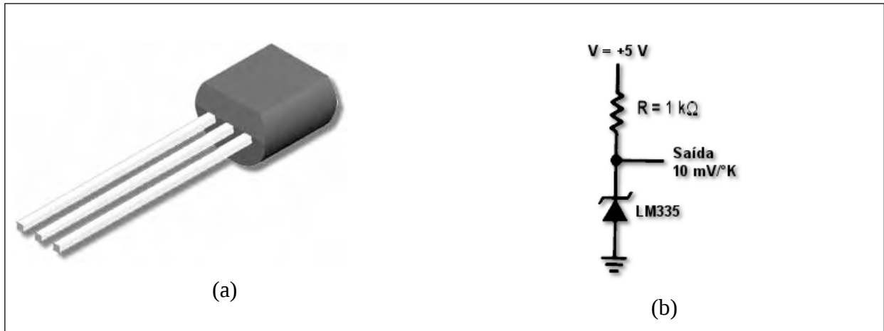
Figura 16: Sensor de temperatura LM335 (a) e configuração típica de instalação (b)
