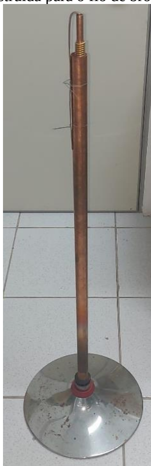
Figura 48 – Estrutura construída para o fio de bronze em formato helicoidal.
