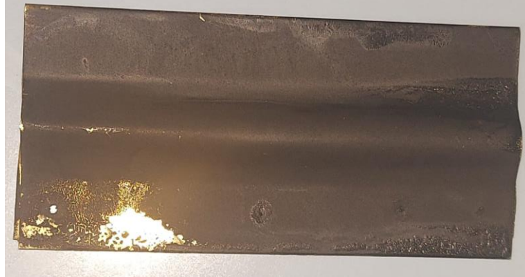
Figura 19 – Chapa de latão pintada de preto fosco para acoplar a haste do termômetro.
