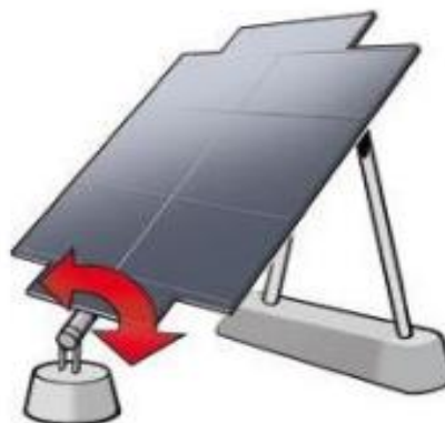
Figura 2 – Ilustração de um sistema de rastreador solar com um grau de liberdade.
