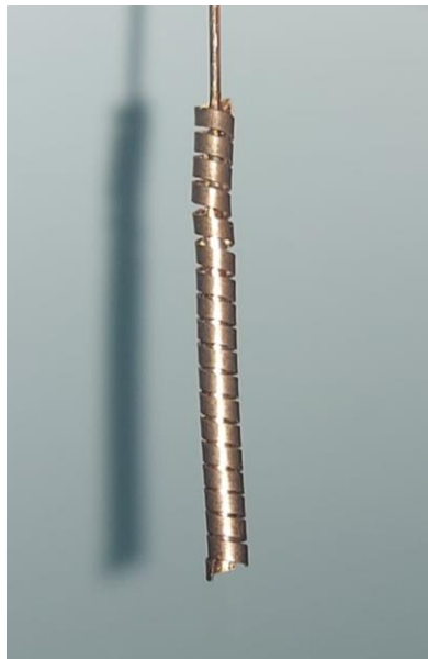
Figura 15 – Lâmina bimetálica helicoidal geralmente utilizada para termômetro.
