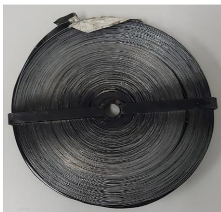
Figura 44 - Espiral construída com o material aço (liga com 98,5% de ferro + 0,5 % de carbono e sílico, enxofre e fosforo).
