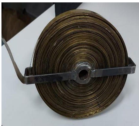
Figura 43 - Espiral construída com a fita de latão (liga com 60% de cobre + 40% de zinco)
