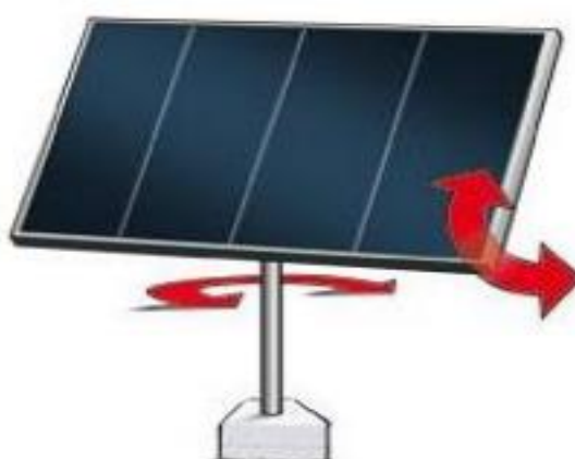
Figura 3 – Ilustração de um sistema de rastreador solar com dois graus de liberdade.
