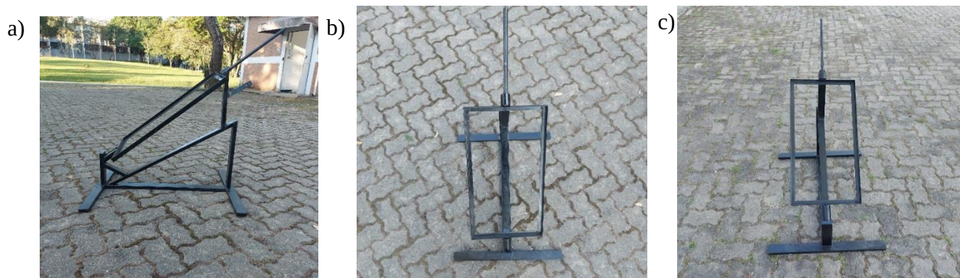
Figura 42 – Vistas da estrutura final de metalon que será utilizado para teste da espiral metálica.
