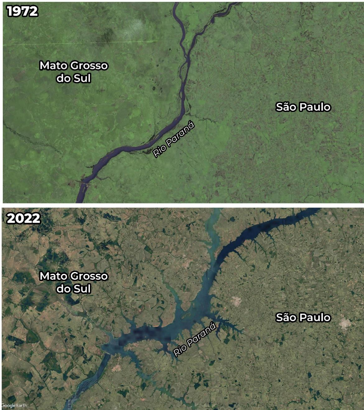
Figura 64: Comparativo da morfologia do rio Paraná, antes e após a intervenção da barragem de Ilha Solteira
